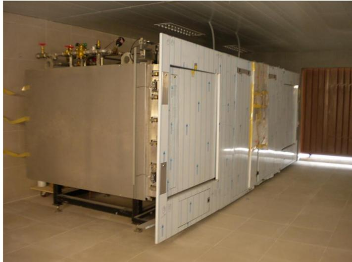
**Figura 18.** Autoclaves de esterilización para el tratamiento de residuos sólidos infecciosos a ser instalados en la planta de esterilización de EMAC EP.
