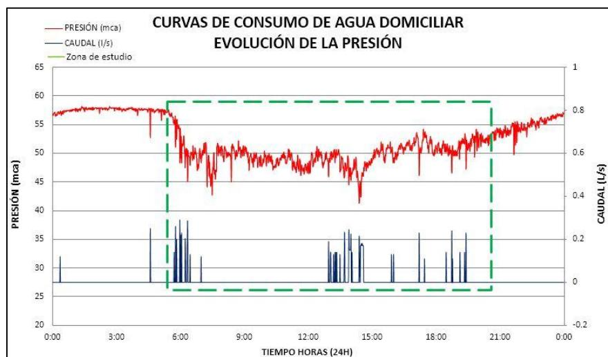
Figura 9.- Determinación de la curva de presión con relación directa al consumo interno - domiciliar.
