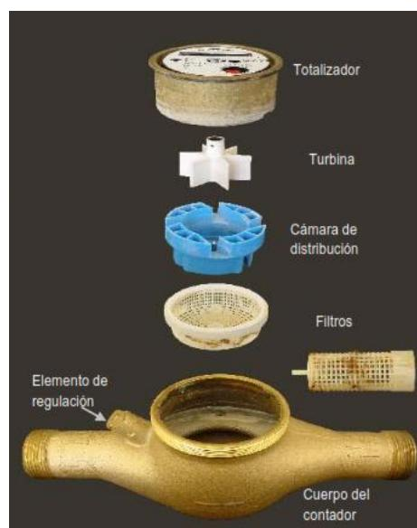
Figura 12.- Despiece de un contador de chorro múltiple.
