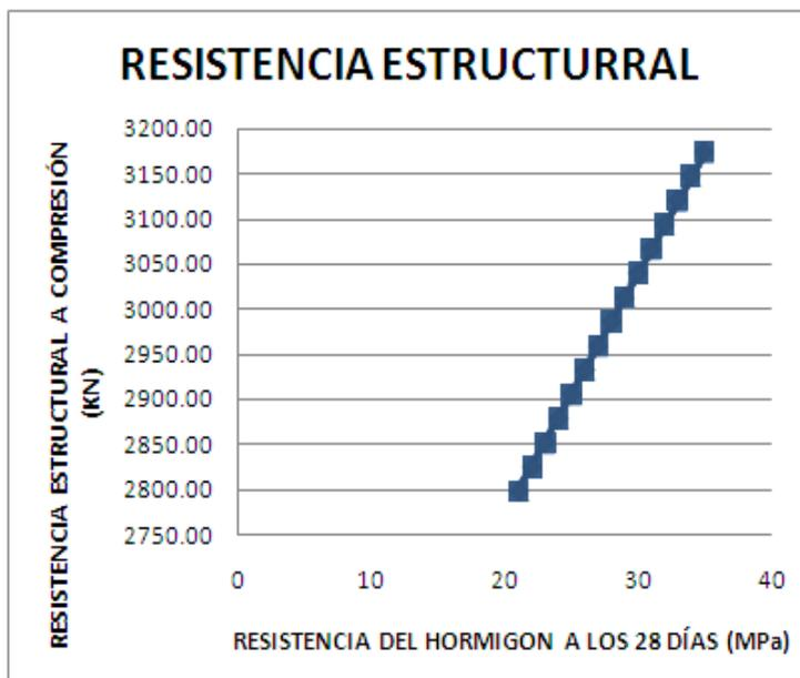
**Conclusión:** La gráfica muestra un incremento directamente proporcional de la resistencia característica del mortero a los *28 días* frente a la resistencia estructural a compresión del micropilote, esto se debe a que si se aumenta la resistencia del hormigón aumenta la resistencia del micropilote a compresión debido a que el hormigón es diseñado para que soporte cargas a compresión y lo que hace este material es resistir más esfuerzos axiales si se aumenta la resistencia.
