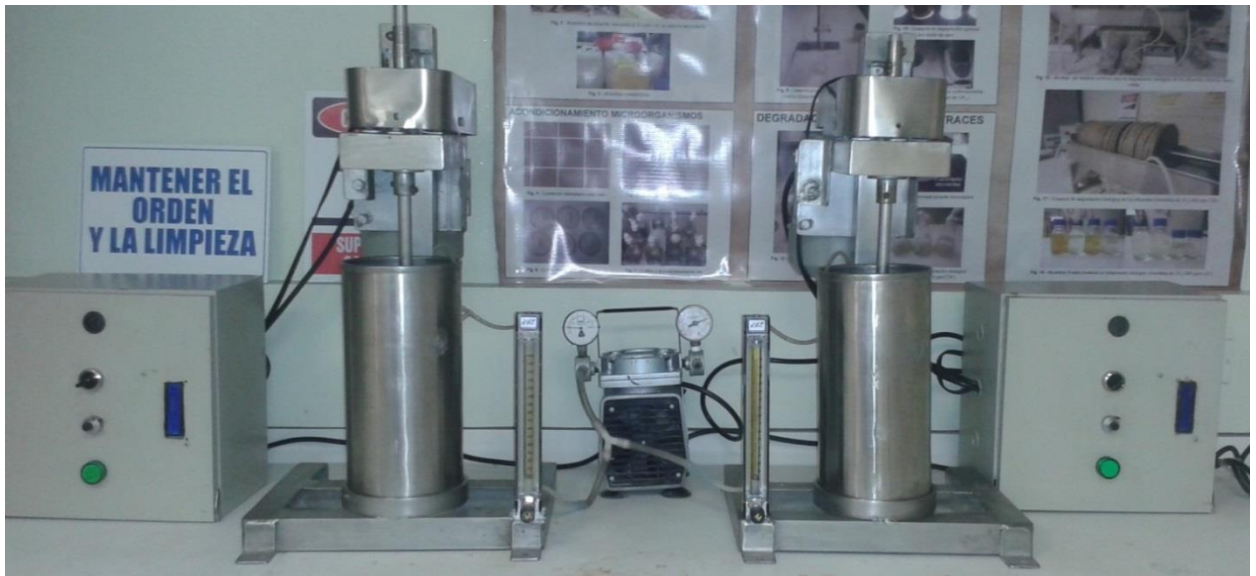
Figura. 11.8. Reactores utilizados en el proceso de biooxidación. Elaborado por: Gabriela González
