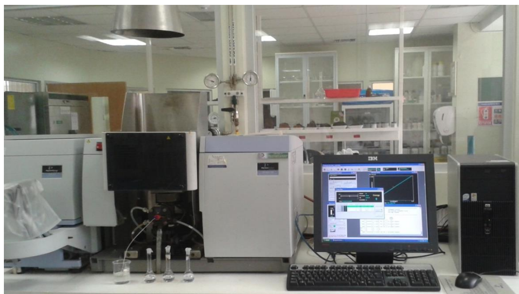
Figura. 11.12. Espectrofotometría de absorción atómica para la determinación de oro.
