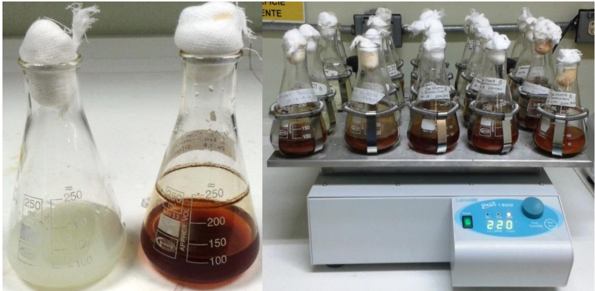
Figura. 11.5. Adaptación y oxidación de las cepas microbianas. Elaborado por: Gabriela González
