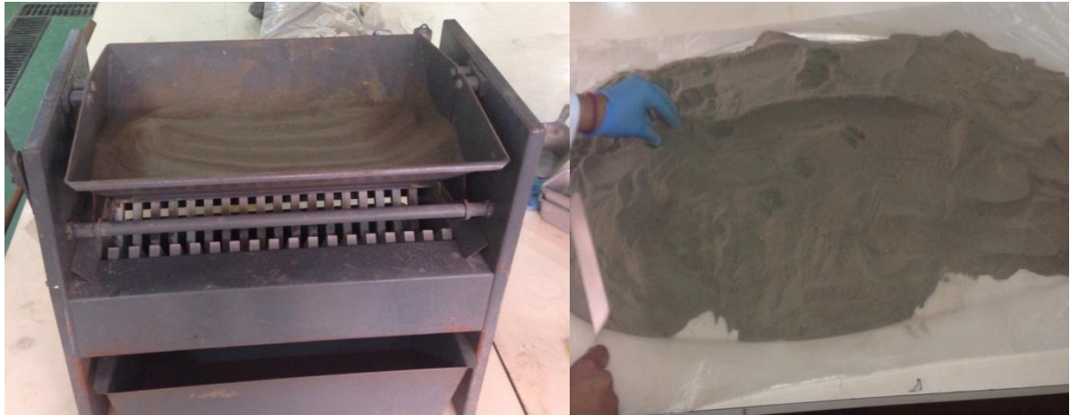
Figura. 11.7. Cuateo y Homogeinización del mineral aurífero. Elaborado por: Gabriela González
