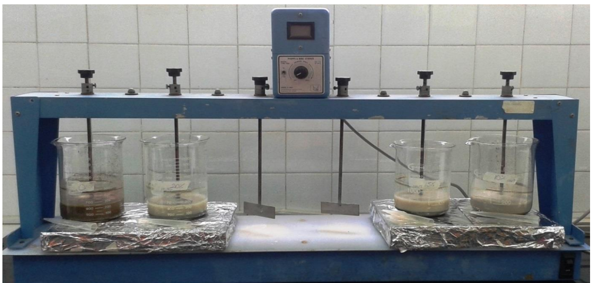
Figura. 11.10. Cianuración del mineral biooxidado (equipo de jarras)
