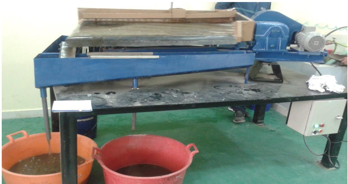
Figura. 11.6. Concentración en mesa vibratoria del mineral aurífero refractario. Elaborado por: Gabriela González
