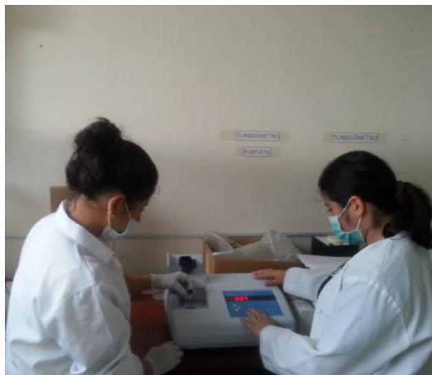
Figura 7. Proceso de medición de turbidez
