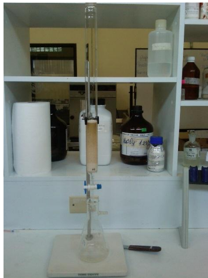
Figura 3: Adsorción continua de compuestos fenólicos
