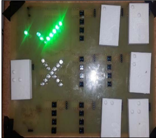
Figura. 2.11. Señalización de una respuesta correcta en el bloque de señalización luminosa.
