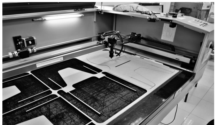
Figura 1.12. Proceso de grabado y corte de la silla. Fuente: Fab Lab UTPL (2015). Emosilla. [Fotografía]. Cortesía: Fab lab UTPL.
