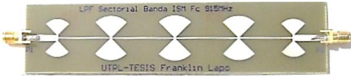
Figura 3.9 Implementación filtro 2 – sectorial 915MHz Fuente: Elaboración propia
