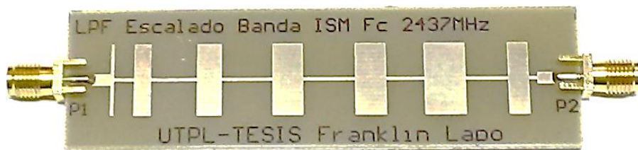
Figura 3.5 Implementación filtro 1 – escalado 2437MHz Fuente: Elaboración propia
