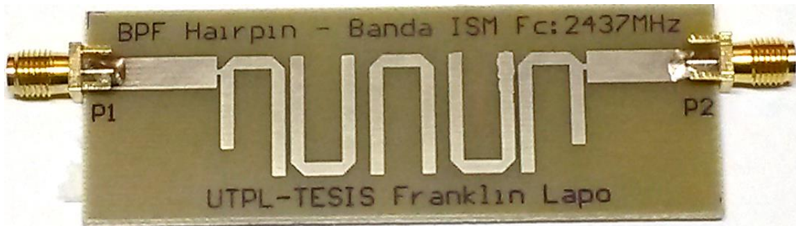
Figura 3.25 Implementación filtro 6 – Hairpin 2437MHz Fuente: Elaboración propia
