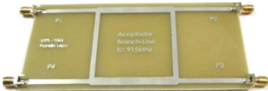
Figura 3.55 Implementación acoplador 1 híbrido 90°, 915MHz Fuente: Elaboración propia
