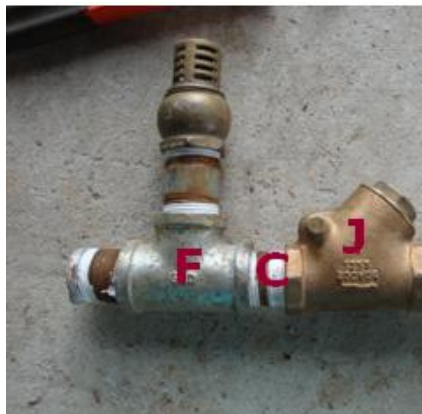
FOTO 17. Armado de la válvula de impulso
