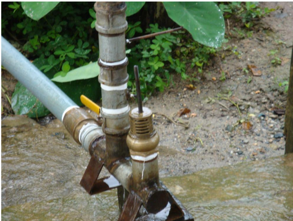
FOTO 10. Bomba de ariete con válvula de pie (válvula de derrame)
