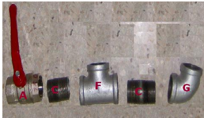
FOTO 3-2. Armado de la caja de válvulas
