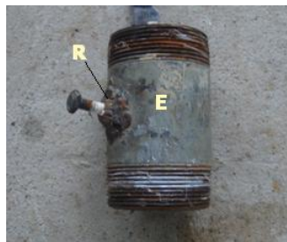
FOTO 6-7. Armado de la válvula de descarga
