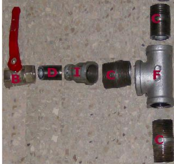
FOTO 3-13. Armado de la sección de salida o impulso
