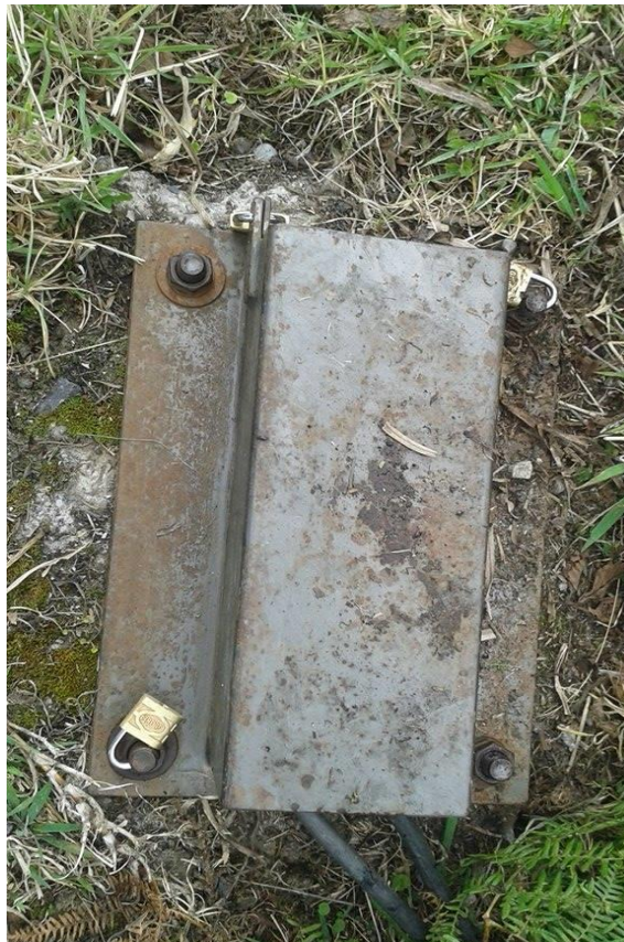
Fotografía 4. Estructura de acero para protección del Equipo MetroCount 5600
