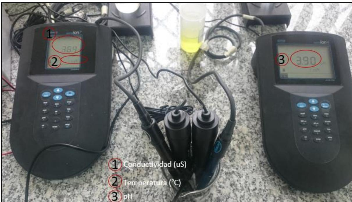
Figura 4.17 Análisis de la muestra de agua distribuida con los instrumentos de referencia.
