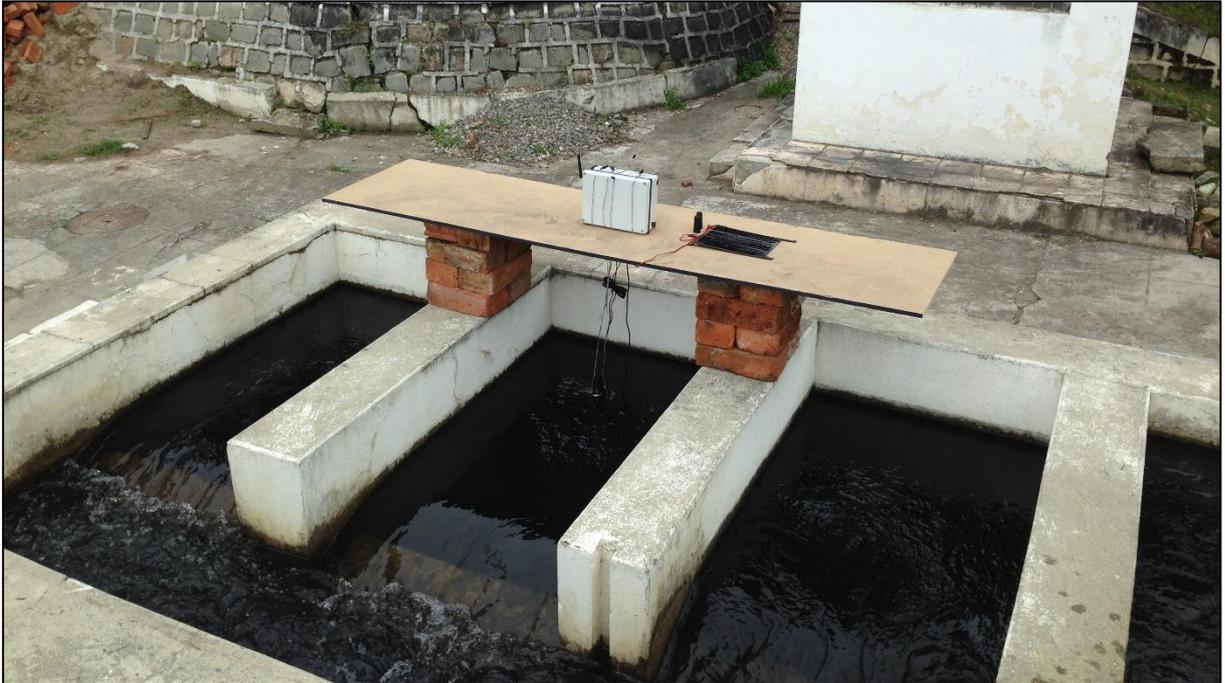
Figura 4.22 Análisis del agua cruda en la PTAP utilizando el sistema desarrollado.
