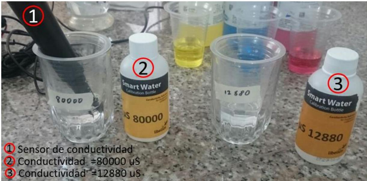
Figura 4.3 Sensor de conductividad y soluciones para su calibración.
