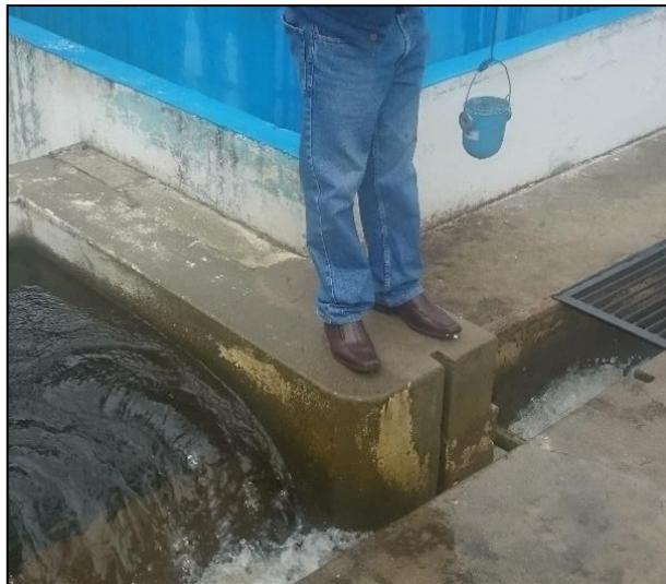
Figura 4.7 Toma de una muestra para el análisis, agua cruda.
