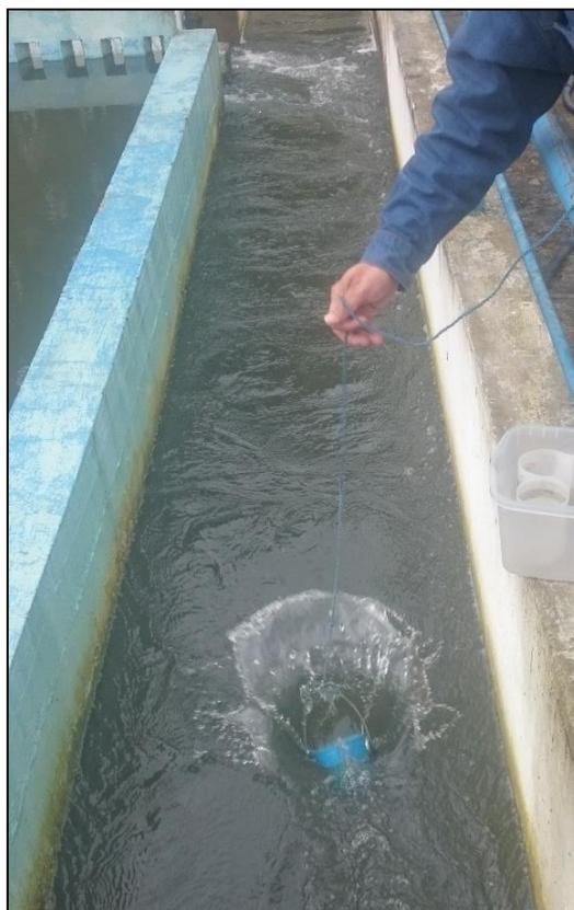
Figura 4.10 Toma de la muestra de agua en la etapa de sedimentación.
