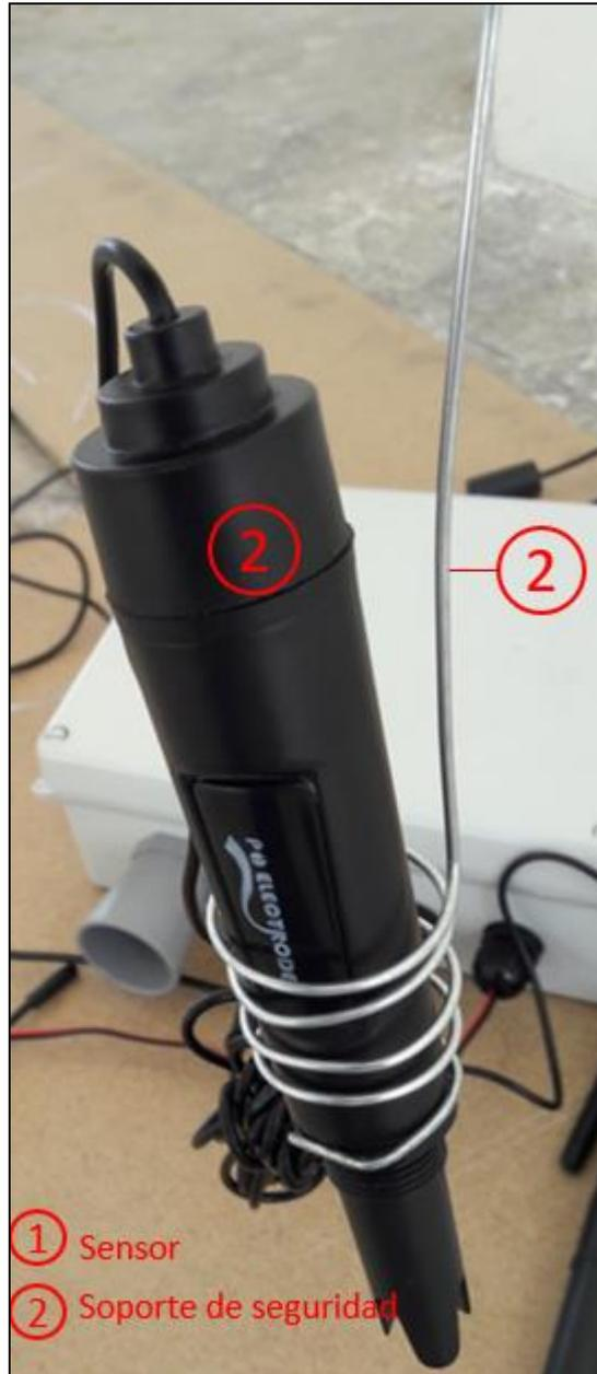
Figura 4.21 Soporte para los sensores.
