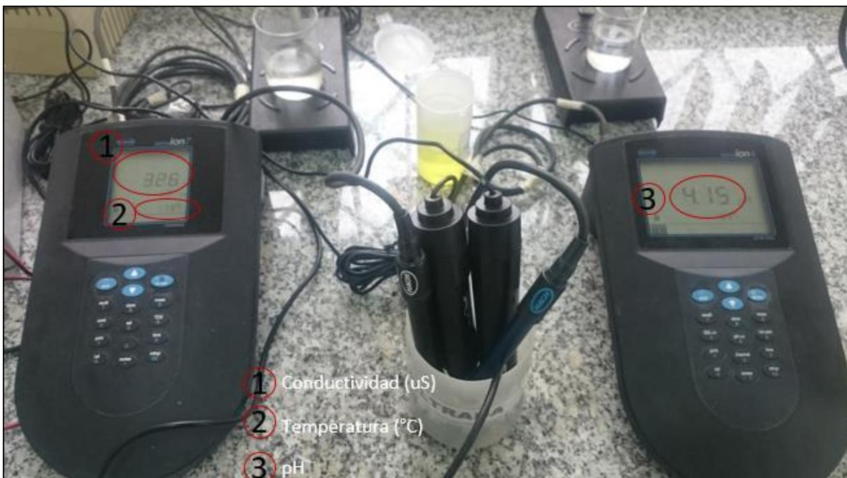
Figura 4.14 Análisis de la muestra de agua filtrada con los instrumentos de referencia.
