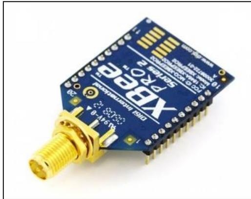
Figura 3.3 Módulo Xbee pro s2.
