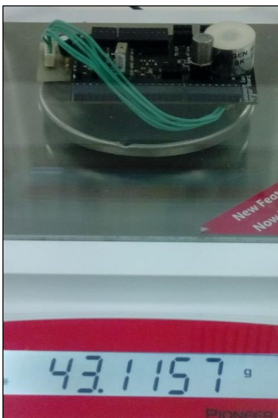
Placa de sensores de gases.
