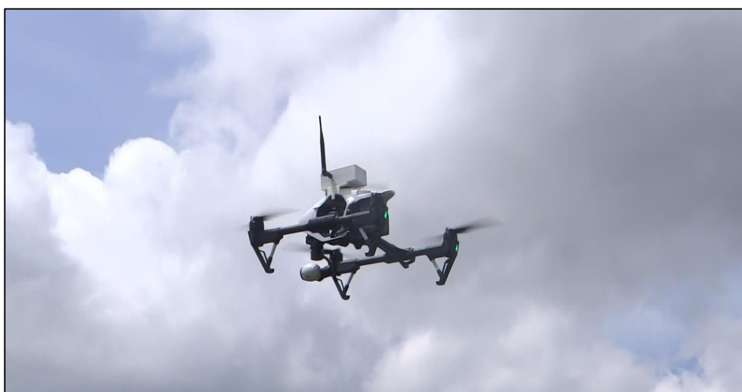
Figura 4.32. VANT, junto con el sistema de calidad de aire.
