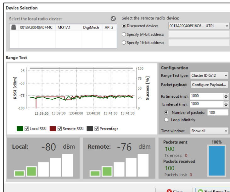
Figura 4.6. Prueba de cobertura 300 metros de distancia. Fuente: Imagen propia de los autores.
