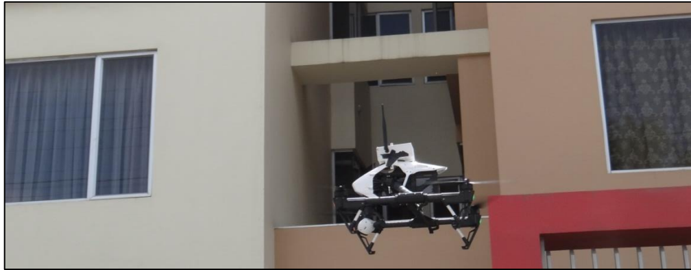
Figura 4.20. Vehículo aéreo no tripulado en vuelo, con el sistema de calidad de aire Fuente: Imagen propia de los autores.
