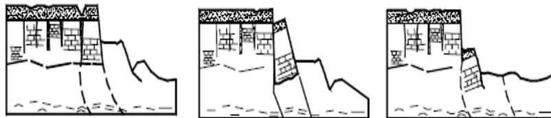
FIG. 11.- DESLIZAMIENTOS RETROGRESIVOS
