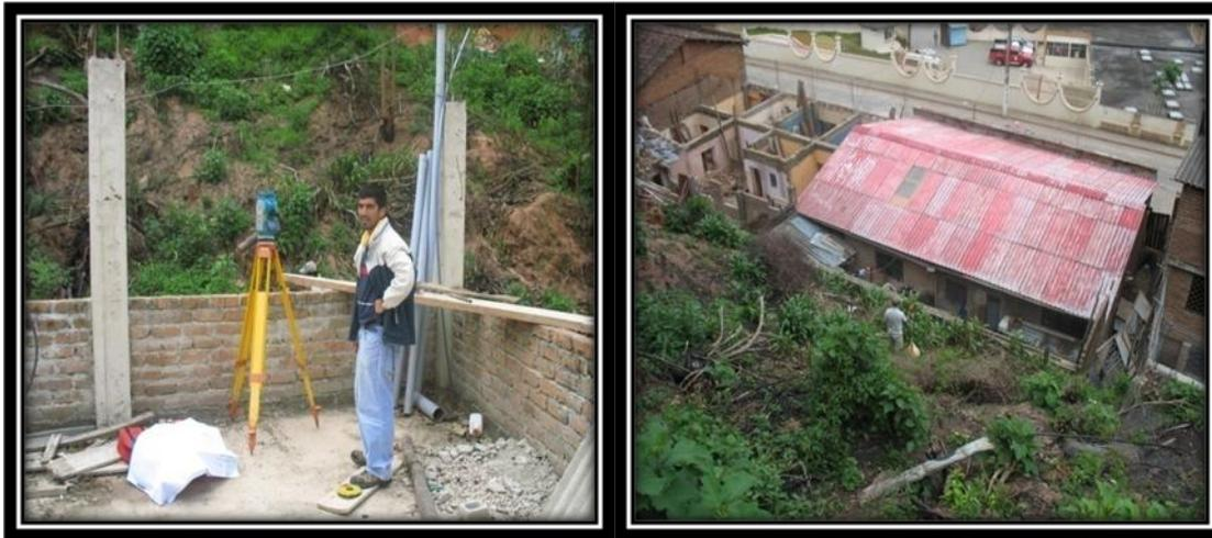
FOTO 4 Y 5.- LEVANTAMIENTO TOPOGRÁFICO DEL TALUD DE LA AV. LOJA
