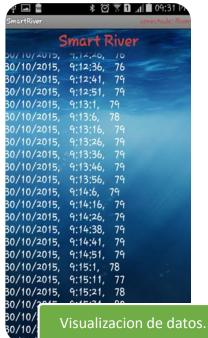
Para determinar el error de transmision de datos del nodo hacia el smartphone comparamos los datos que se encuentran almacenados en la micro-SD del nodo, con los datos almacenados en el smartphone al finalizar la trasmisión (ver figura 4.25), obteniedo resultados menores al 1% (ver tabla 4.4).
