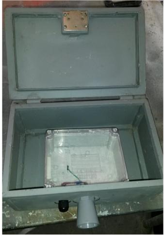
Figura 4. 35. Caja protectora del nodo Fuente: El autor.
