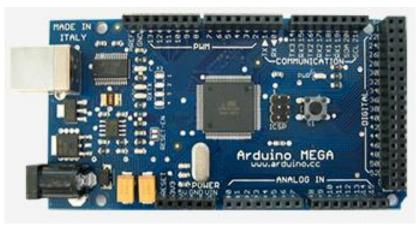
Figura 3. 2. Dispositivo Arduino Mega Fuente: Tomada de [53].
