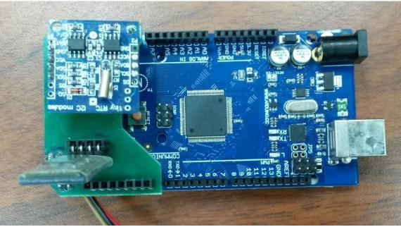
Figura 4. 16. Shield para Bluetooth y RTC. Fuente: El autor.
