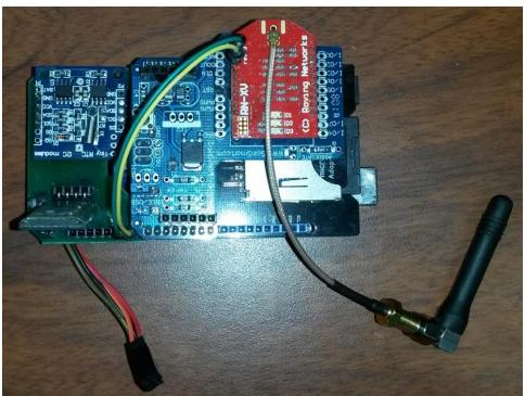
Figura 4. 17 Montaje prototipo de nodo.
