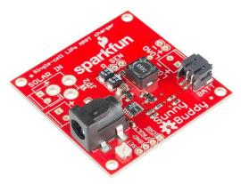
Figura 4. 30. Cargador solar MPPT. Fuente: Tomada de [76].
