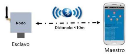
Figura 3. 9. Configuración maestro-esclavo Fuente: Elaborado por el autor.
