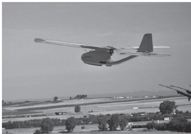
Figura 2.6 Drone de ala fija para an6lisis de biomasa.
