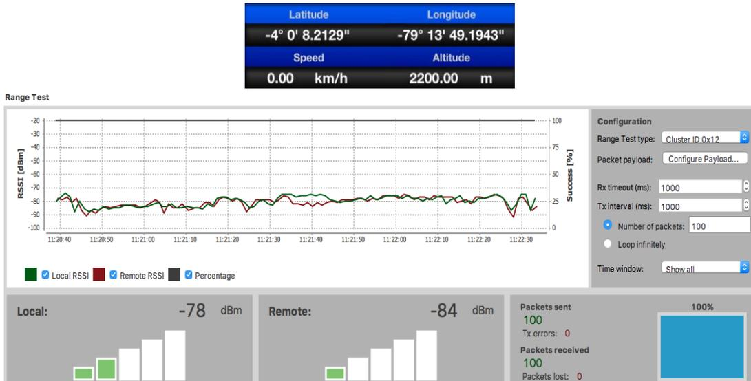
Figura 4.32 Ubicación y test de rango a 37m en estado vinculado.
