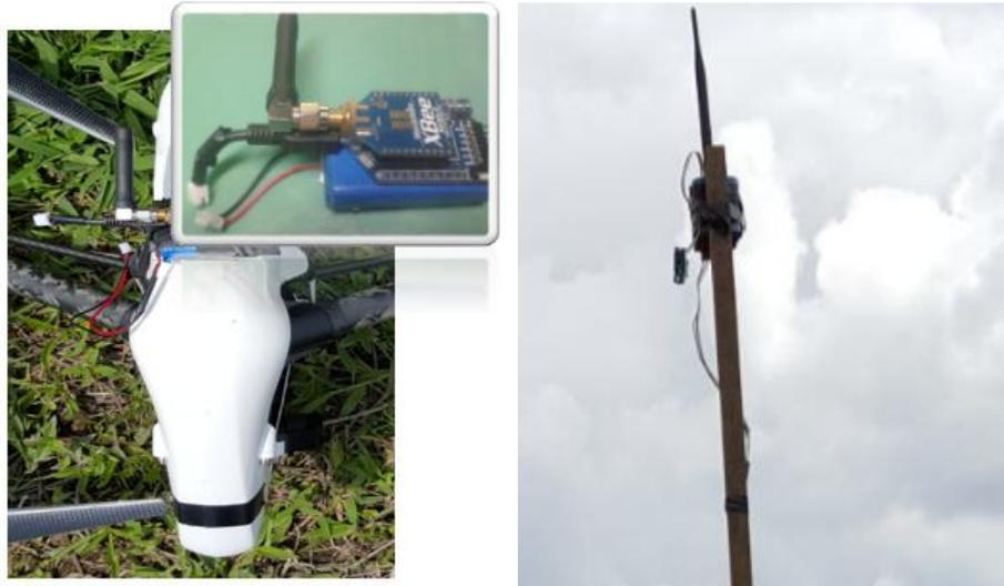
Figura 4.43 Test de rango nodo móvil-estación. Antenas dipolo. Polarización vertical.
