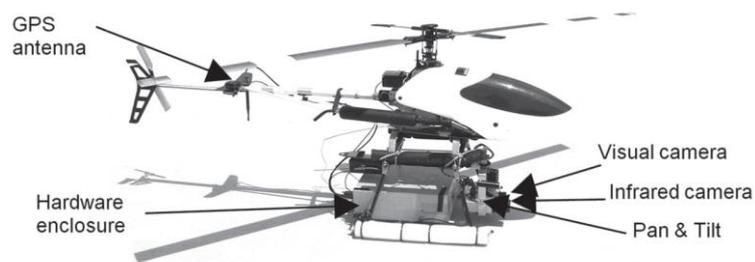
Figura 2.8 Helicóptero Hero. Cámaras visual e infrarroja y sistema GPS y hardware requerido.
