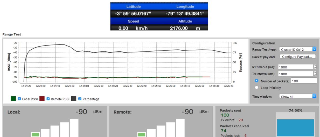
Figura 4.33 Ubicación y test de rango a 414m en estado vinculado.
