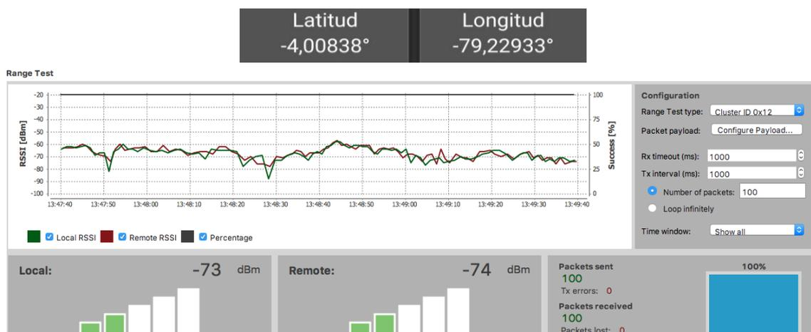
Figura 4.35 Test de rango a 18m del nodo remoto.
