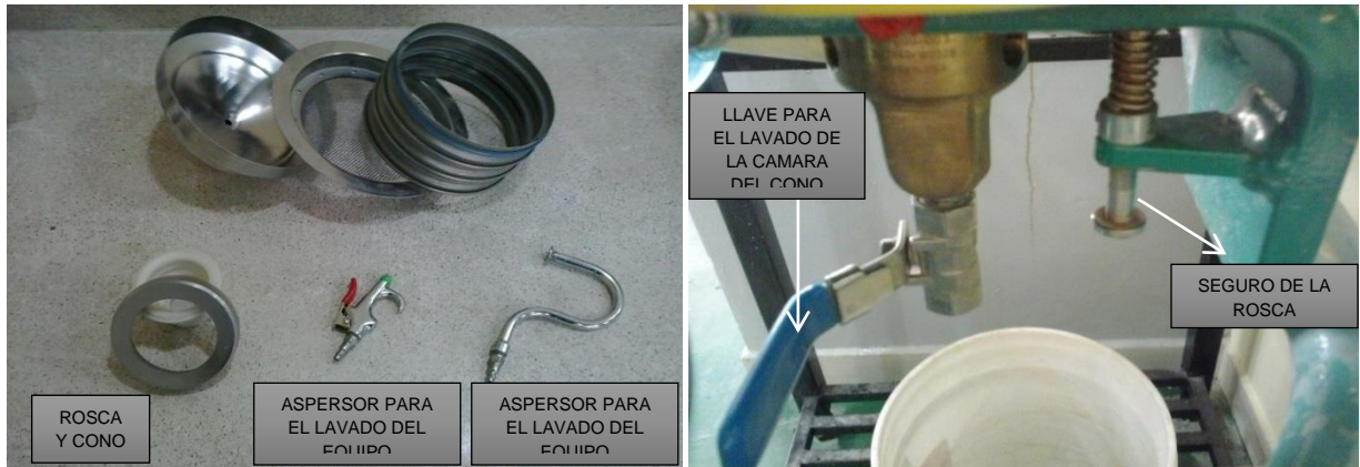
Figura 18. Partes del equipo Knelson: 1) Accesorios y aspersores; 2) Llave para el lavado de la cámara del cono (izquierda) y seguro de la rosca (derecha). Fuente: Robles. L, 2016.
