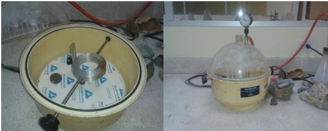
Figura 8. Sección pulida. Muestra colocada en el equipo de cámara de vacío BUEHLER.
