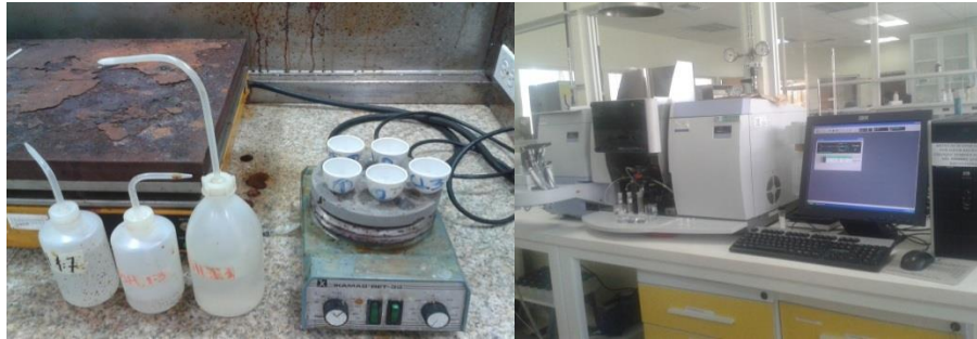
Figura 14. Digestión de muestras: Lectura en absorción atómica. Código de muestras: RPL 1, RPL 2, RPL 1,9, RPL 3, RPL4
