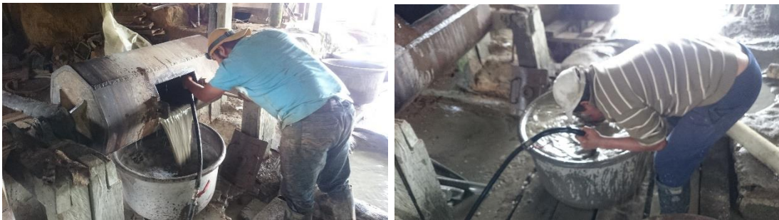
Gráfico 22. Lavado del tanque de amalgamación y eliminación de lodo. Fuente: D. González, 2016.
