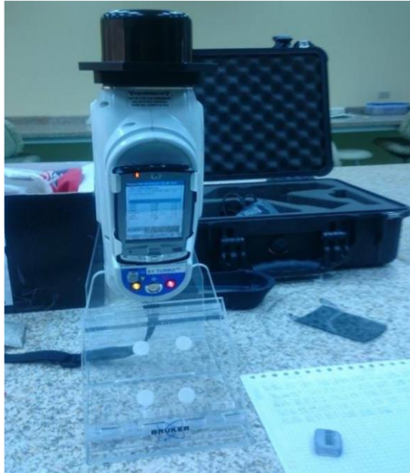
Gráfico 41. Equipo de Fluorescencia BRUKER S1. Fuente: D. González, 2016.
