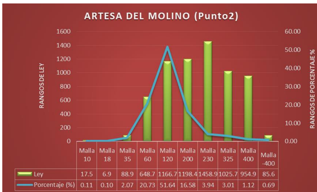
Gráfico 50. Punto 2, concentrado de la artesa del molino (Malla vs. Ley vs. Porcentaje de recuperación %).
