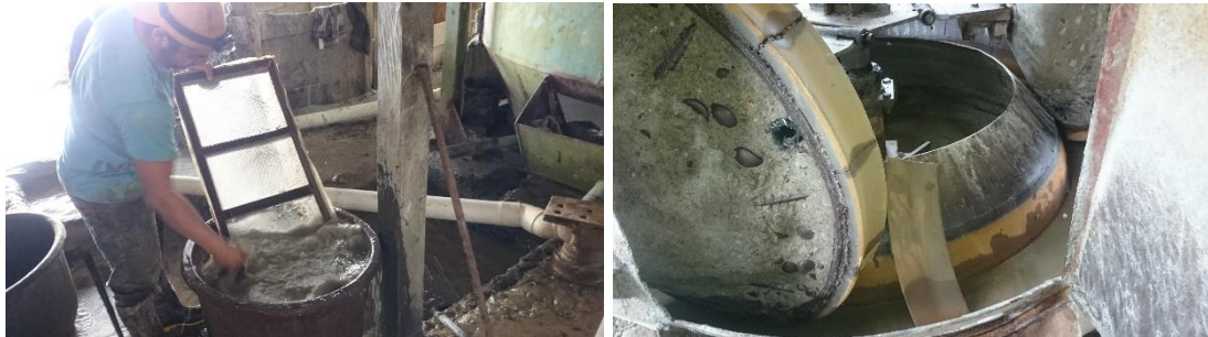
Gráfico 16. Lavado del molino. Fuente: D. González, 2016.
