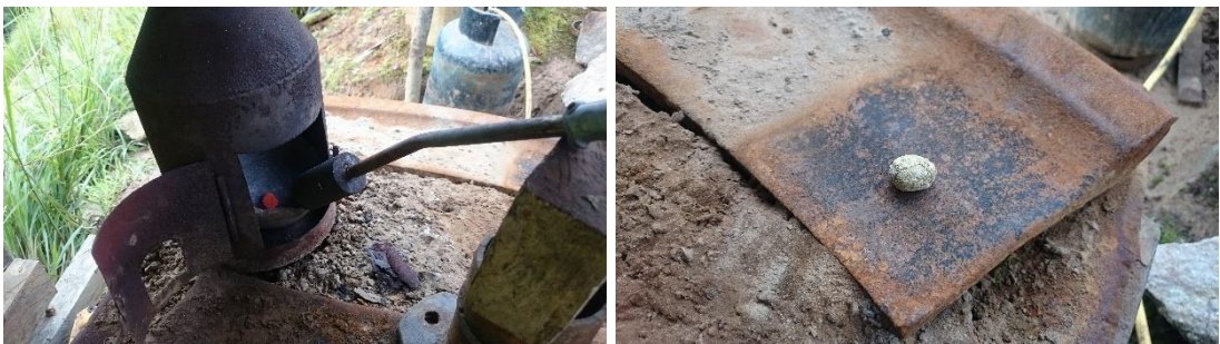
Gráfico 26. Eliminación del restante de mercurio por adición de calor. Fuente: D. González, 2016.
