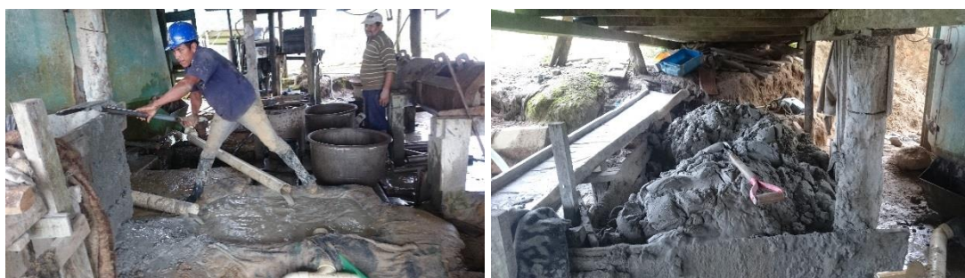
Gráfico 18. Tanque de sedimentación y reservorio. Fuente: D. González, 2016.
