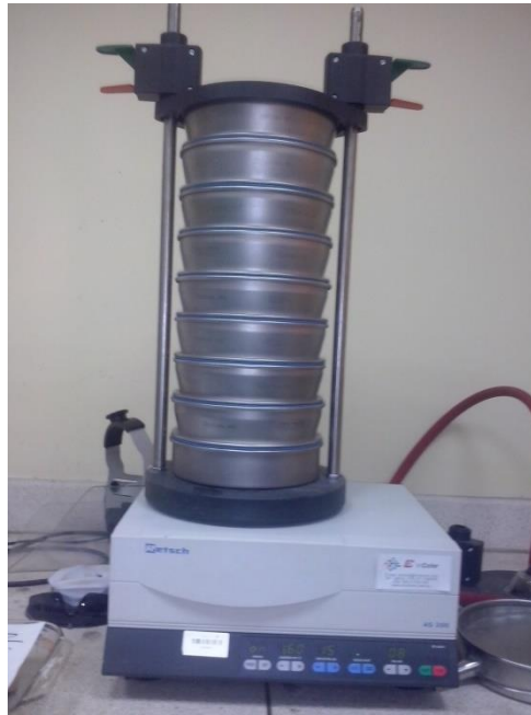
Gráfico 42. Ensayo granulométrico. Fuente: D. González, 2016.
