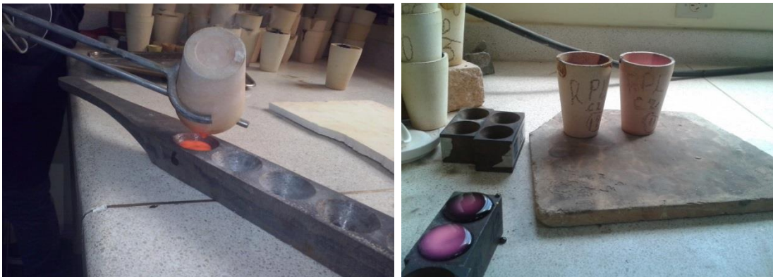
Gráfica 40. Fusión y vertido del material fundido. Fuente: D. González, 2016.
