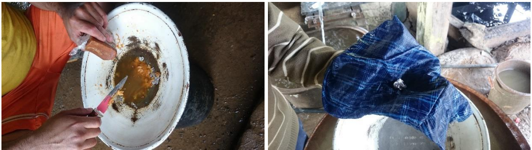
Gráfico 25. Lavado de amalgama e inicio del proceso de filtración de mercurio. Fuente: D. González, 2016.
