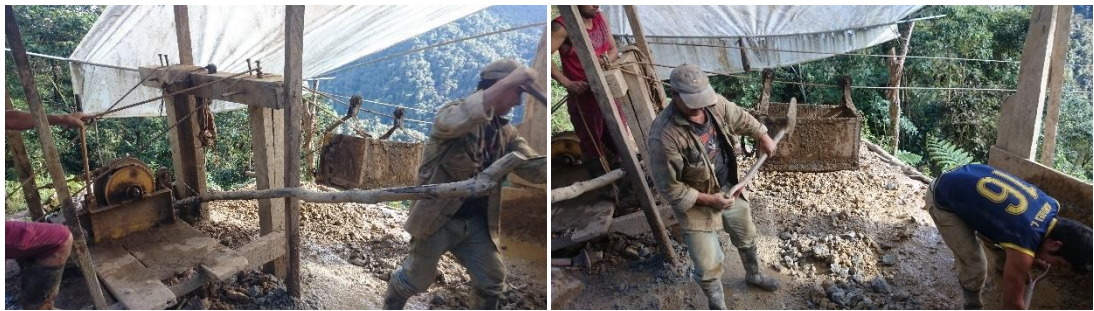
Gráfico 10. Tarabita impulsada por gravedad. (Parte superior). Fuente: D. González, 2016.
