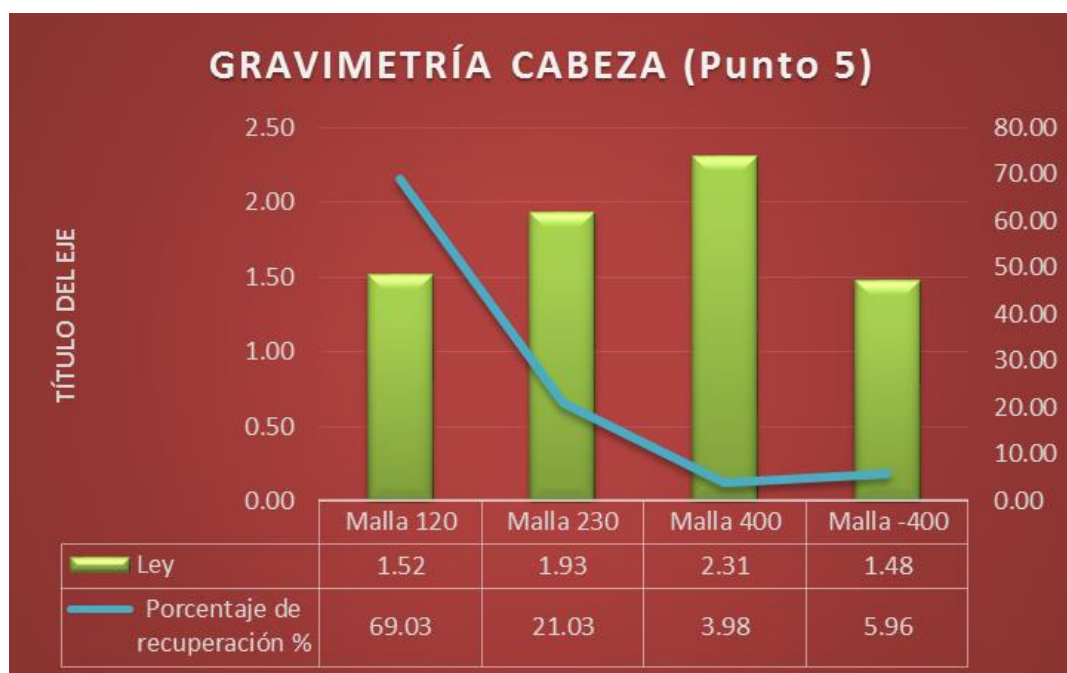
Gráfico 53. Punto 5, concentración gravimétrica (mineral de cabeza) (Malla vs. Ley vs. Porcentaje de recuperación %).
