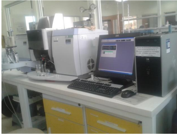
Gráfico 47. Absorción atómica equipo: equipo Analyst 400 modelo PerkinElmer con el programa WinLab 32 AA Flame. Fuente: D. González, 2016.
