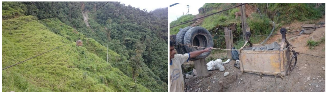
Gráfico 11. Tarabita impulsada por gravedad. (Tolva de ingreso). Fuente: D. González, 2016.
