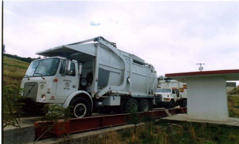
Figura No 9. Recolector de residuos y balanza en un relleno Elaborado por: Diana Gabriela Huanca Chamba
