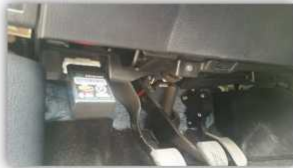
Figura 74. Entrada OBDII del auto Toyota Rav4 2015. Fuente: el autor.
