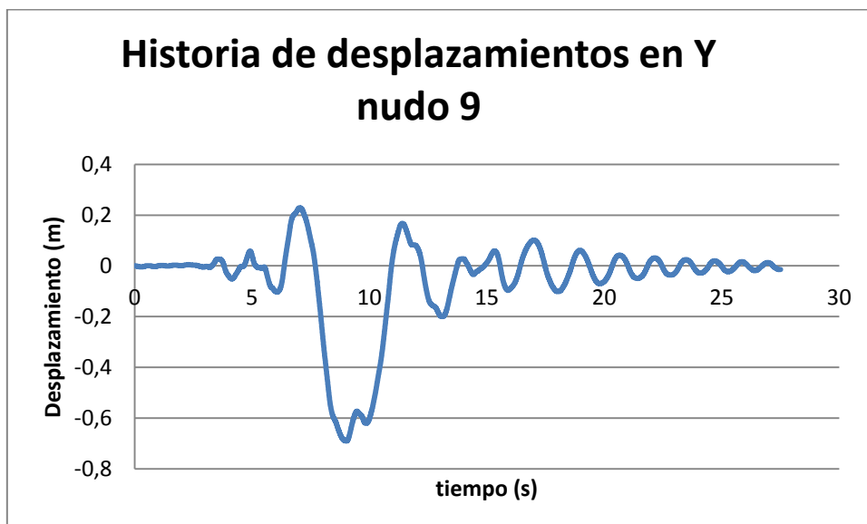
FIGURA 62 – Historia de desplazamiento en dirección Y del nudo 9
