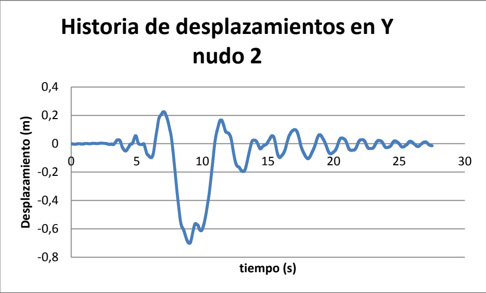
FIGURA 60 – Historia de desplazamiento en dirección Y del nudo 2
