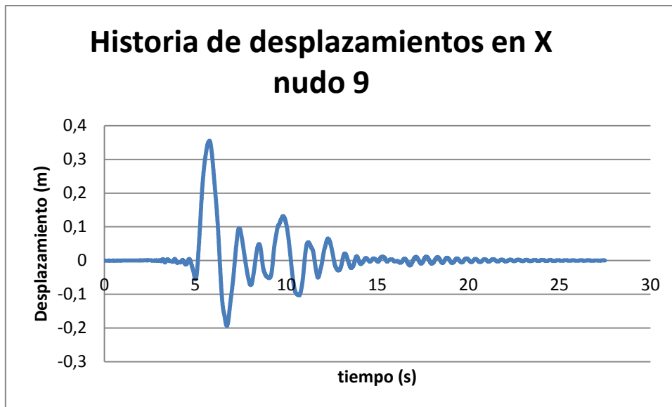
FIGURA 61 – Historia de desplazamiento en dirección X del nudo 9
