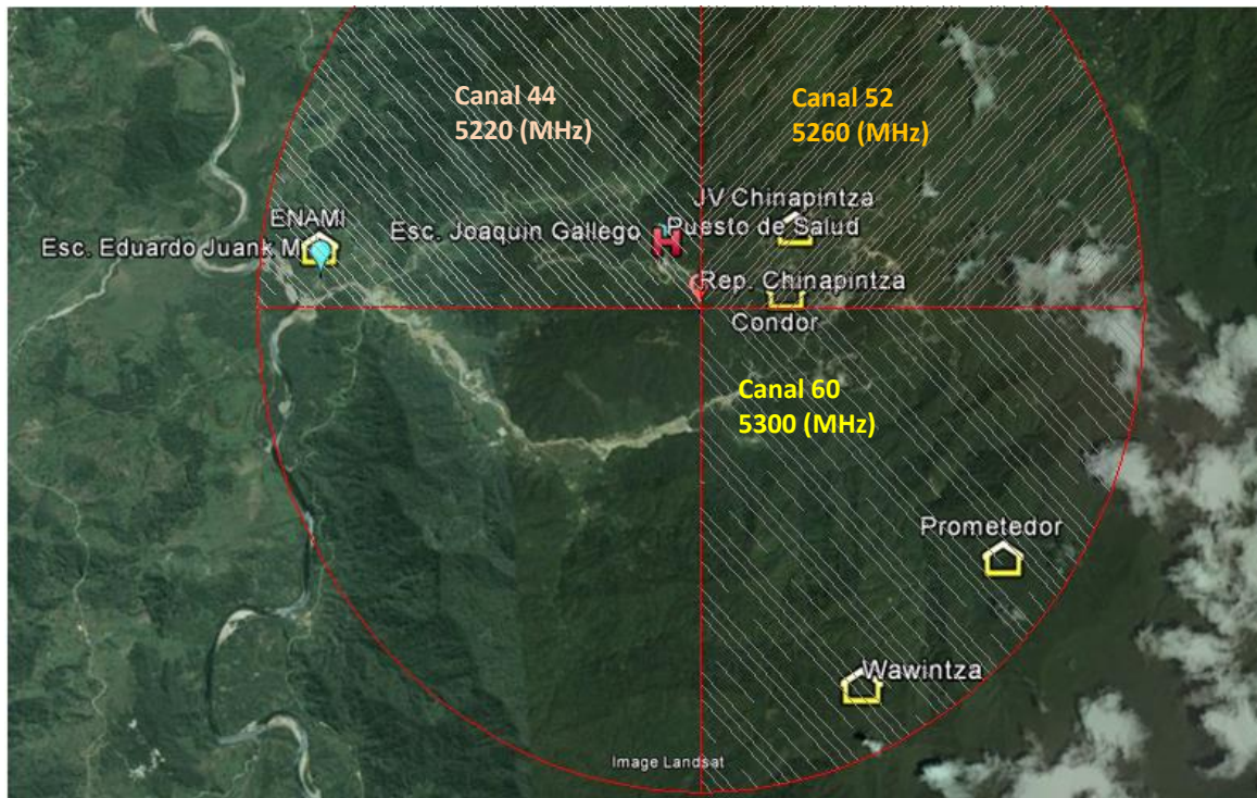
Figura 7: Cobertura de antenas sectoriales y distribución de canales
