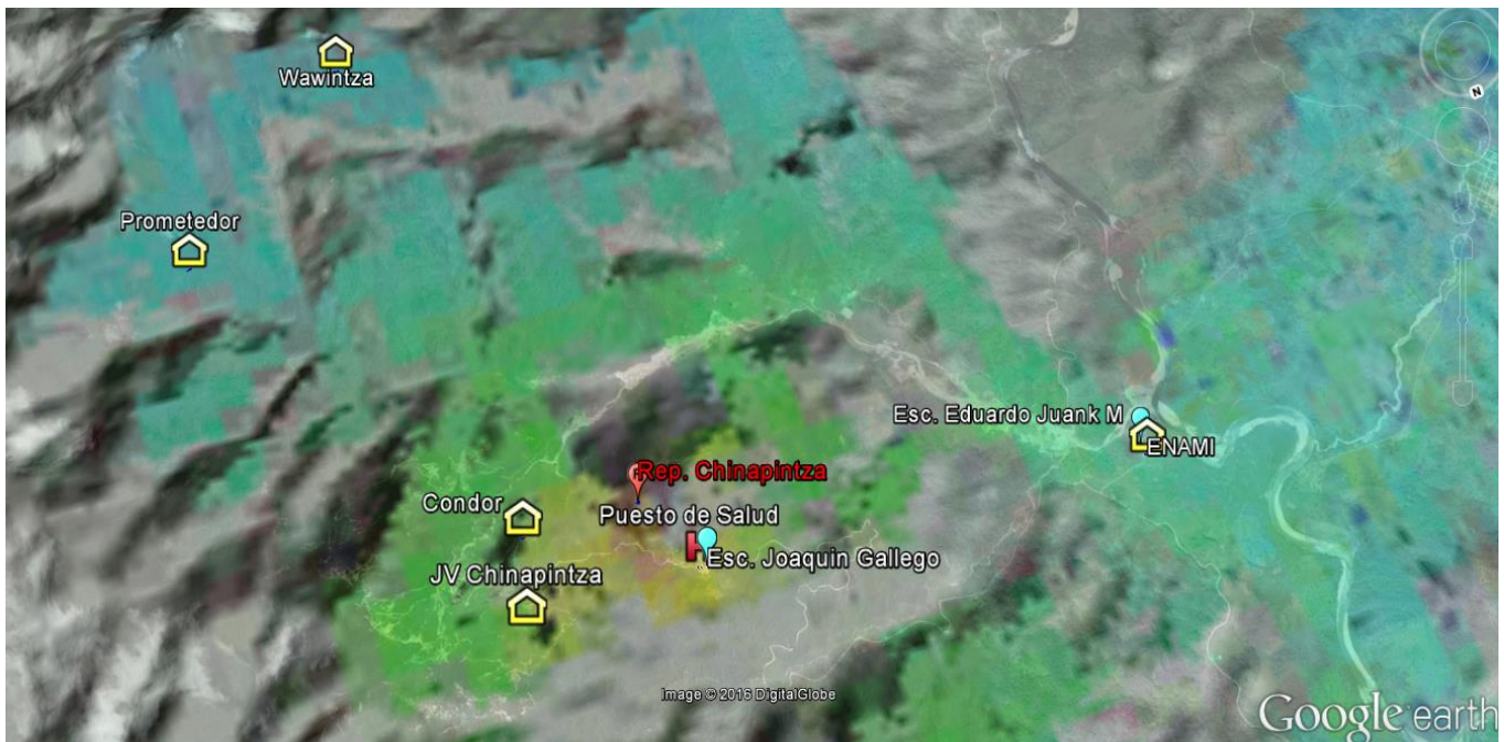
Figura 8: Cobertura de antenas sectoriales en localidad Chinapintza
