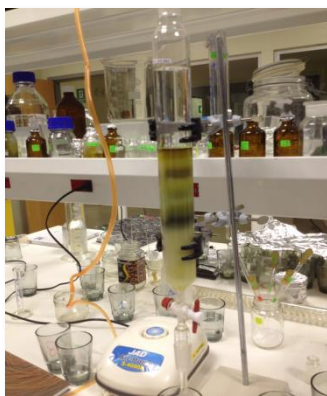
Fig. 22. Columna cromatográfica del extracto de Acetato de etilo
