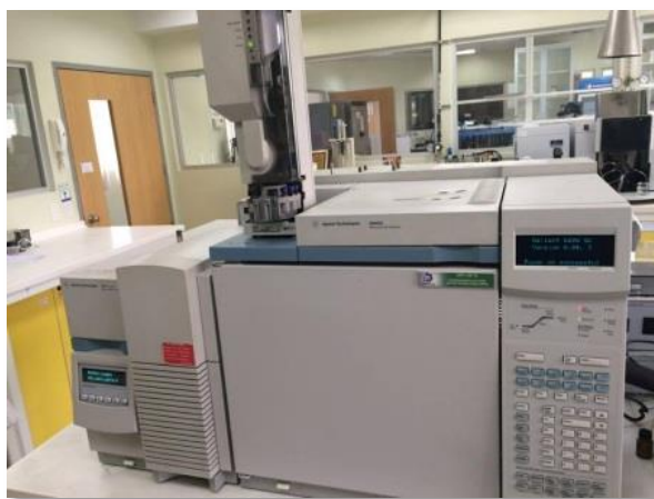
Fig. 5. Cromatógrafo de Gases acoplado a Espectrometría de Masas
