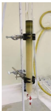
Fig. 24. Columna cromatográfica del extracto de Metanol Fuente: Autor 2016
