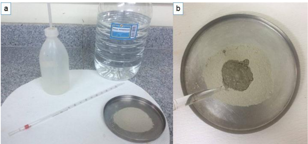
Figura 24. a) Materiales para ensayo de Eliminación de materia orgánica b) Ensayo de Eliminación de materia orgánica Elaborado por: El autor
