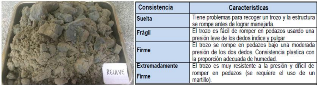
Figura 17. a) Relave de mina b) Tabla para estimación de la consistencia de un suelo Fuente: Uribe S., (2014)
