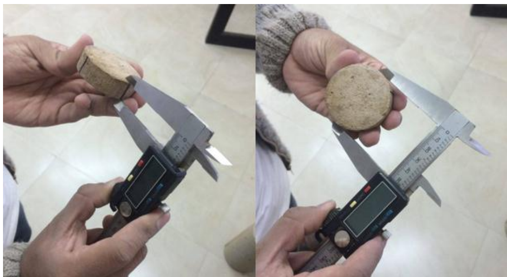
Figura 34. Toma de medidas (espesor y diámetro) de discos Elaborado por: El autor
