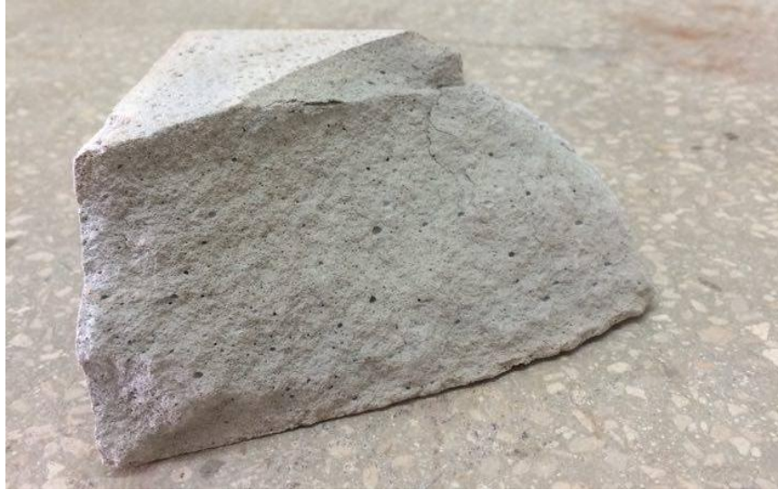
Figura 53. Porosidad de ladrillos elaborados Elaborado por: El autor.
