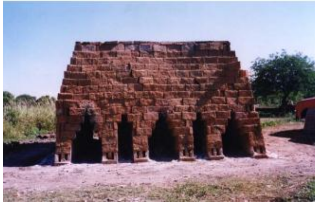
Figura 3. Horno utilizado para la cocción de ladrillos. Fuente: Bianucci, (2009)
