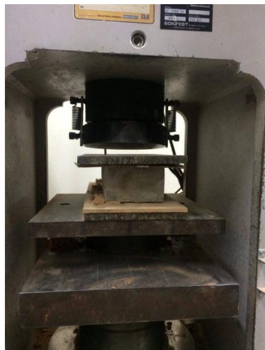
Figura 41. Ensayo de compresión simple de ladrillo Elaborado por: El autor.
