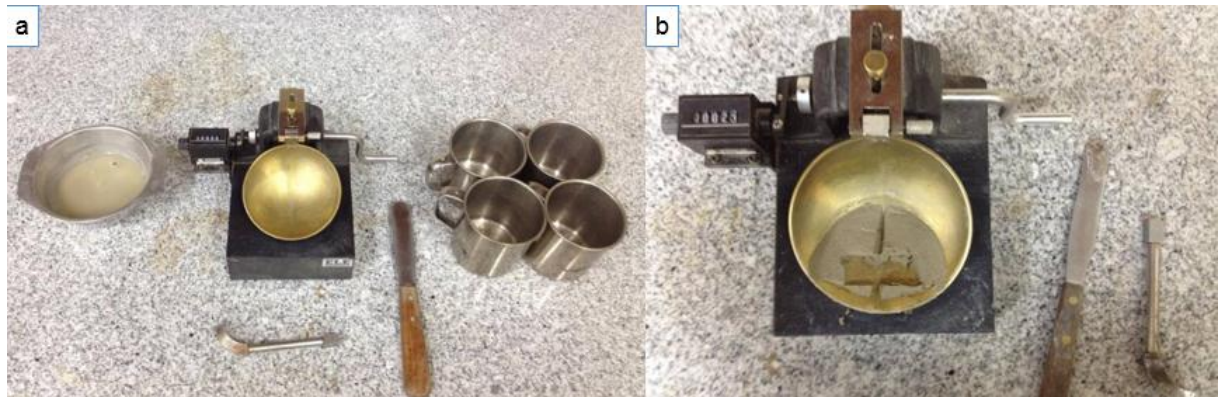
Figura 20. a) Materiales para ensayo de límite líquido b) Ensayo de límite líquido Elaborado por: El autor
