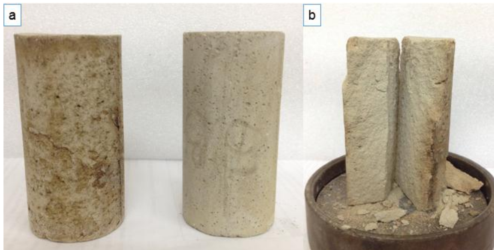
Figura 39. a) Cilindro elaborado mediante combinación obtenida izq. frente a un cilindro de hormigón normal der. b) Cilindro con mezcla óptima ensayado a compresión simple. Elaborado por: El autor
