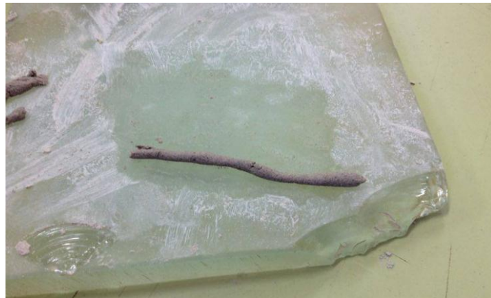
Figura 21. Ensayo de límite plástico Norma ASTM D 4318 Elaborado por: El autor
