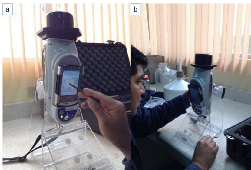
Figura 28. a) Preparación del equipo para FRX b) Análisis de muestra Elaborado por: El autor
