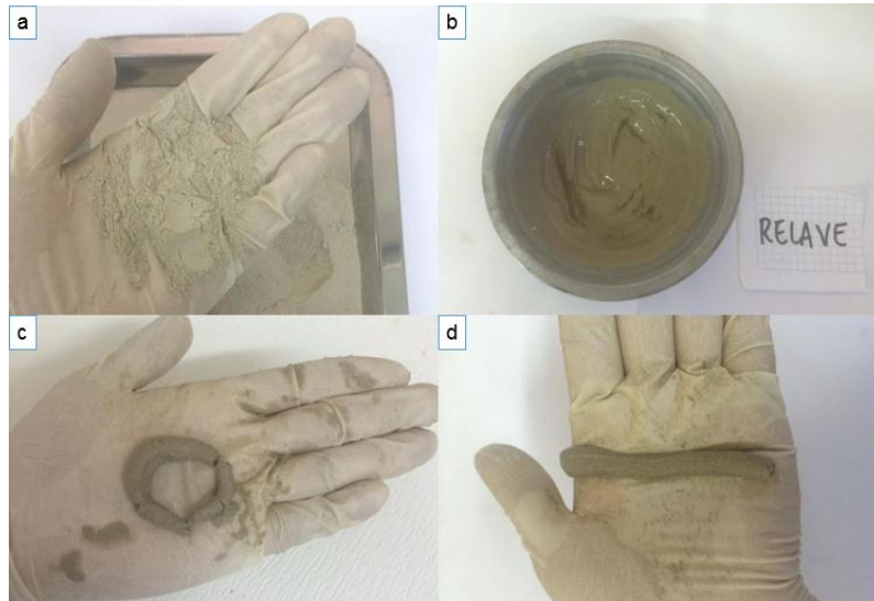
Figura 16. Ensayo de Sensación al tacto. Elaborado por: El autor
