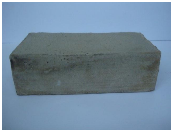
Figura 51. Ladrillo elaborado con mezcla óptima Elaborado por: El autor
