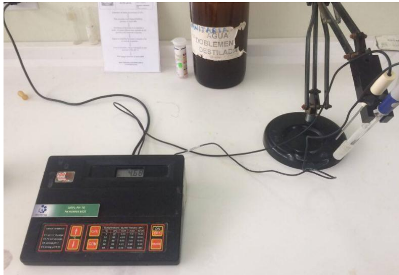
Figura 26. Equipo para determinación del pH de un suelo. Elaborado por: El autor
