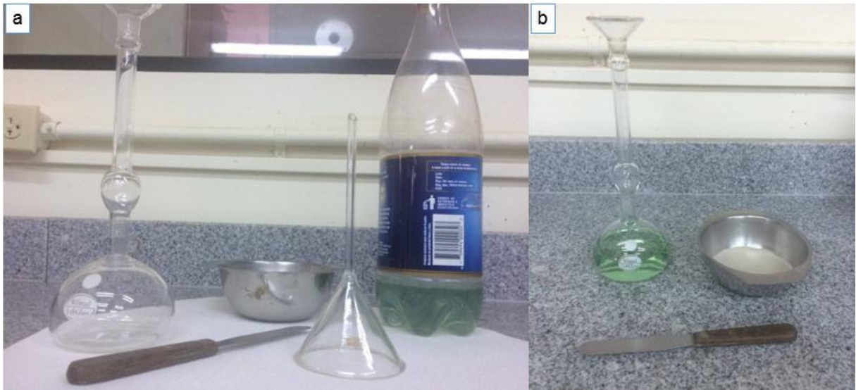
Figura 23. a) Materiales para ensayo de Densidad Real Elaborado por: El autor.
