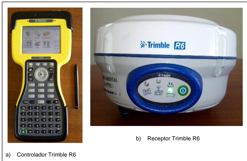
Figura 12. Controlador y receptor del equipo GPS Trimble R6 Elaboración: La autora
