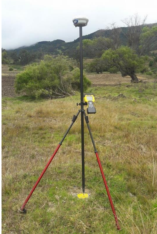
Figura 10. Receptor Trimble R6 (Móvil). Fuente: Elaboración Propia.
