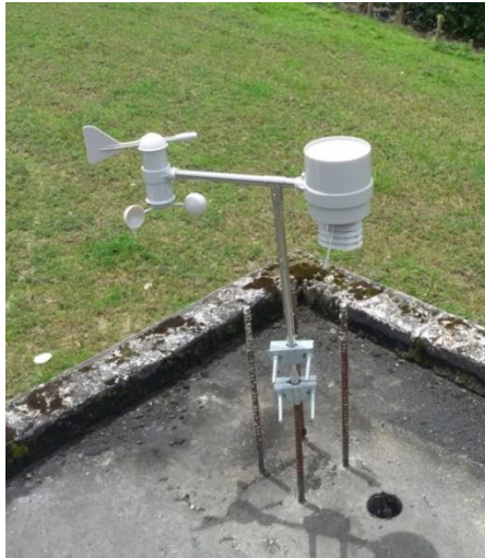
Figura 14. Estación Pluviométrica Digital. Fuente: Elaboración Propia.
