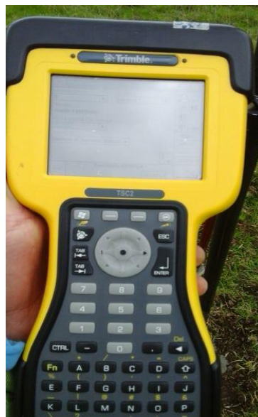
Figura 11. Controladora TSC2 Trimble. Fuente: Elaboración Propia.
