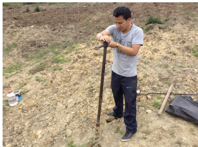
Figura 24. Perforación para pozos de muestreo. Fuente: Elaboración Propia.
