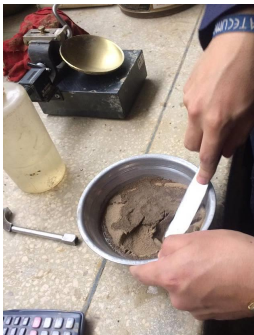
Figura 31. Realización de límites de Atterberg. Fuente: Elaboración Propia.
