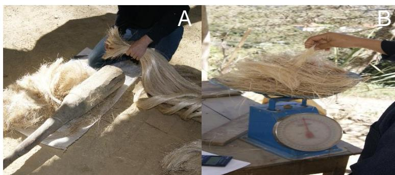
**Foto 2.1:** (A) Cortado de fibra de abacá de 10 cm de largo, (B) pesado de fibra de abacá.
