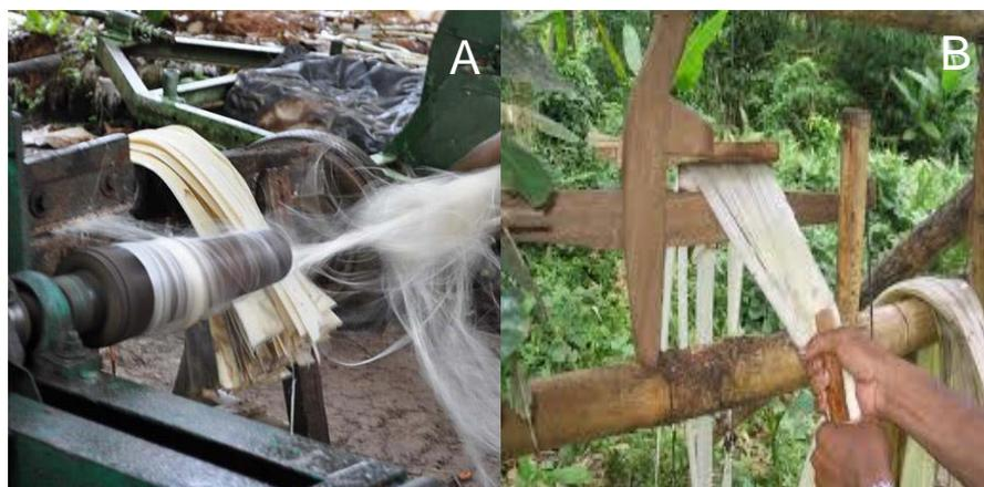
**Imagen 2.2:** (A) Desfibrado de abacá a máquina, (B) Desfibrado rústicamente de abacá.
