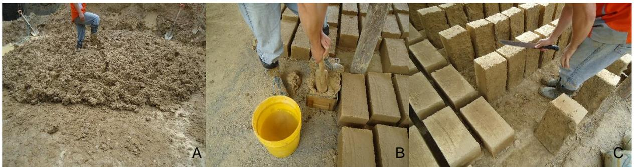
**Foto 1.6:** A Batido de tierra, B Apisonamiento, C Adobes colocados de lado para su posterior secado.
