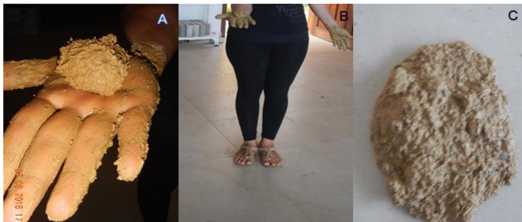
**Foto 2.10:** (A) Mezcla, (B) Mezcla a 1m de altura, (C) Muestra lista para la construcción del composite.
