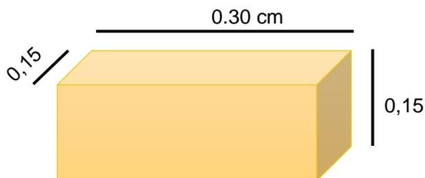
**Figura 2.3:** Dimensiones del composite a construir.
