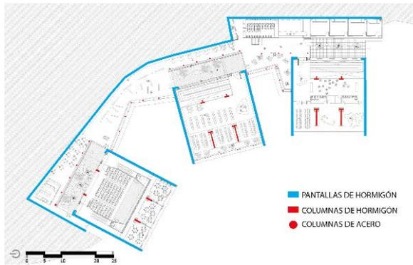
Figura 79. Esquema estructural
