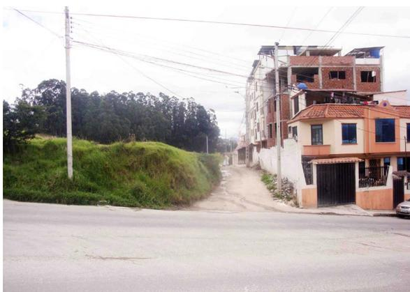
Figura 58. Calle C - 14-7. Vía de tierra que no supera los 5 metros de ancho, sin aceras ni bordillos.
