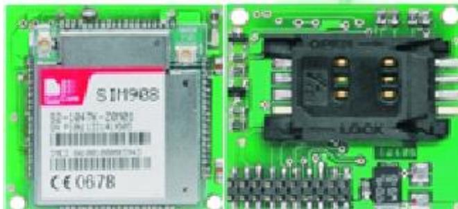
Figura 2.5. Módulo GPS/GSM.
