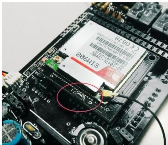
Figura 3.4. Jumper para el uso del GPS.
