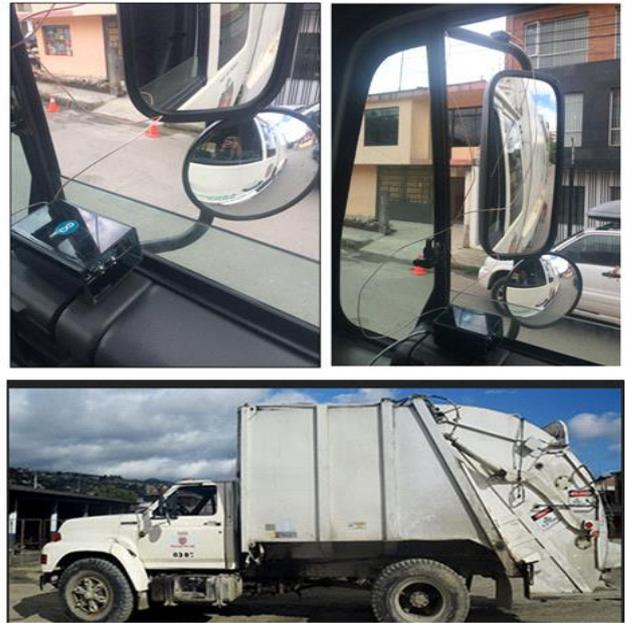
Figura 14. Instalación del prototipo en el vehículo recolector de RSM.
