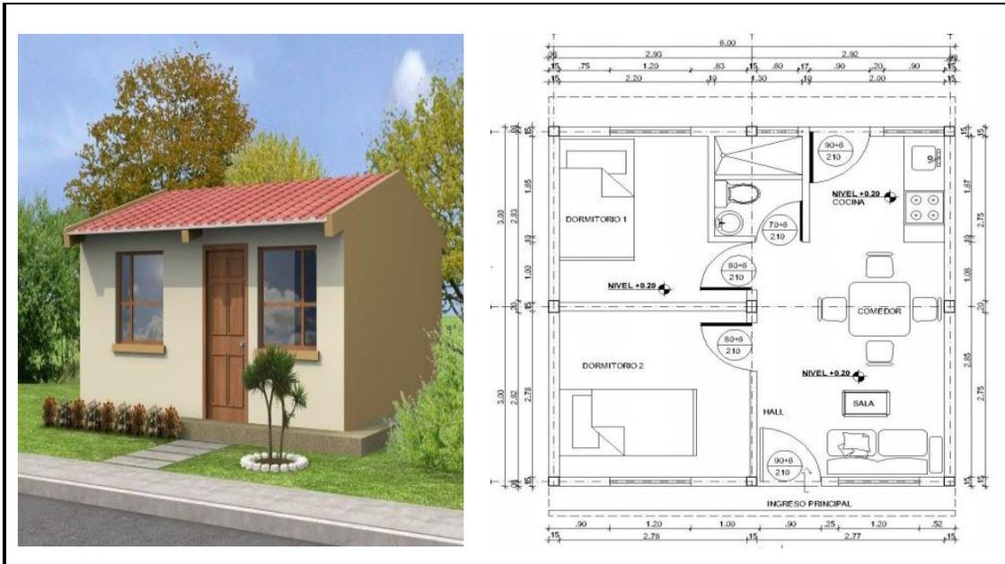
Figura 3. 6. Prototipo y plano de la vivienda tipo 36m<sup>2</sup>
