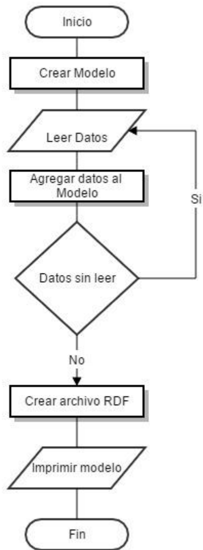
Figura 35 Diagrama de Flujo del Algoritmo de Transformación a Tripletas Fuente: El Autor Elaborado por: El Autor
