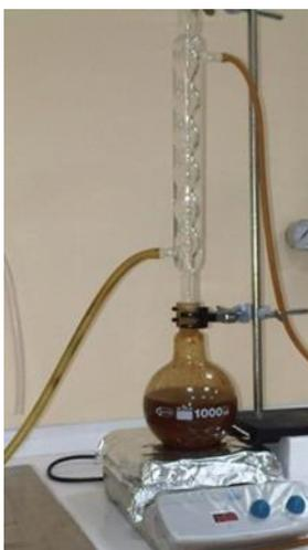
**Figura 8** Modificación de la arcilla con sales  $\text{FeCl}_3$ ,  $\text{MnCl}_2$ ,  $\text{AlCl}_3$
