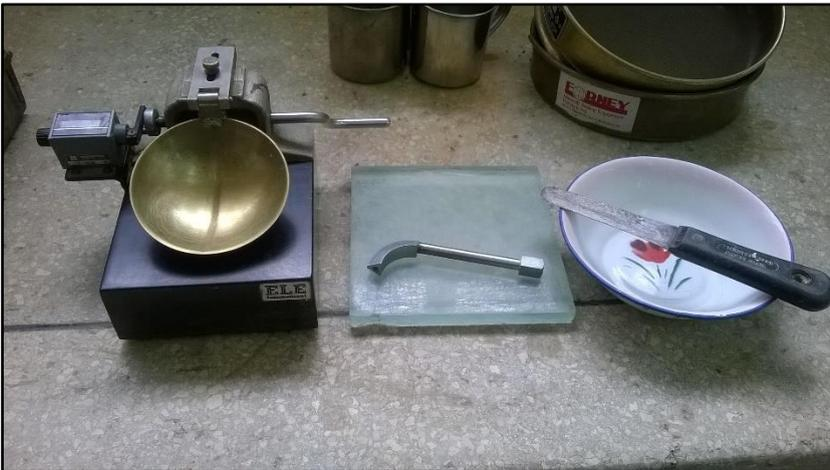
Figura 13. Fotografía equipo para determinación de límites.
