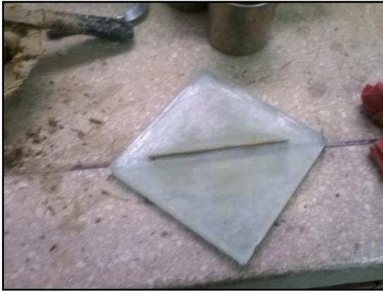
Figura 23. Fotografía de la determinación de límite plástico.
