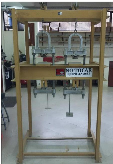
Figura 16. Fotografía de equipo para ensayo de consolidación.
