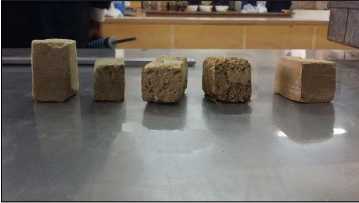
Figura 25. Fotografía de cubos para determinar la densidad del suelo.
