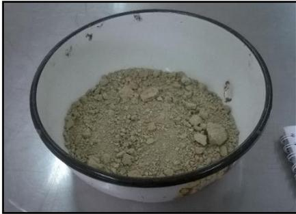
Figura 21. Fotografía de muestra para granulometría por lavado.
