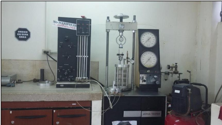
Figura 15. Fotografía del equipo para ensayo triaxial.
