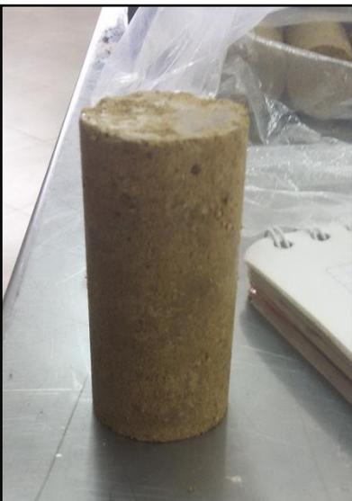
Figura 26. Fotografía de probeta remoldeada.
