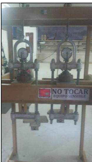
Figura 28. Fotografía de equipo de consolidación.
