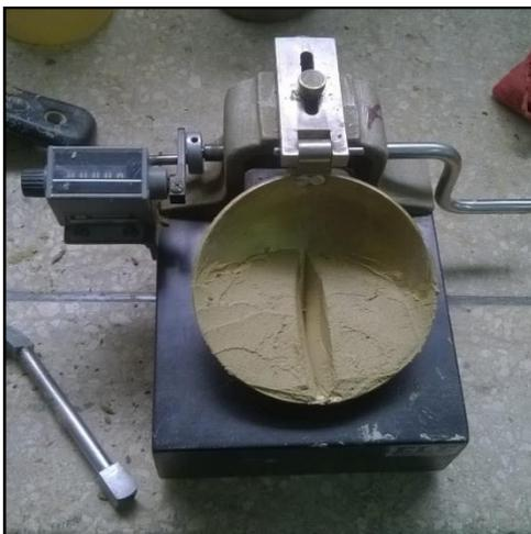
Figura 22. Fotografía de la determinación del límite líquido.
