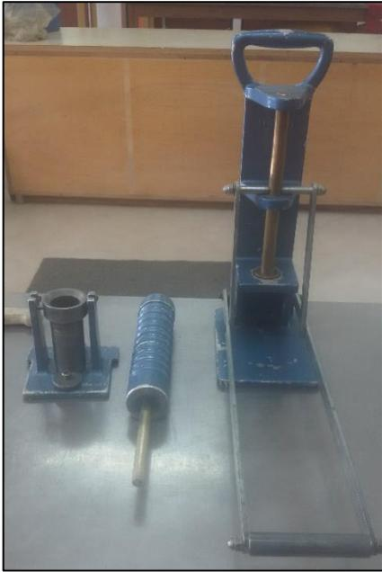
Figura 14. Fotografía equipo para remoldear muestras.
