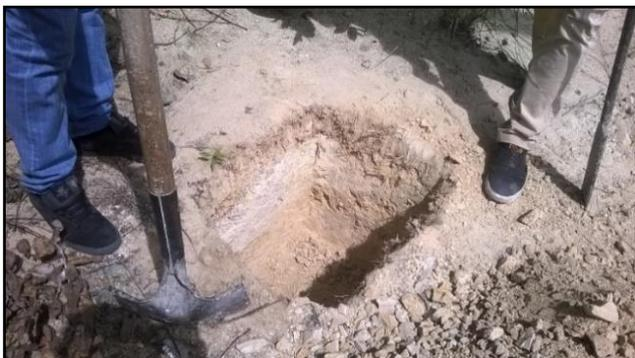
Figura 19. Fotografía de calicata en el talud "La Banda".
