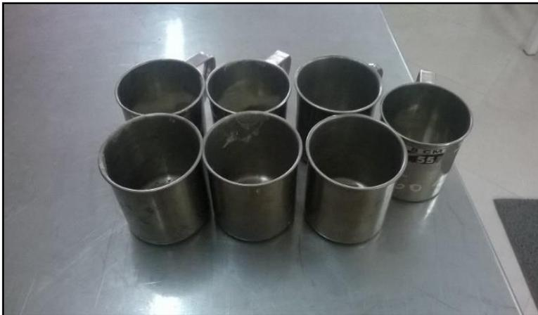
Figura 24. Fotografía de recipientes para determinar contenido de humedad.
