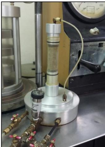
Figura 27. Fotografía probeta revestida con la membrana.
