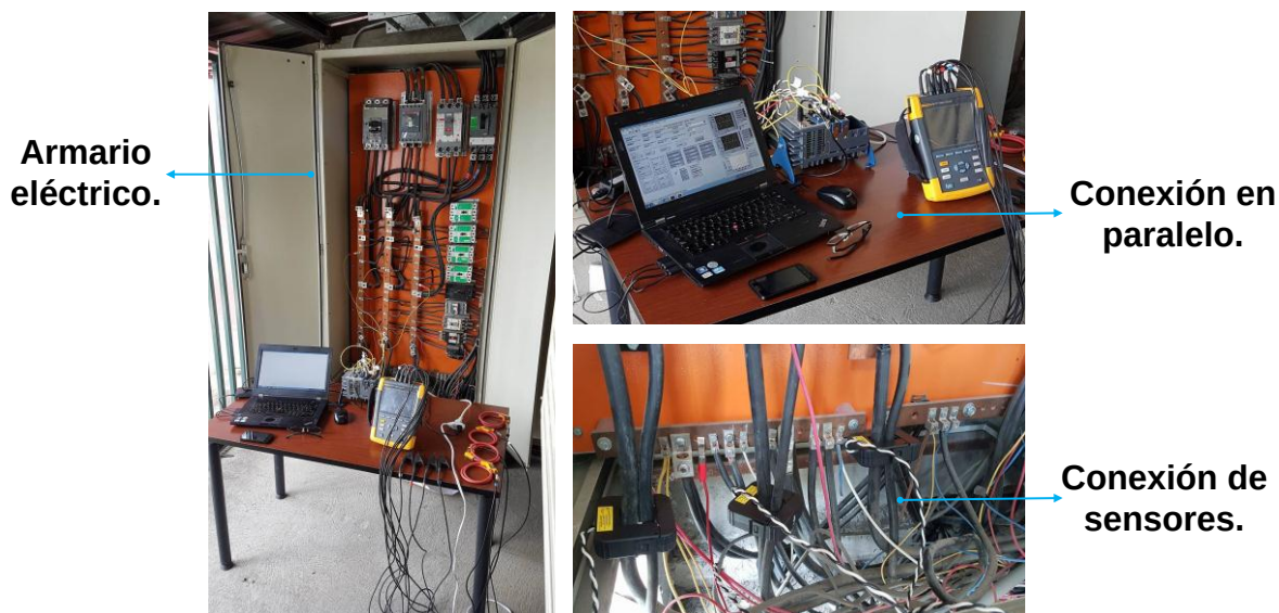
Fig 3. 5 Conexión en paralelo del Fluke 435 y el prototipo PQA. Fuente: Realizado por el autor.
