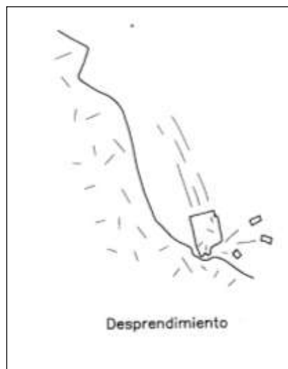
Figura 1: Mecanismo de desprendimiento.
