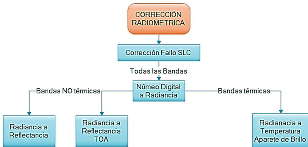
Figura 16: Corrección radiométrica
