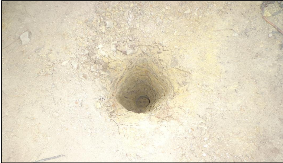
Figura 5. Perforación realizada con barrenos manuales.
