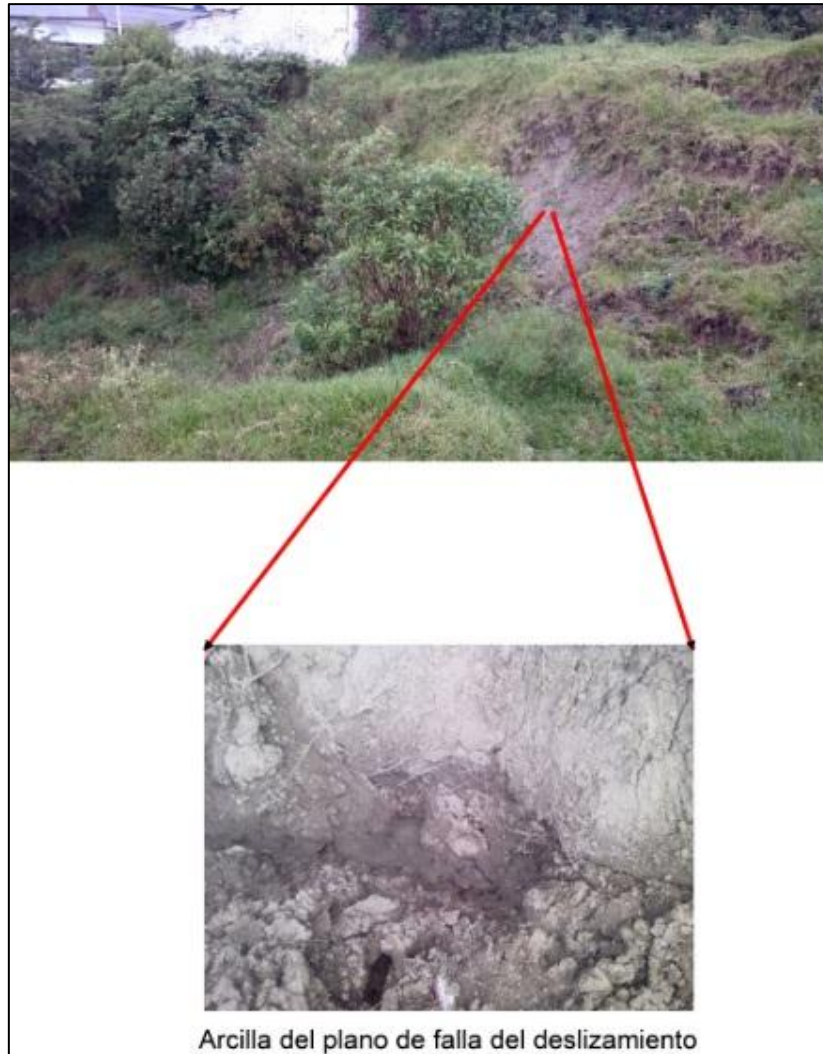
Figura 28. Paquete de arcilla en el plano de falla.
