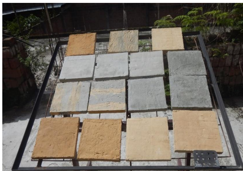
Imagen 56: Colocación de 3 placas por cada composite a 45^\circ respecto a la horizontal. Fuente: Autor
