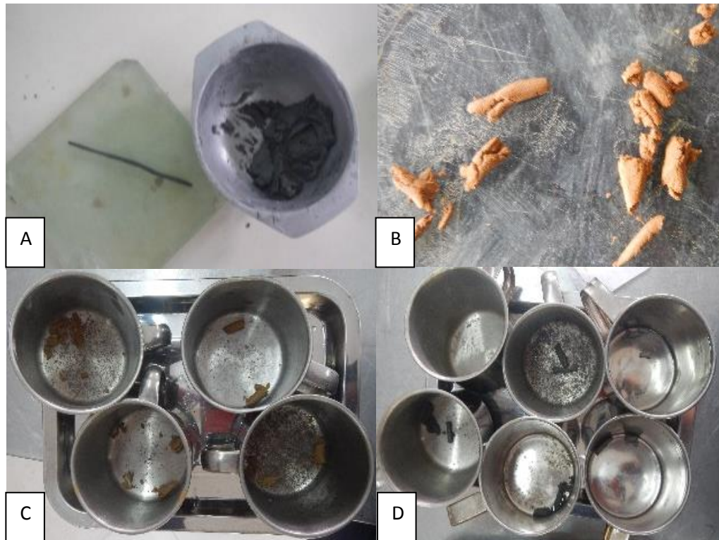
Imagen 48: (A, B)Cintillas de arcilla para determinar límite plástico, (C,D) toma y peso de muestras de arcillas M1 y M2
