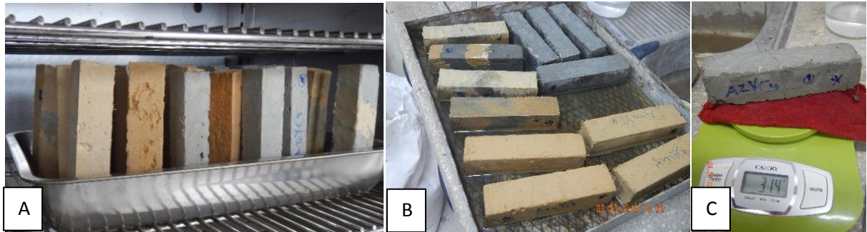
Imagen 55: Ensayo de capilaridad ,A) secado de probetas en horno a 70°C, (B) Sumergido de probetas a 0.5cm en agua ,(C) control de peso de las probetas con absorción de agua.
