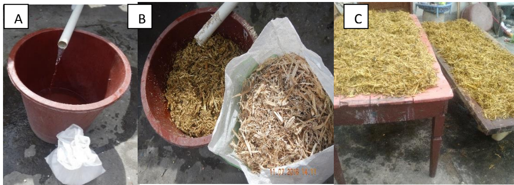
Imagen 75: Tratado al bagazo con cal, (A) cal disuelta en agua, (B) bagazo sumergido en agua con cal , (C) Secado de bagazo luego del tratamiento con cal.
