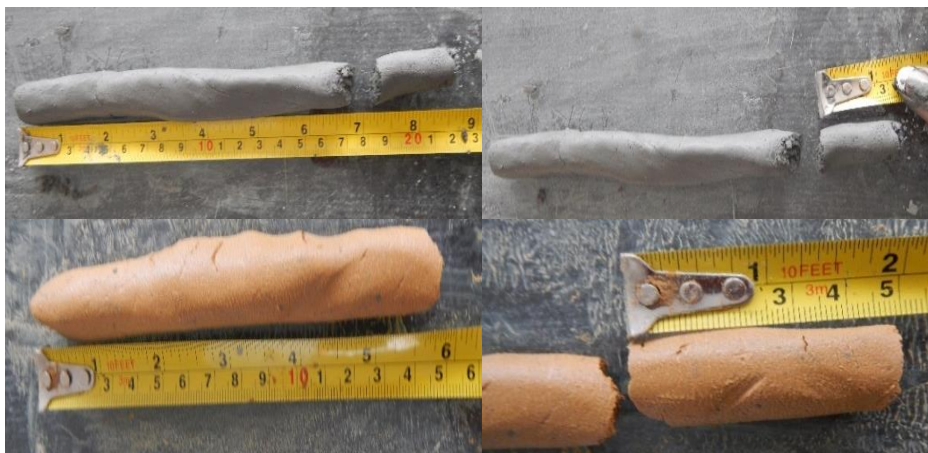
Imagen 43: ensayo de la cintilla con M1 Y M2 Fuente: Autor
