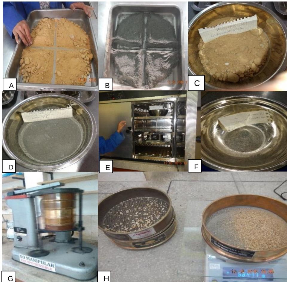
Imagen 50: Ensayo granulometría por lavado, (A,B) cuarteado para toma de muestras, Muestras en recipientes para ser secadas al horno (C,D), Muestras secadas al horno (E), muestra seca luego de haber pasado por el lavado M1 (F), Muestras pasando por el equipo tamizador(G), Peso del material retenido en cada tamiz( H)
