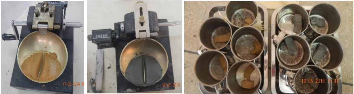
Imagen 45: Limite líquido en aparato casa grande. Fuente: autor
