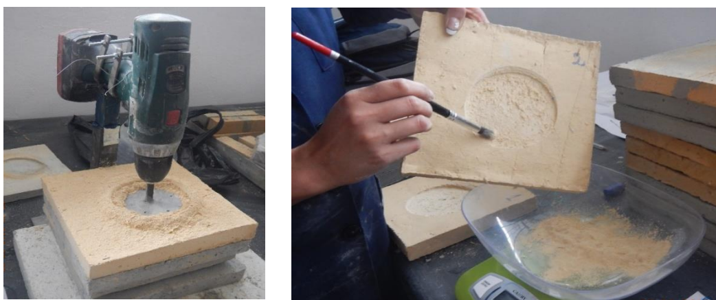
Imagen 68: Ejecución del ensayo y toma de peso del material desgastado Fuente: Autor
