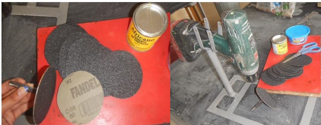
Imagen 67: Preparación de taladro y lija para ensayo de abrasión Fuente: Autor
