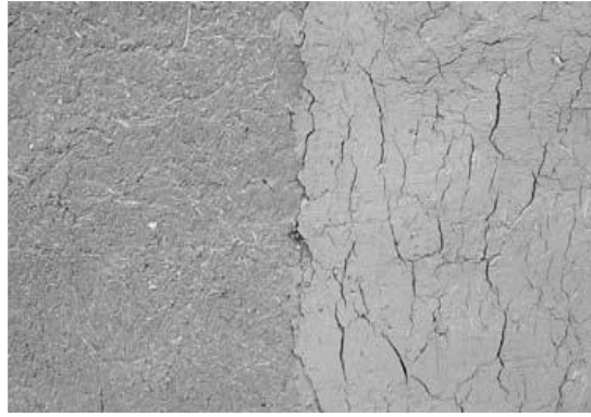
Imagen 25: Comparación entre la retracción de un revestimiento de barro con paja y sin paja.
