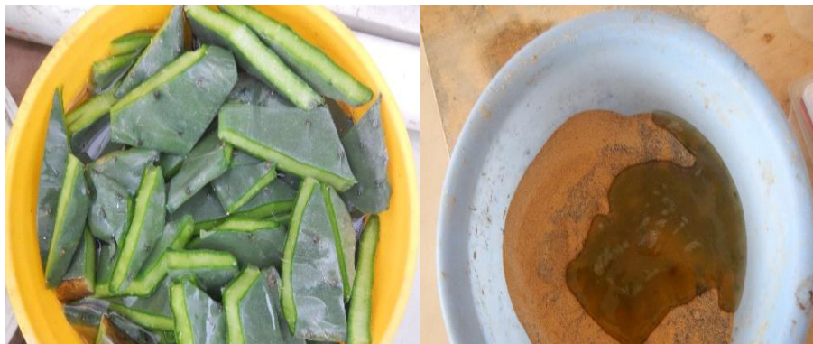
Imagen 31: (A) macerado de nopal, (B) mucílago de nopal y arcilla Fuente: autor
