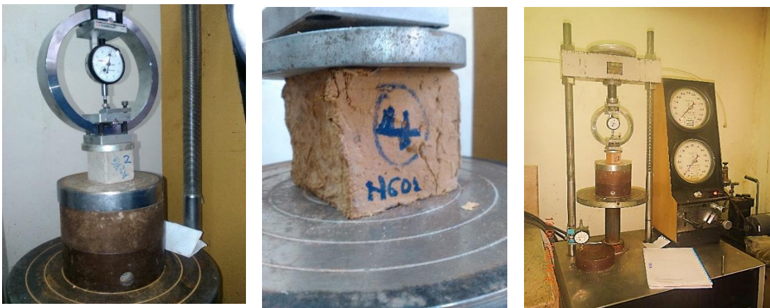
Imagen 66: Realización de ensayo de compresión en la máquina Versa Tester
