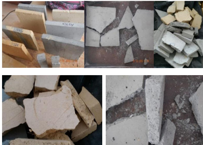
Imagen 97 Placas excluidas para ensayos posteriores CA1 , CAZ02 por su fragilidad.
