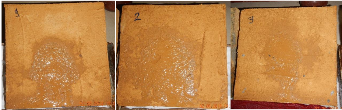
Imagen 54: Composite NGO2, ensayo de goteo, placas con menos erosión por agua Fuente: Autor
