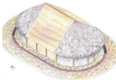
Figura 3.1 Representación artística de una axonometría formal de la vivienda típica shuar Fuente: "La vivienda shuar al Suroriente ecuatoriano". Lic. Iliana Herrera
