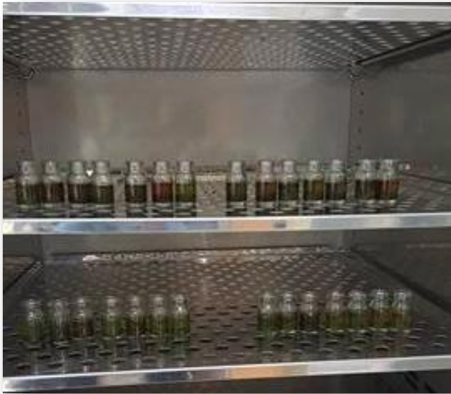
Figura 3. Muestra de Setaria sphacelata sometidas a incubación, para su respectiva separación de fases.
