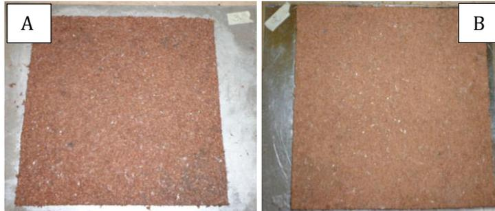
**Figura 45.** Tableros aplicados en paredes, A) Tablero No. 3 de 25x25x1 cm; B) Tablero No. 2 de 30x30x1 cm
