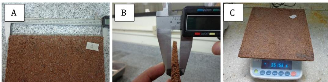
**Figura 38.** Probetas antes de ser sumergidos, A) Medida; B) Grosor; C) Peso
