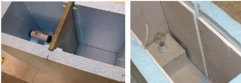
**Figura 23.** Equipo para el ensayo de reducción de la presión sonora, aislamiento térmico y atenuación al impacto. Para el aislamiento térmico se recubre el interior con placas de yeso laminado.
