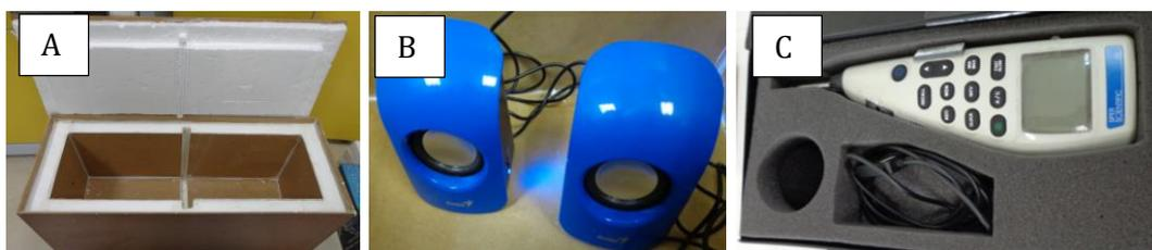
**Figura 36.** Equipos a utilizar, A) Caja acústica; B) Parlantes: SP-U115 genius; C) Sonómetro: 850013
