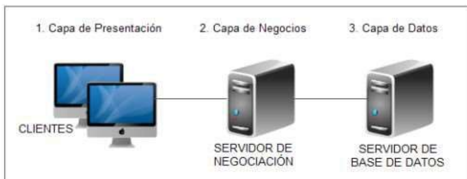
Figura 12: Arquitectura en tres capas Fuente: Basado en: https://goo.gl/ShMKIo Elaboración: (Paredes, 2011)
