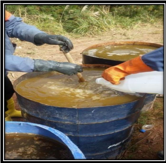
**Figura 14:** Clarificación de la misma utilizando Policloruro de Aluminio.
