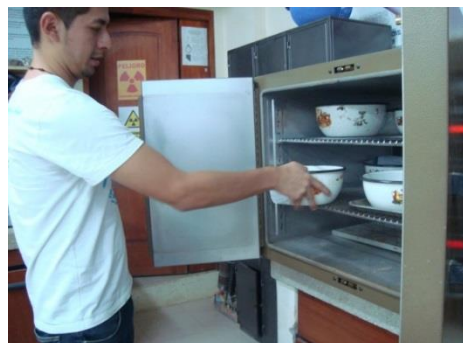
Secado del árido fino en el horno
