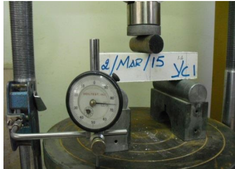
Probeta 16x4x4 inicio de ensayo
