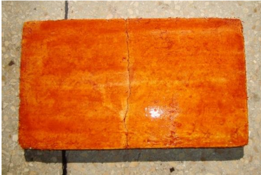
Pigmento natural aplicado en mortero de revestimiento
