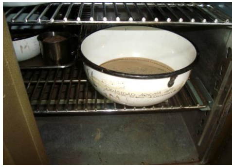
Árido fino al horno por 24h
