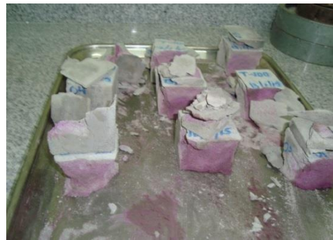
Determinación de la carbonatación (Prueba de la fenolftaleína)
