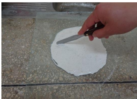
Prueba de fraguado
