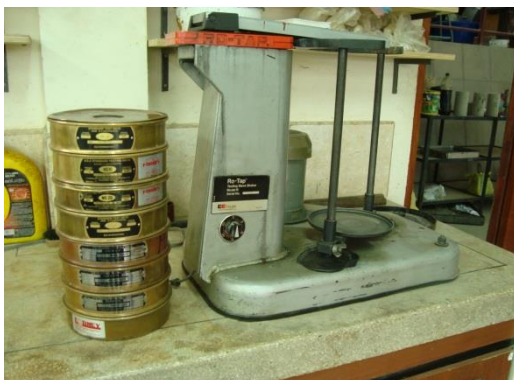
Ro – tap (equipo tamizador), clasificación del árido
