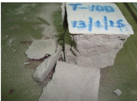
Probeta sometida a compresión
