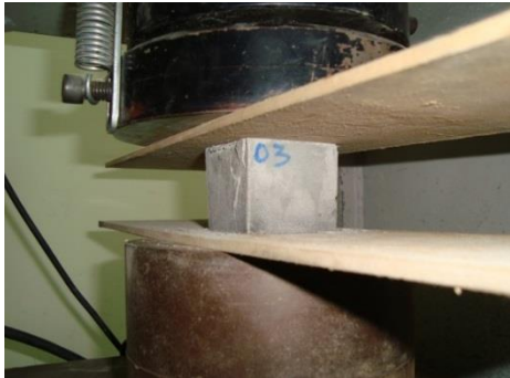
Ensayo a compresión
