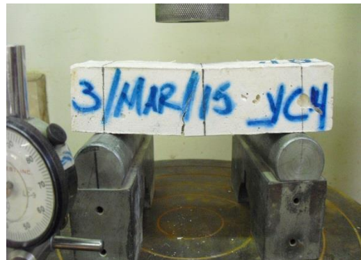
Resultado del ensayo a flexión
