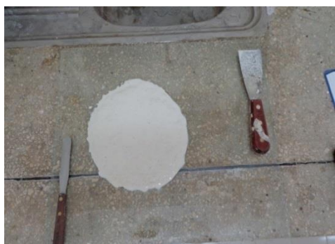
Colocación de la pasta en sup. de vidrio
