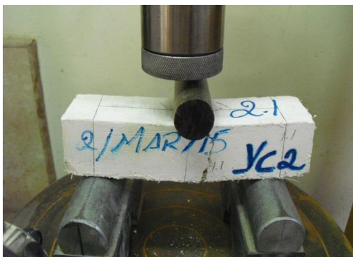
Probeta fisurada ensayada
