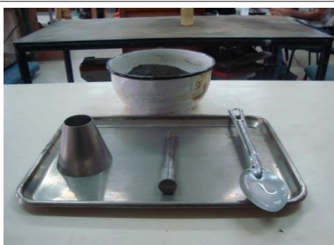
Árido fino en el cono ABRAMS
