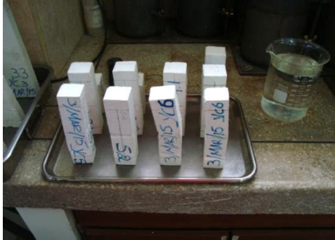
Probetas 16x4x4 ensayo capilaridad
