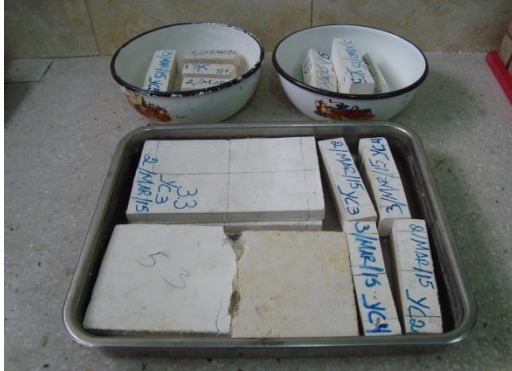
Probetas para ensayo de porosidad
