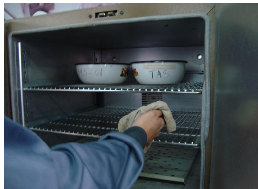
Secado del árido en el horno
