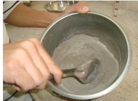
Mezcla de agregado y aglomerante
