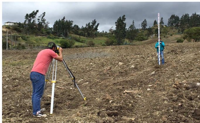
Figura 4. Ilustración del equipo de nivelación Geomax ZDL 700 Fuente y Elaboración: El autor
