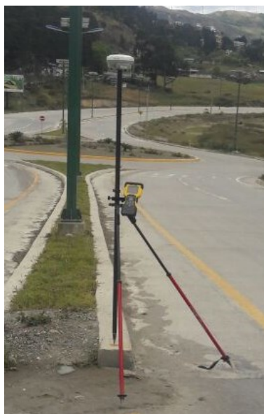
Figura 3. Ilustración del equipo GPS (Rover) marca Trimble R6
