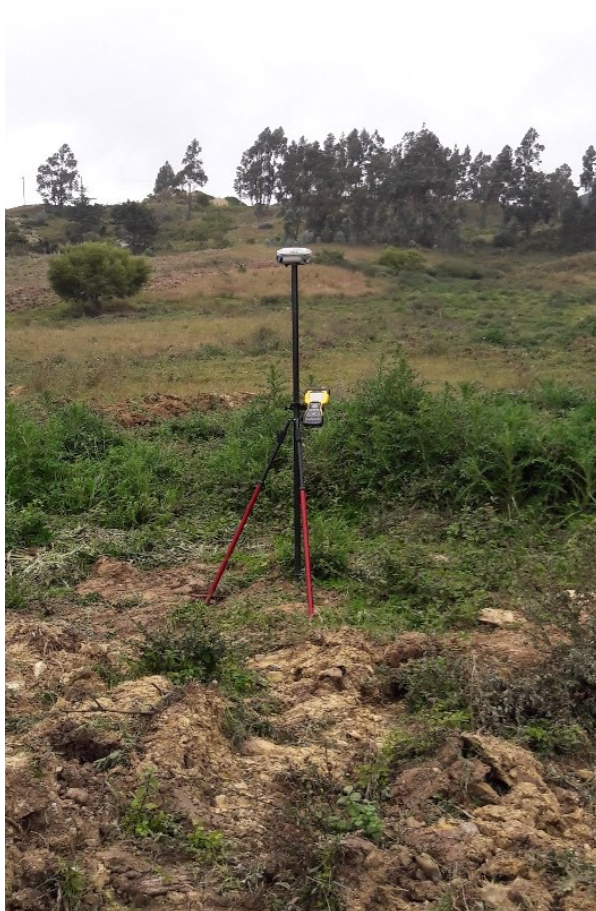
Figura 11: Procedimiento del levantamiento con el equipo GPS Timble R6 Fuente y Elaboración: El Autor
