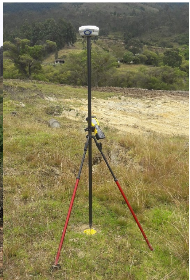
Figura 11: Procedimiento del levantamiento con el equipo GPS Timble R6 Fuente y Elaboración: El Autor
