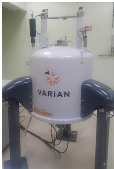
**Figura 12.** Equipo de Resonancia Magnética Nuclear
