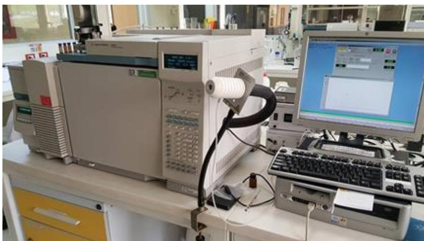
**Figura 11.** Cromatógrafo de Gases acoplado a Espectrometría de Masas
