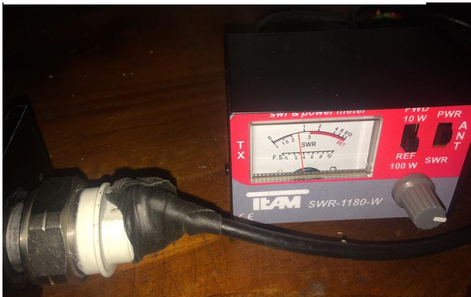
Figura 60. Medición de la potencia recibida en el aplicativo de mobiliario.
