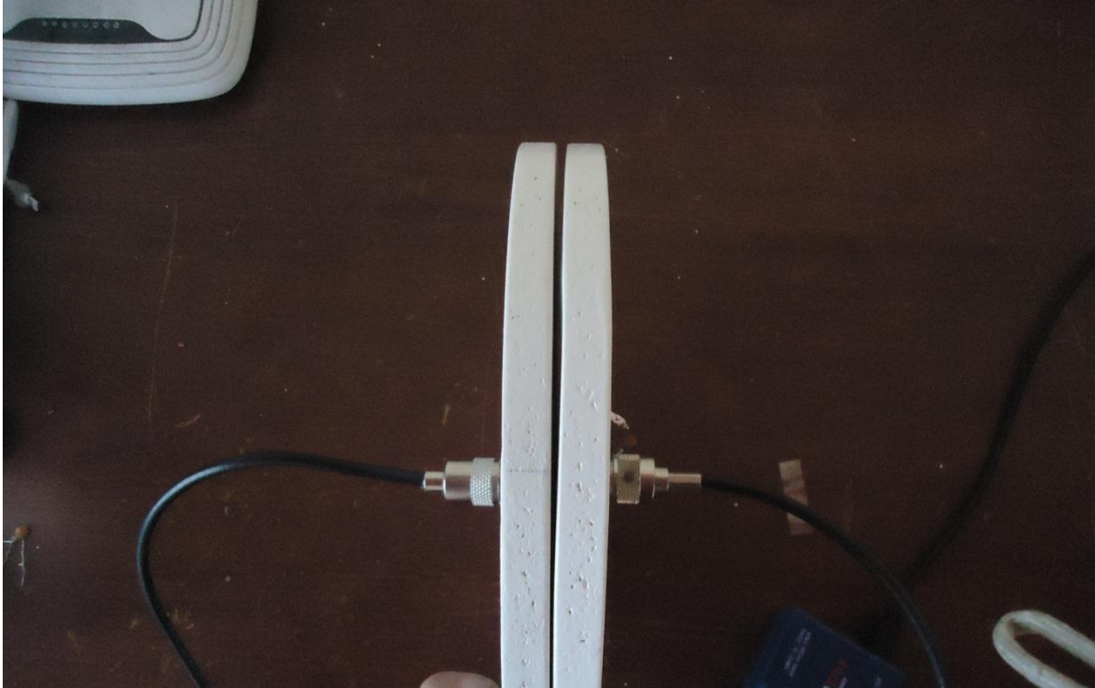
Figura 66. Medición de antenas para interiores a una distancia de 0cm
