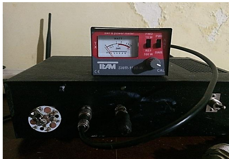
Figura 48. Medición del ROE a través de una carga de 50\Omega
