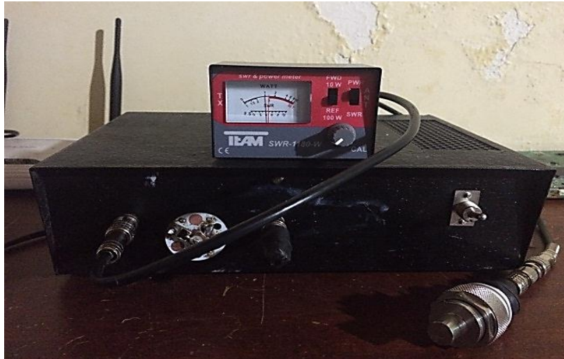
Figura 49. Medición de la potencia de salida del amplificador. Fuente: Autores Elaboración: AWR2009
