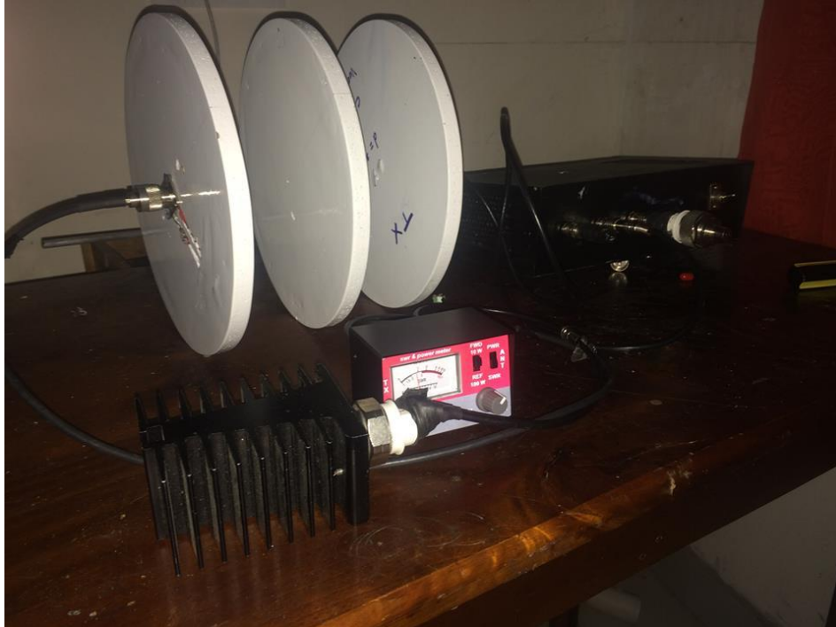
Figura 59. Medición de la potencia recibida en el aplicativo de iluminación.
