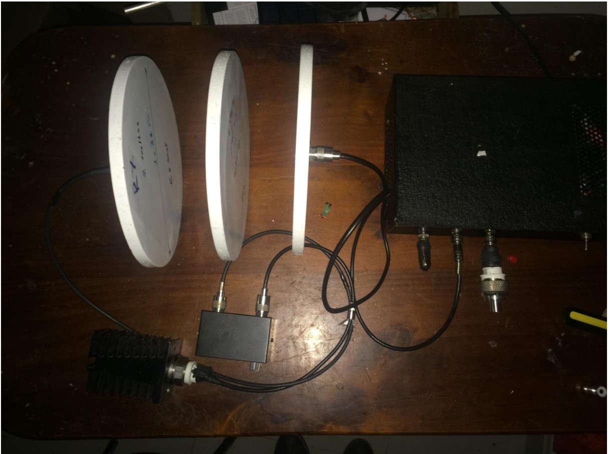
Figura 68. Medición de la transmisión de energía a 26 cm utilizando repetido pasivo. Fuente: Autores Elaboración: Autores
