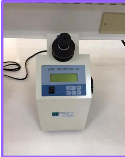
Figura 5: Refractómetro ABBE Fuente: La Autora
