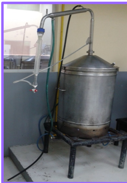
Figura 4: Equipo de destilación Fuente: La Autora
