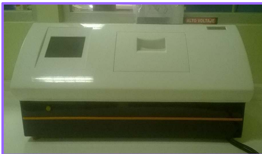
Figura 6: Polarímetro digital Fuente: La Autora
