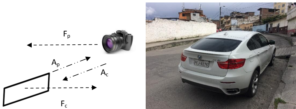
Figura 26. Imagen de una placa vehicular con distorsión perspectiva. Fuente: Autor. Elaboración: Autor.
