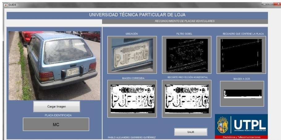
Figura 52. Error específico por placa deteriorada.
