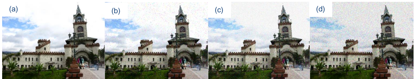
Figura 4. Tipos de ruido en una imagen. (a) imagen original, (b) sal y pimienta, (c) gaussiano, (d) multiplicativo.
