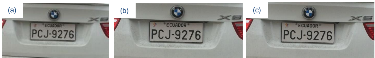
Figura 18. Imágenes de una placa vehicular de diferente tamaño al aplicar un acercamiento equitativo. (a) 0,3 MP, (b) 3 MP, (c) 8 MP.
