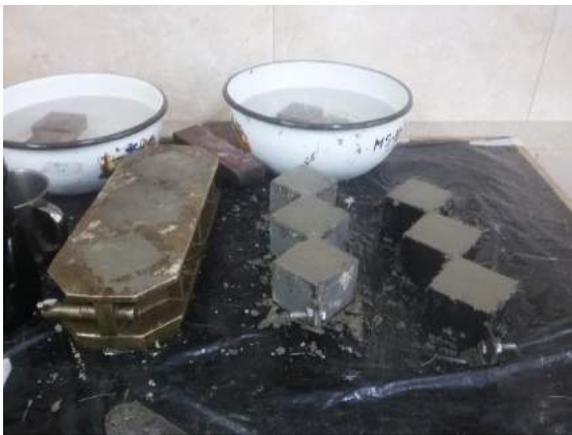
Ilustración 389. Especímenes en sus respectivos encofrados.
