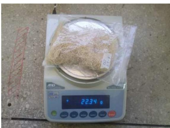
Ilustración 364. Pesaje de la fibra en la balanza eléctrica modelo FX-5000i.
