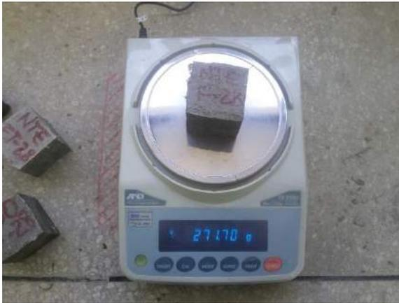
Ilustración 101. Pesaje del espécimen en la balanza eléctrica modelo FX-5000i.
