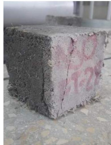
Ilustración 225. Formación de fisuras en el espécimen.
