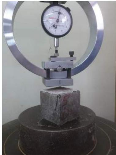
Ilustración 158-159. Formación de fisuras mientras se le aplicó la carga máxima dentro de la máquina de ensayo.
