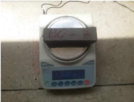
Ilustración 316. Especimen M-ISO 7 seco listo para ser ensayado.
