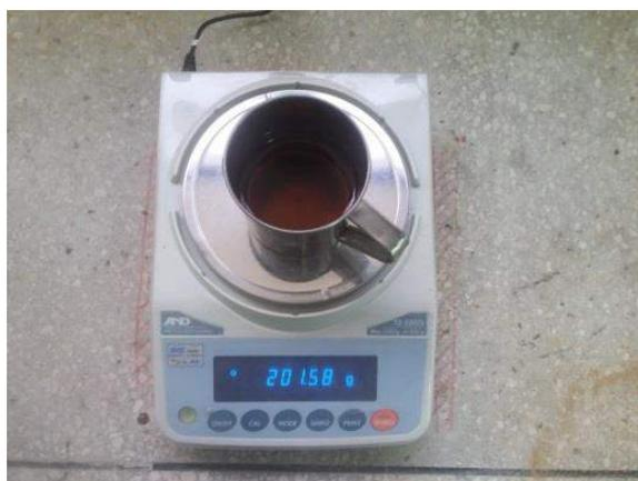
Ilustración 202. Pesaje del agua + aditivo en la balanza eléctrica modelo FX-5000i.
