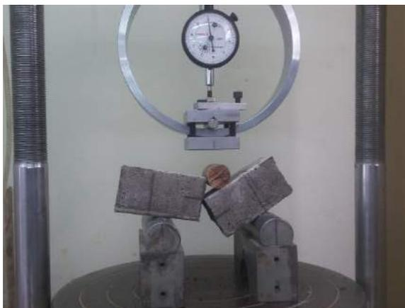
Ilustración 323. Fisuración del espécimen dentro de la máquina triaxial.
