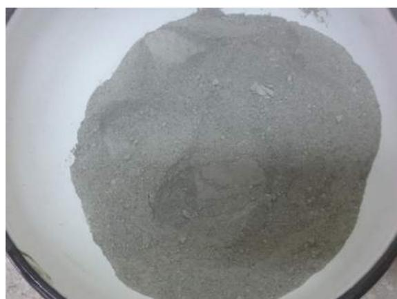
Ilustración 82. Mezcla manual entre cemento y árido fino.
