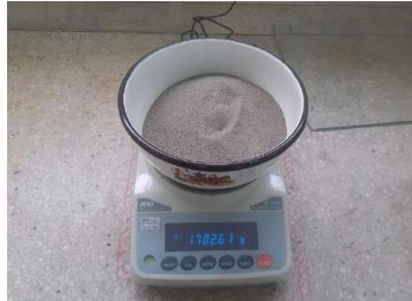
Ilustración 256. Pesaje del árido fino en la balanza eléctrica modelo FX-5000i.
