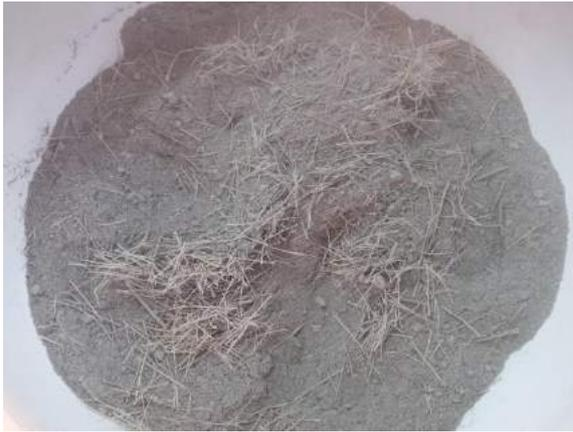
Ilustración 203. Mezcla manual entre todos los componentes; cemento, árido fino y fibra.
