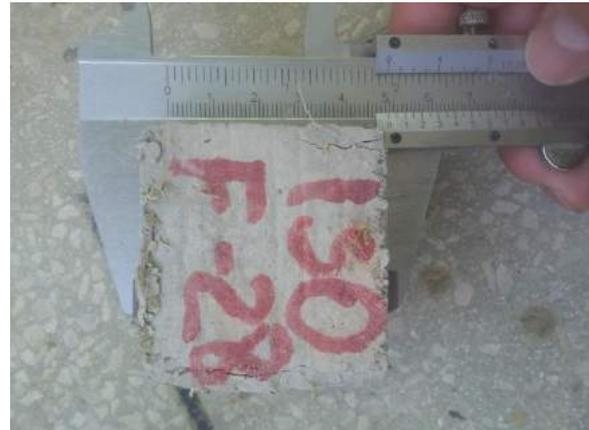
Ilustración 192. Medición de las aristas del espécimen a evaluar.
