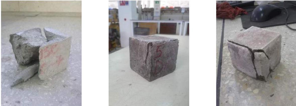
Ilustración 167. Fisuración especímenes M-ISO 7, M-ISO 14 y M-ISO 28 respectivamente.
