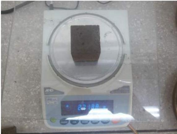
Ilustración 65. Pesaje del espécimen en la balanza eléctrica modelo FX-5000i.
