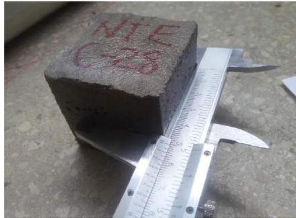
Ilustración 72. Medición de las aristas del espécimen a evaluar.
