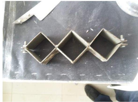
Ilustración 48. Molde fabricado de acuerdo a la NTE INEN 488 (2009).
