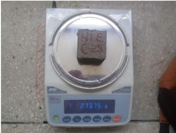
Ilustración 71. Pesaje del espécimen en la balanza eléctrica modelo FX-5000i.
