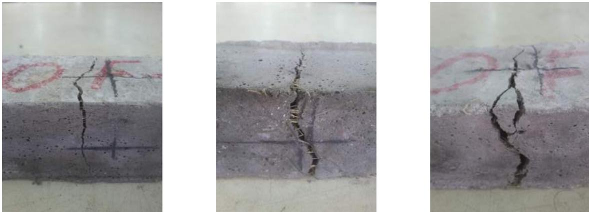
Ilustración 360. Fisuración especímenes M-ISO 7, M-ISO 14 y M-ISO 28 respectivamente.
