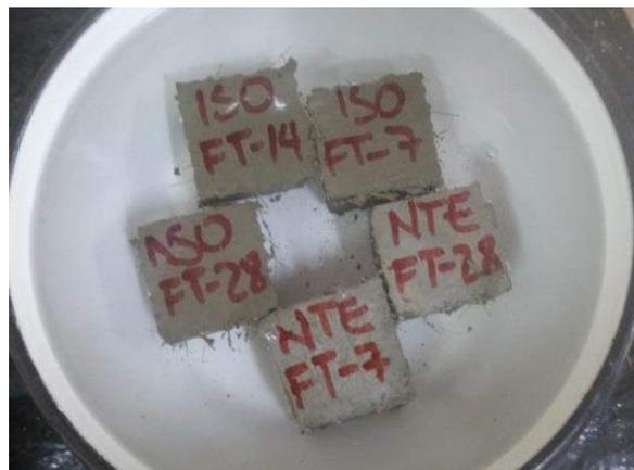
Ilustración 118. Especímenes sumergidos completamente en agua hasta el día de ser ensayados.
