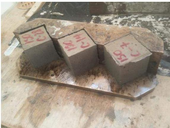
Ilustración 147. Desencofrado de especímenes.
