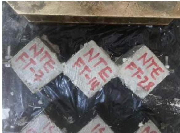
Ilustración 116. Marcaje de los especímenes para identificarlos al momento de ensayarlos.
