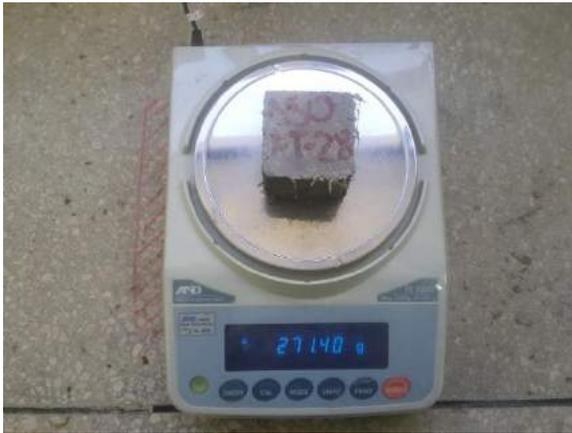
Ilustración 221. Pesaje del espécimen en la balanza eléctrica modelo FX-5000i.
