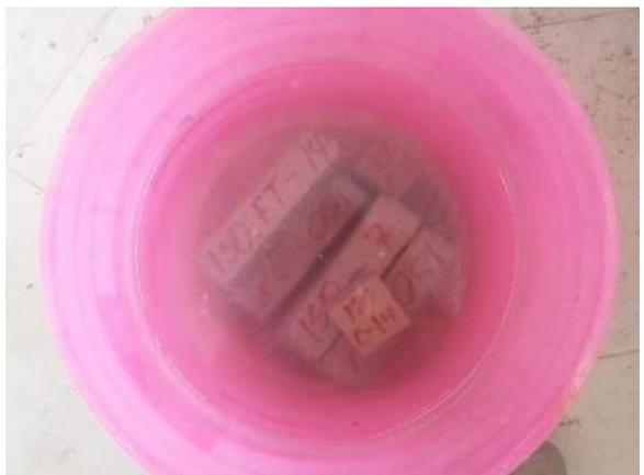
Ilustración 315. Especímenes sumergidos completamente en agua hasta el día de ser ensayados.
