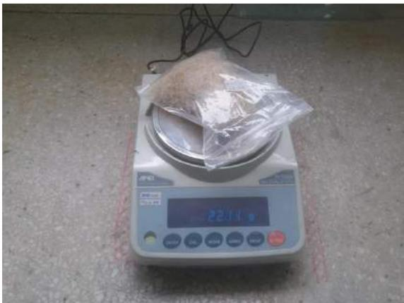
Ilustración 284. Pesaje de la fibra en la balanza eléctrica modelo FX-5000i.
