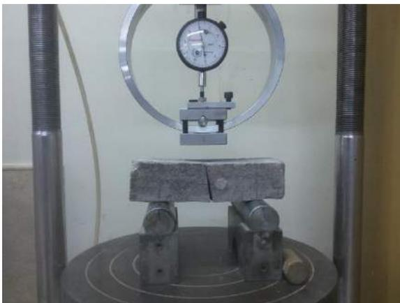
Ilustración 250-251. Fisuración y ruptura total del espécimen M-NTE 28 dentro de la máquina triaxial.
