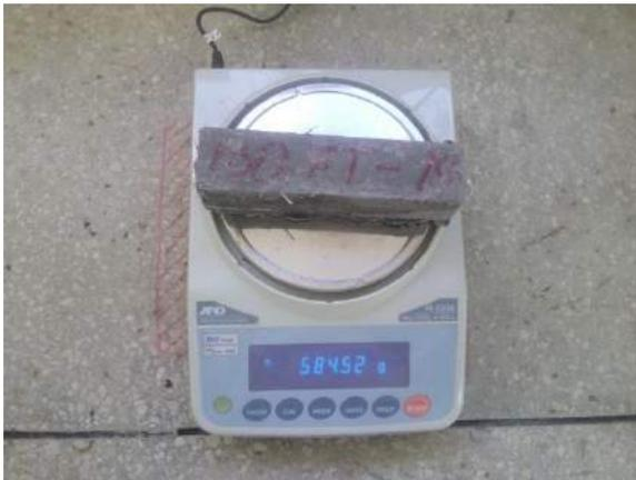
Ilustración 377. Especimen M-ISO-FT14 seco listo para ser ensayado.
