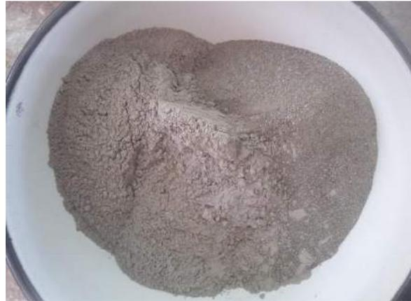
Ilustración 311. Mezcla manual entre cemento y árido fino.
