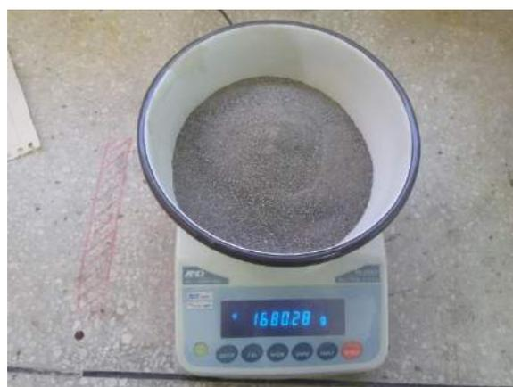
Ilustración 363. Pesaje del árido fino en la balanza eléctrica modelo FX-5000i.
