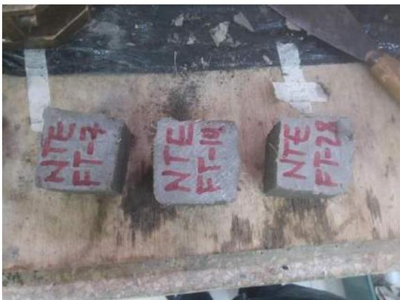
Ilustración 117. Desencofrar los especímenes del recipiente.
