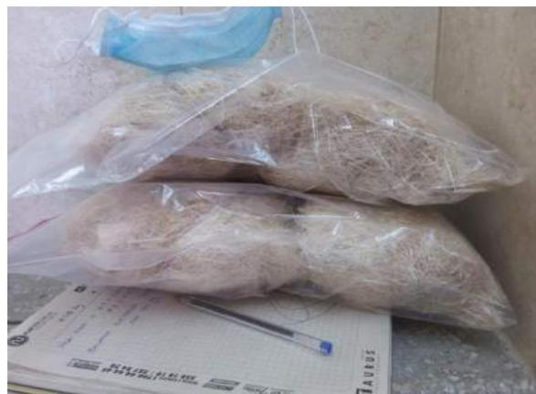
Ilustración 42. Almacenamiento de la fibra ya con tratamiento hidrófobo.
