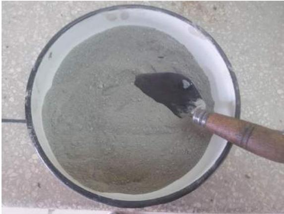
Ilustración 232. Mezcla manual entre cemento y árido fino.
