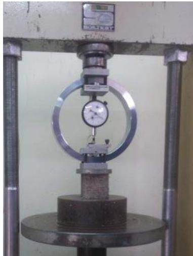
Ilustración 97-98. Calibración de la máquina de ensayo y colocación del espécimen en la misma.
