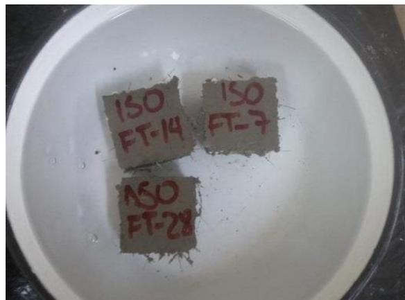
Ilustración 208. Especímenes sumergidos completamente en agua hasta el día de ser ensayados.
