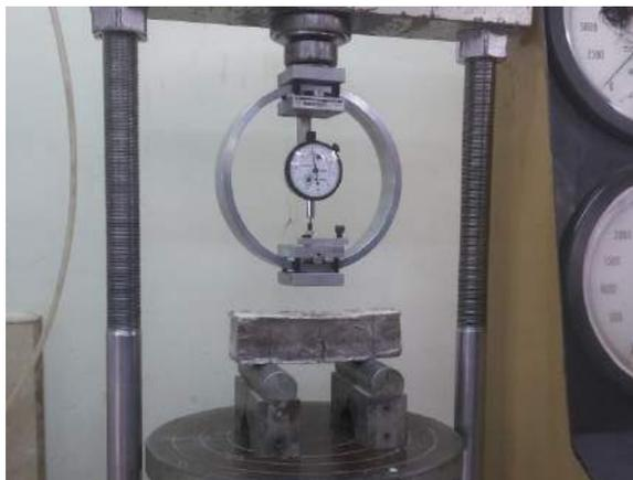
Ilustración 272-273. Sometimiento y fisuración del espécimen M-NTE-F14 dentro de la máquina triaxial.
