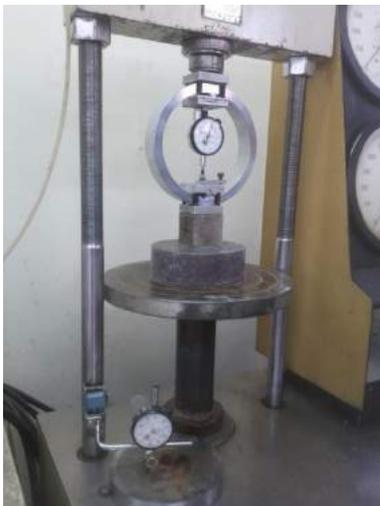
Ilustración 61-62. Calibración de la máquina de ensayo y colocación del espécimen en la misma.
