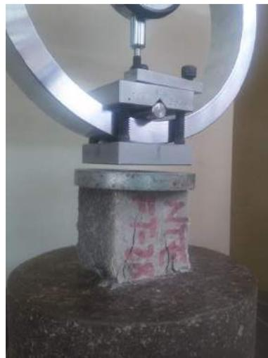
Ilustración 134-135. Formación de fisuras mientras se le aplicó la carga máxima dentro de la máquina de ensayo.
