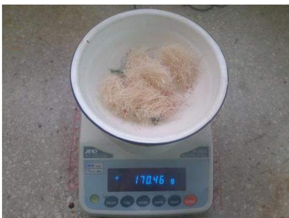
Ilustración 201. Pesaje de la fibra en la balanza eléctrica modelo FX-5000i.
