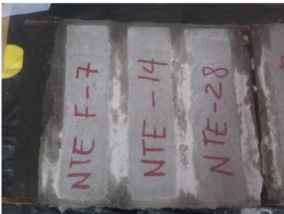
Ilustración 236. Marcaje de los especímenes para identificarlos al momento de ensayarlos.
