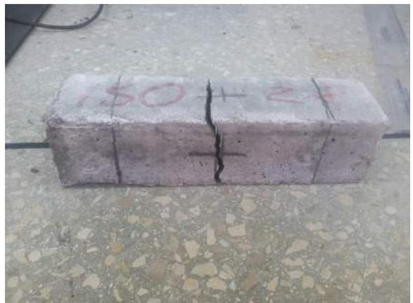
Ilustración 329. Ruptura total del espécimen M-NTE 14.
