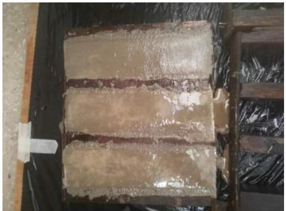
Ilustración 313. Moldeo final de los especímenes M-ISO a flexión.
