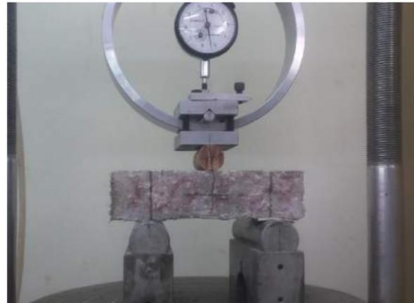
Ilustración 356. Sometimiento del espécimen a carga dentro de la máquina de ensayo.
