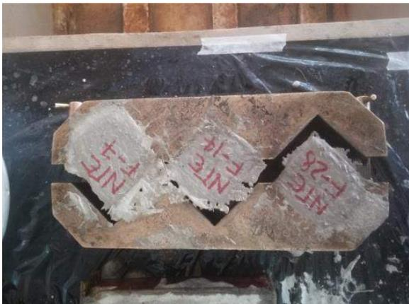
Ilustración 87. Desencofrar los especímenes del recipiente.
