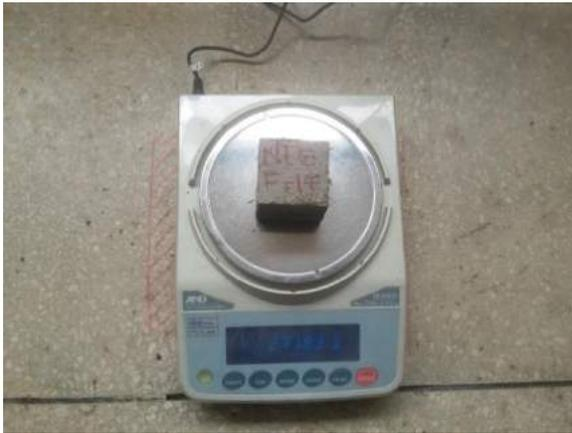
Ilustración 95. Pesaje del espécimen en la balanza eléctrica modelo FX-5000i.
