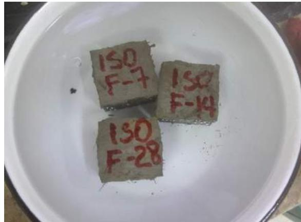
Ilustración 178. Especímenes sumergidos completamente en agua hasta el día de ser ensayados.
