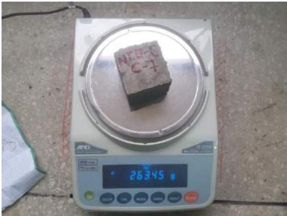
Ilustración 59. Pesaje del espécimen en la balanza eléctrica modelo FX-5000i.
