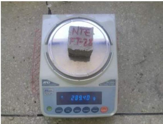
Ilustración 131. Pesaje del espécimen en la balanza eléctrica modelo FX-5000i.
