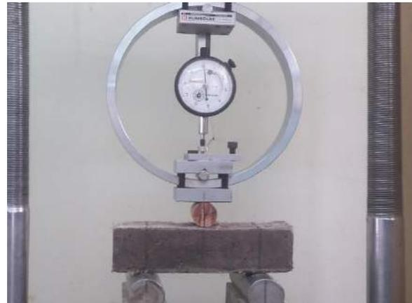
Ilustración 350. Sometimiento del espécimen a carga dentro de la máquina de ensayo.
