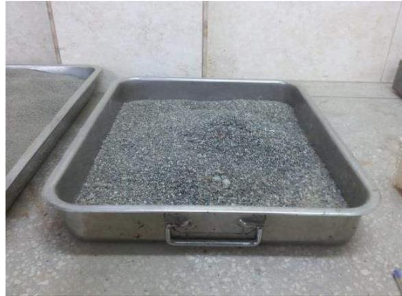
Ilustración 25. Árido que no pasa la malla del tamiz No. 16.
