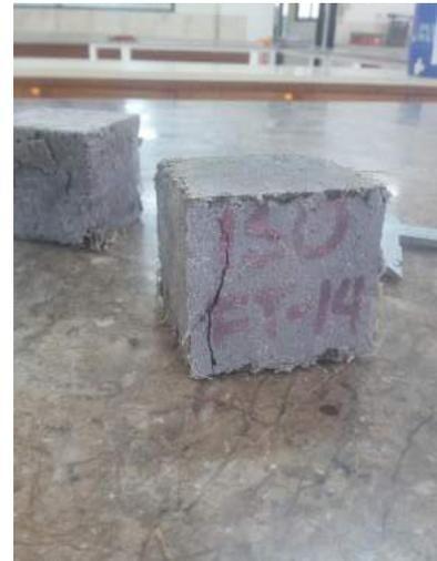
Ilustración 219. Formación de fisuras en el espécimen.
