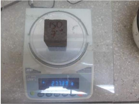
Ilustración 149. Pesaje del espécimen en la balanza eléctrica modelo FX-5000i.
