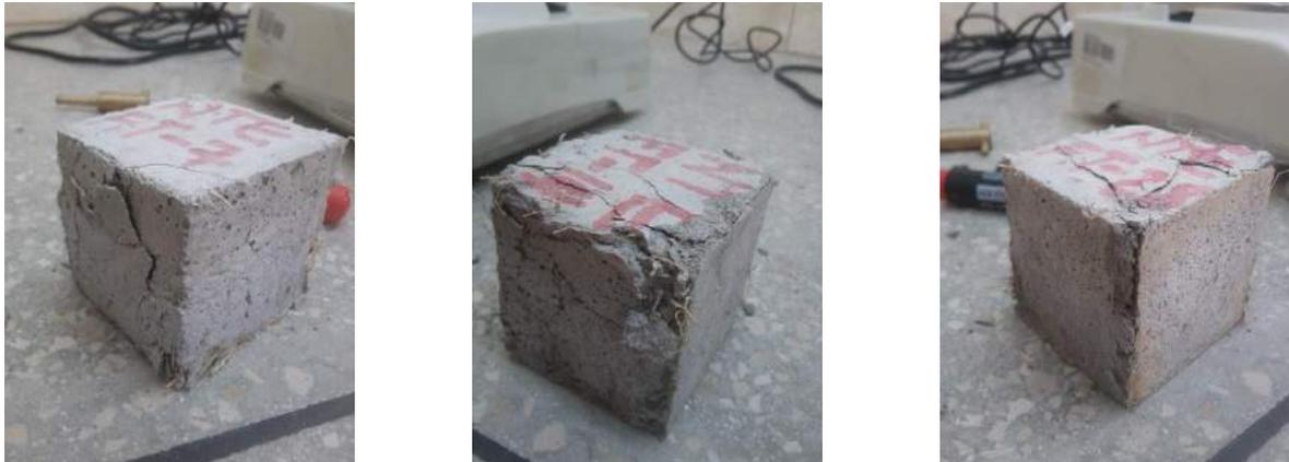
Ilustración 137. Fisuración especímenes M-NTE-FT7, M-NTE-FT14 y M-NTE-FT28.
