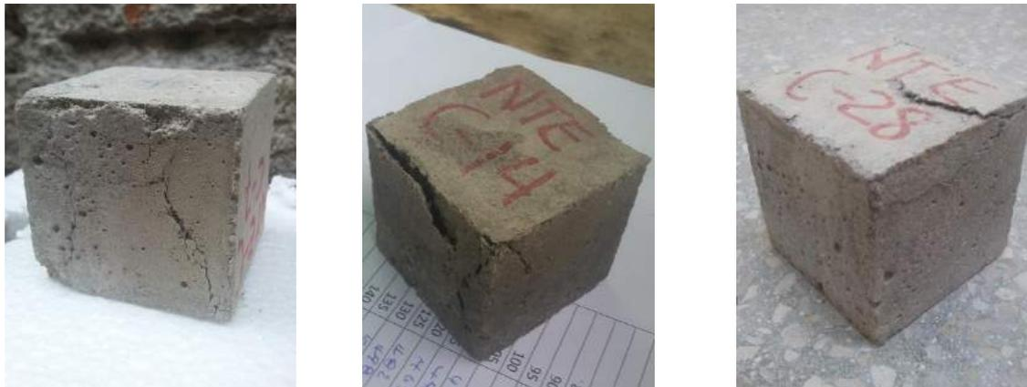
Ilustración 77. Fisuración de los espécimen M-NTE 7, M-NTE 14 y M-NTE 28 respectivamente.
