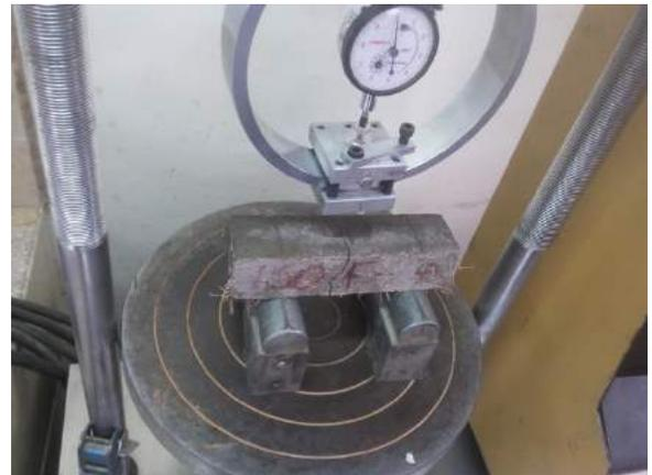
Ilustración 346-347. Fisuración del espécimen M-ISO-F7 dentro de la máquina triaxial.
