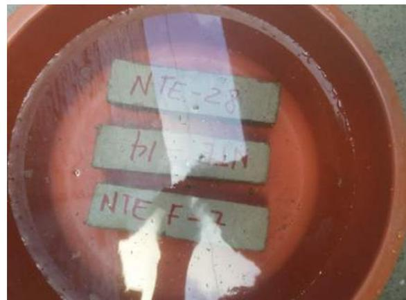
Ilustración 237. Especímenes sumergidos completamente en agua hasta el día de ser ensayados.
