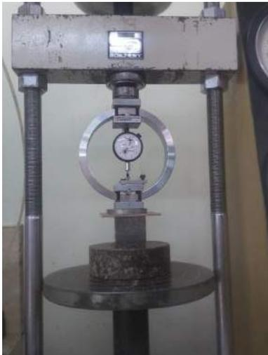
Ilustración 121. Aplicación de carga sobre el M-NTE-FT7.
