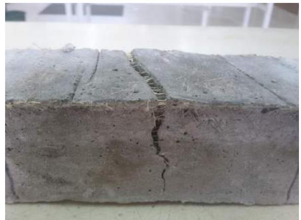
Ilustración 303-304. Sometimiento y fisuración del espécimen M-NTE-FT28 dentro de la máquina triaxial.
