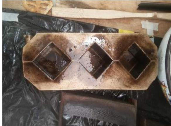
Ilustración 144. Encofrado estándar para morteros.
