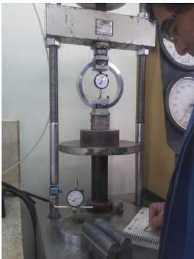
Ilustración 127. Aplicación de carga sobre el M-NTE-FT14.
