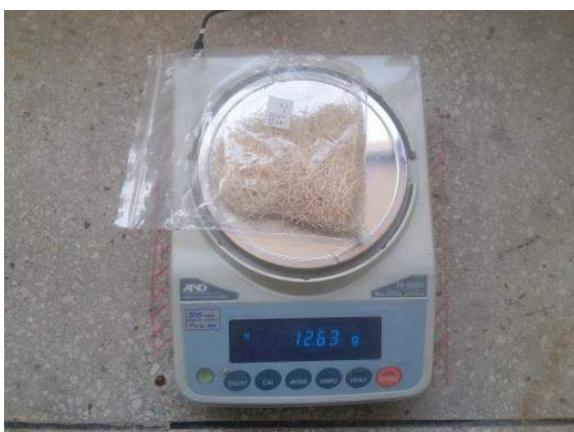
Ilustración 111. Pesaje de la fibra en la balanza eléctrica modelo FX-5000i.
