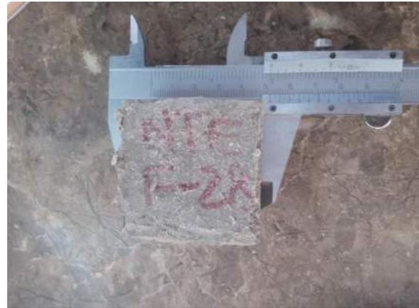
Ilustración 102. Medición de las aristas del espécimen a evaluar.
