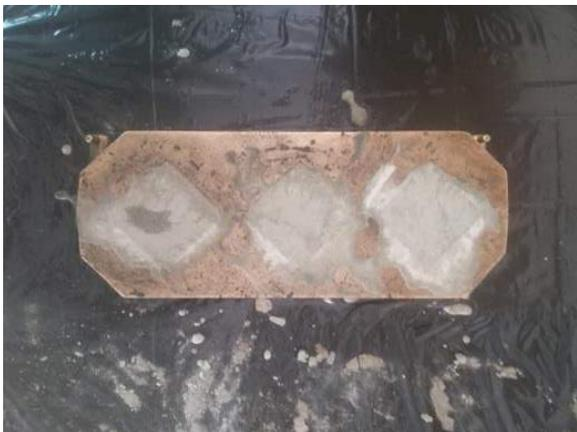
Ilustración 55. Moldeo final de las muestras durante 24 horas.
