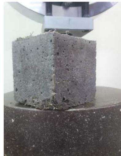
Ilustración 183. Formación de fisuras en el espécimen.
