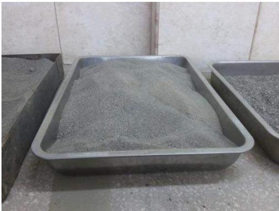
Ilustración 26. Árido luego de realizarse el tamizaje.
