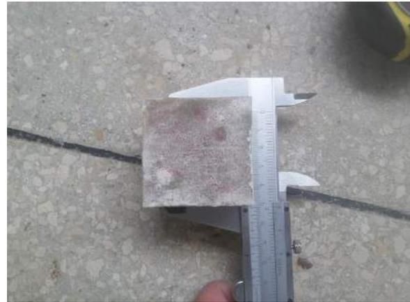
Ilustración 162. Medición de las aristas del espécimen a evaluar.
