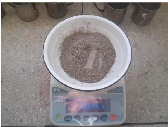
Ilustración 139. Pesaje del cemento en la balanza eléctrica modelo FX-5000i.
