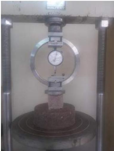
Ilustración 103. Aplicación de carga sobre el M-NTE-F28.
