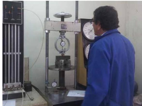
Ilustración 293. Sometimiento del espécimen a carga dentro de la máquina de ensayo.
