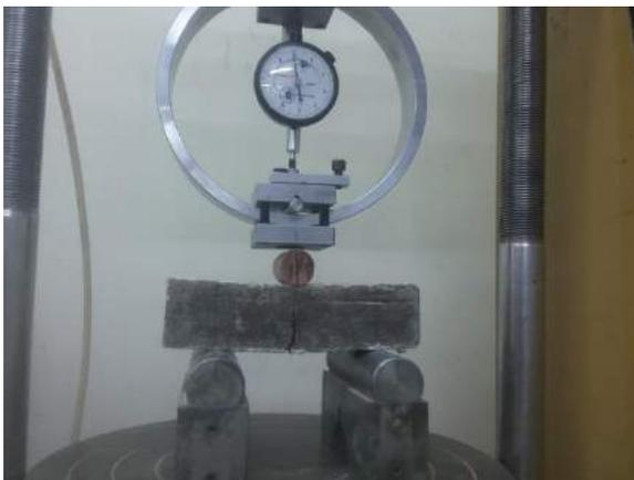
Ilustración 277-278. Sometimiento y fisuración del espécimen M-NTE-F28 dentro de la máquina triaxial.
