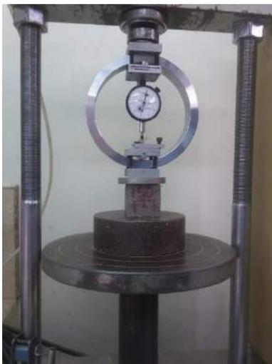
Ilustración 181-182. Aplicación de carga sobre el M-ISO-F7.
