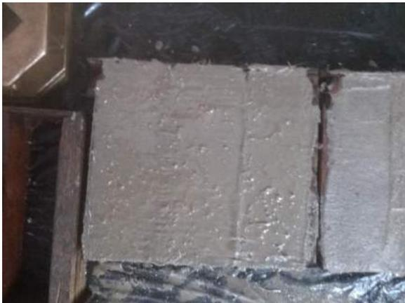
Ilustración 290. Moldeo final de los especímenes.
