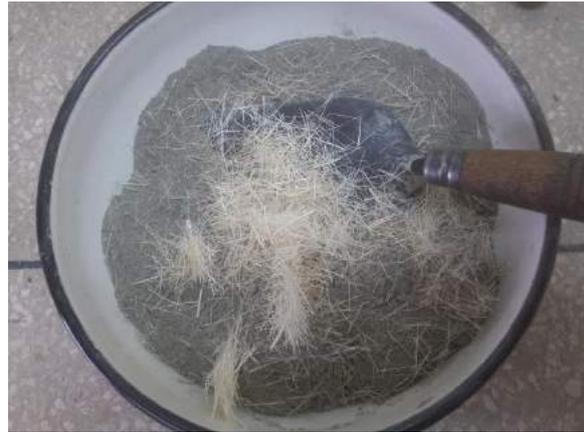
Ilustración 287. Incorporación de fibra en la mezcla.
