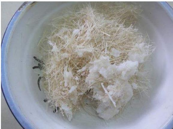
Ilustración 39. Formación de grumos por la mezcla entre la parafina y la fibra.
