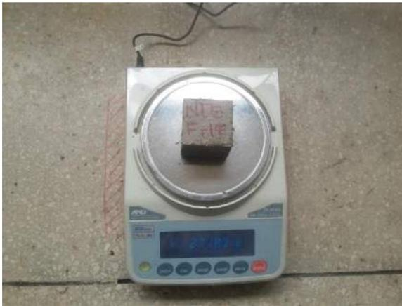
Ilustración 89. Pesaje del espécimen en la balanza eléctrica modelo FX-5000i.
