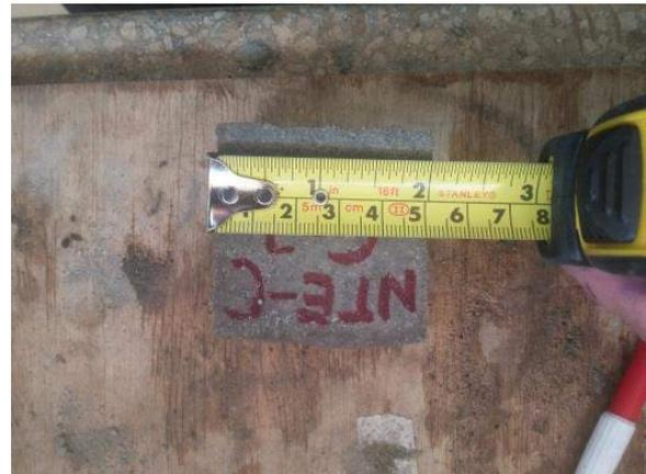
Ilustración 60. Medición de las aristas del espécimen a evaluar.
