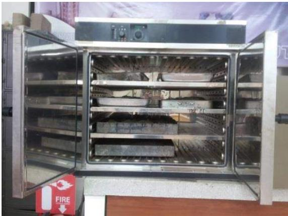
Ilustración 22. Vista interna del horno empleado para el secado de la arena.
