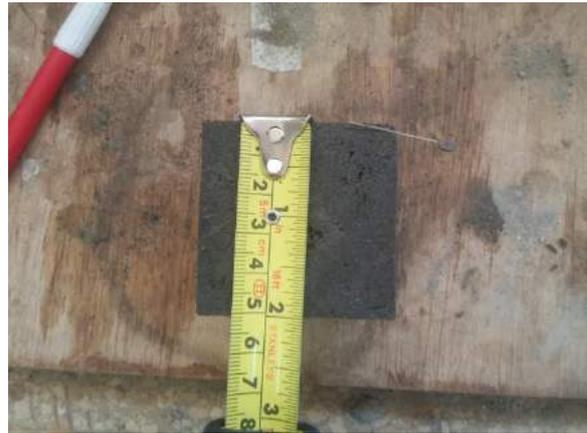
Ilustración 126. Medición de las aristas del espécimen a evaluar.
