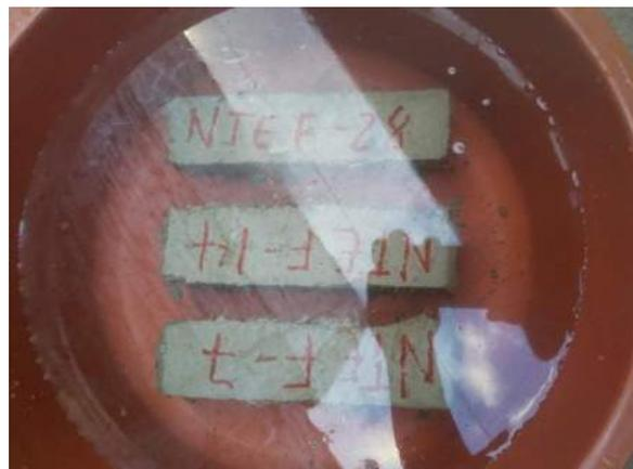
Ilustración 264. Especímenes sumergidos completamente en agua hasta el día de ser ensayados.
