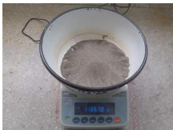
Ilustración 80. Pesaje del árido fino en la balanza eléctrica modelo FX-5000i.
