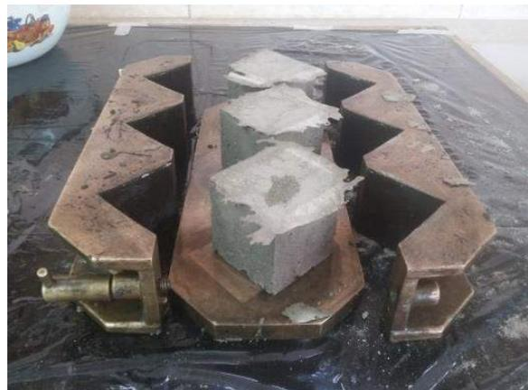
Ilustración 56. Desencofrar los especímenes del recipiente.
