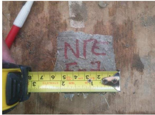
Ilustración 90. Medición de las aristas del espécimen a evaluar.
