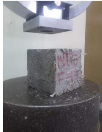
Ilustración 99. Formación de fisuras en el M-NTE-F14.
