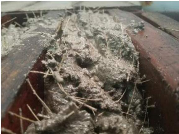
Ilustración 368. Colocación de la mezcla en sus respectivos moldes.
