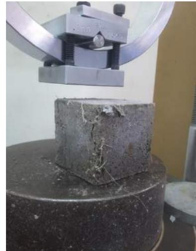
Ilustración 213. Formación de fisuras en el espécimen.
