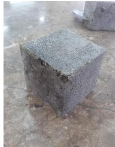
Ilustración 189. Formación de fisuras en el espécimen.
