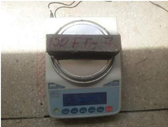
Ilustración 372. Espécimen M-ISO-F7 seco listo para ser ensayado.
