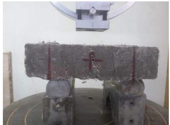
Ilustración 267-268. Sometimiento y fisuración del espécimen M-NTE-F7 dentro de la máquina triaxial.
