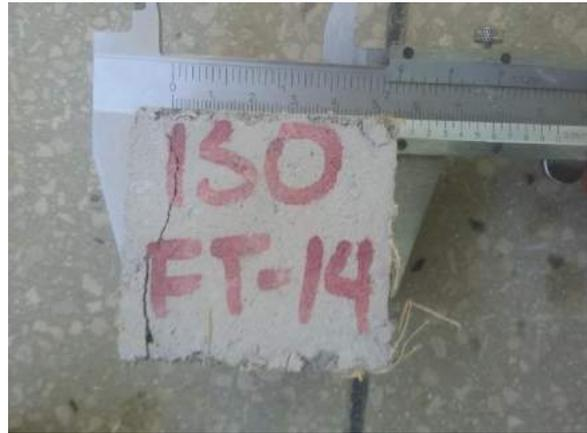
Ilustración 216. Medición de las aristas del espécimen a evaluar.
