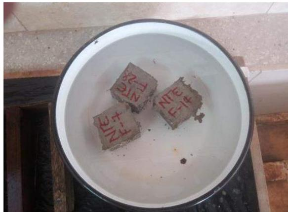
Ilustración 88. Especímenes sumergidos completamente en agua hasta el día de ser ensayados.
