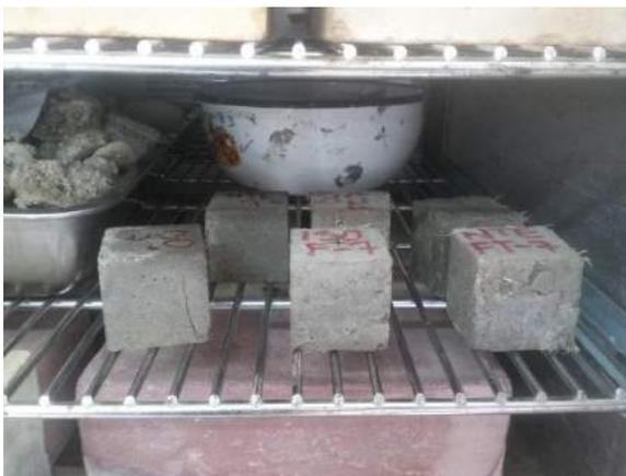
Ilustración 391. Especímenes colocados dentro del horno durante 24 horas.
