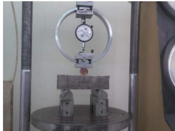
Ilustración 322. Sometimiento del espécimen a carga dentro de la máquina de ensayo.
