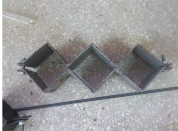
Ilustración 114. Encofrados dimensionados de acuerdo a la NTE INEN 488 (2009).
