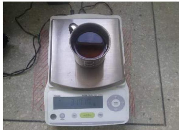
Ilustración 258. Pesaje del agua + aditivo.
