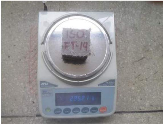
Ilustración 215. Pesaje del espécimen en la balanza eléctrica modelo FX-5000i.
