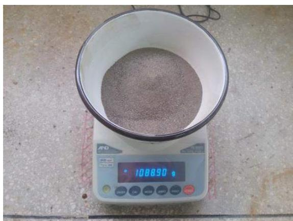
Ilustración 200. Pesaje del árido fino en la balanza eléctrica modelo FX-5000i.
