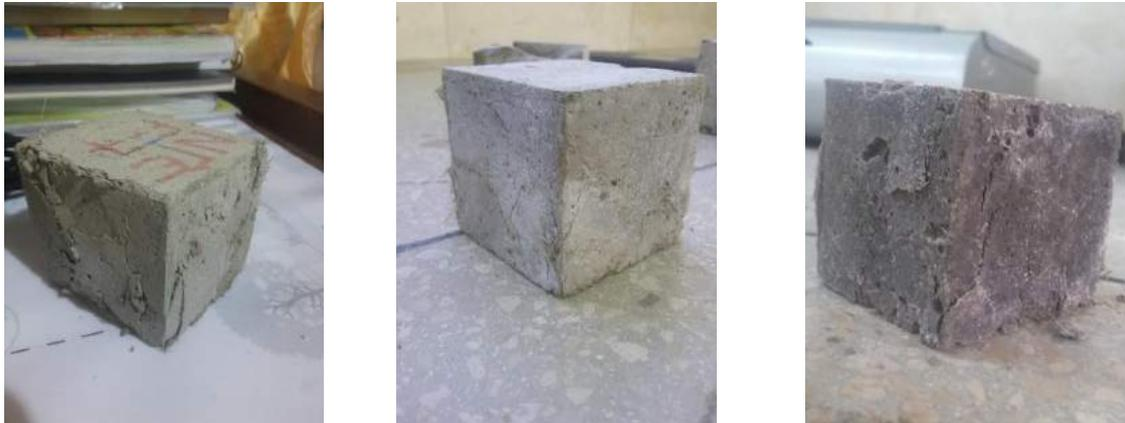
Ilustración 107. Fisuración de los espécimen M-NTE-F7, M-NTE-F14 y M-NTE-F28.
