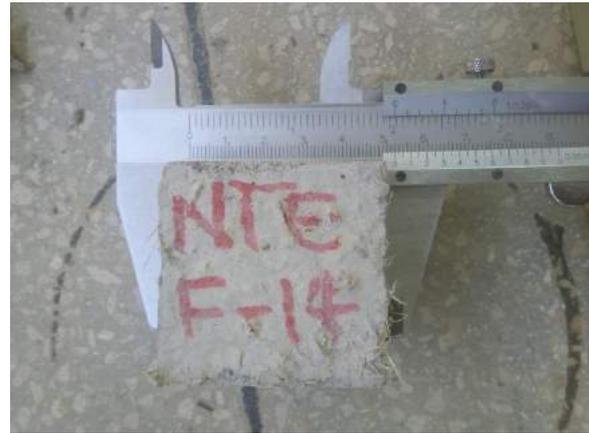
Ilustración 96. Medición de las aristas del espécimen a evaluar.
