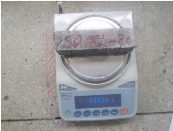
Ilustración 382. Especimen M-ISO-FT28 seco listo para ser ensayado.
