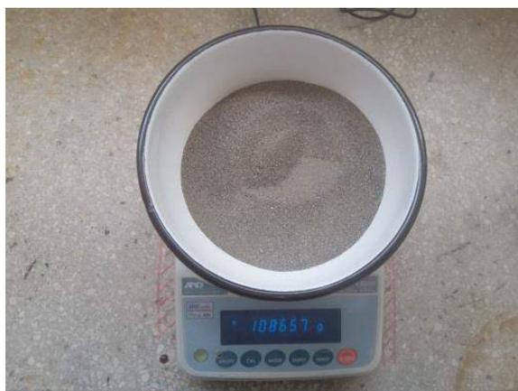
Ilustración 170. Pesaje del árido fino en la balanza eléctrica modelo FX-5000i.
