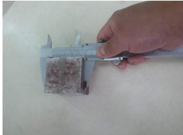
Ilustración 156. Medición de las aristas del espécimen a evaluar.
