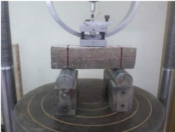
Ilustración 238. Colocación del espécimen en la máquina de ensayo.
