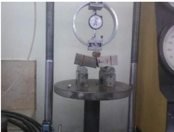
Ilustración 240-241. Fisuración y ruptura total del espécimen M-NTE 7 dentro de la máquina triaxial.
