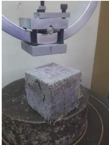
Ilustración 122-123. Formación de fisuras mientras se le aplicó la carga máxima dentro de la máquina de ensayo.
