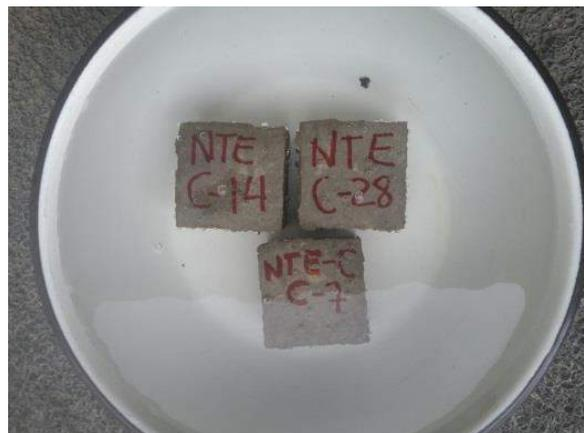
Ilustración 58. Especímenes sumergidos completamente en agua hasta el día de ser ensayados.
