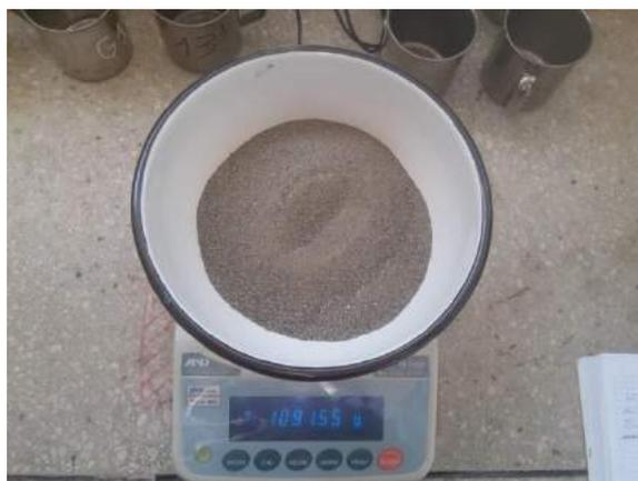
Ilustración 140. Pesaje del árido fino en la balanza eléctrica modelo FX-5000i.
