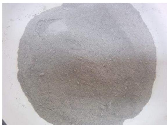
Ilustración 52. Mezcla manual entre cemento y árido fino.
