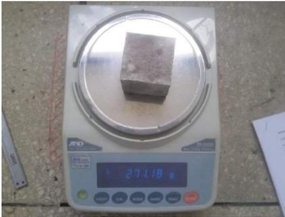
Ilustración 161. Pesaje del espécimen en la balanza eléctrica modelo FX-5000i.
