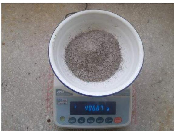
Ilustración 109. Pesaje del cemento en la balanza eléctrica modelo FX-5000i.
