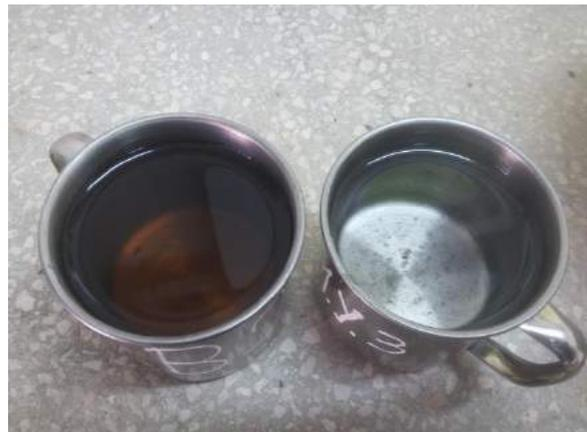
Ilustración 231. Agua + aditivo listo para su mezclado.
