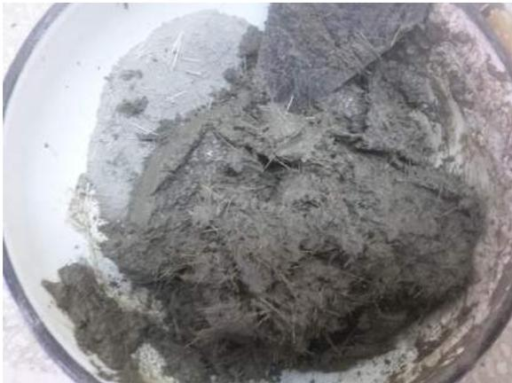
Ilustración 288. Agregado del agua + aditivo en la mezcla.
