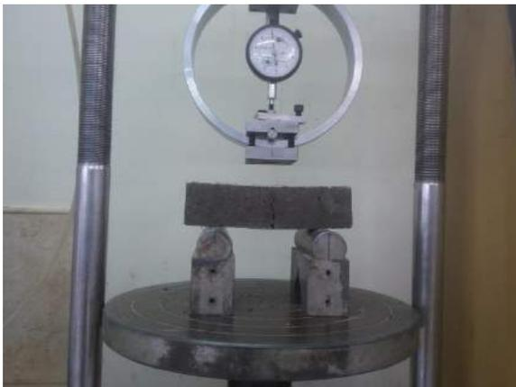
Ilustración 294-295. Sometimiento y fisuración del espécimen M-NTE-FT7 dentro de la máquina triaxial.
