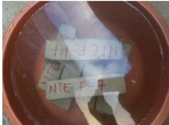
Ilustración 291. Especímenes sumergidos completamente en agua hasta el día de ser ensayados.
