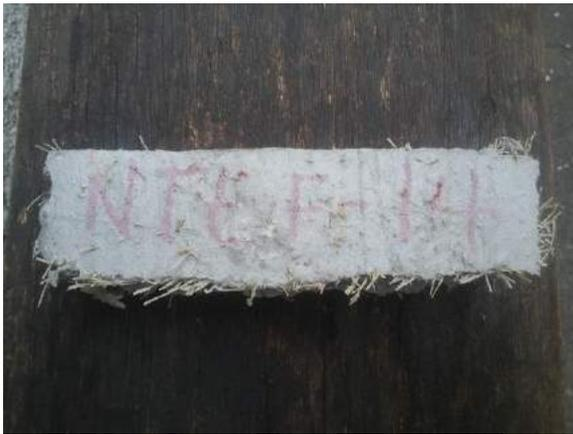
Ilustración 270. Espécimen seco listo para ser ensayado.
