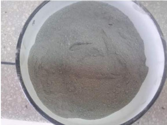
Ilustración 286. Mezcla manual entre cemento y árido fino.
