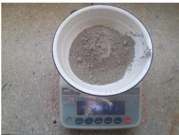
Ilustración 169. Pesaje del cemento en la balanza eléctrica modelo FX-5000i.
