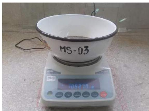
Ilustración 50. Pesaje del árido fino en la balanza eléctrica modelo FX-5000i.
