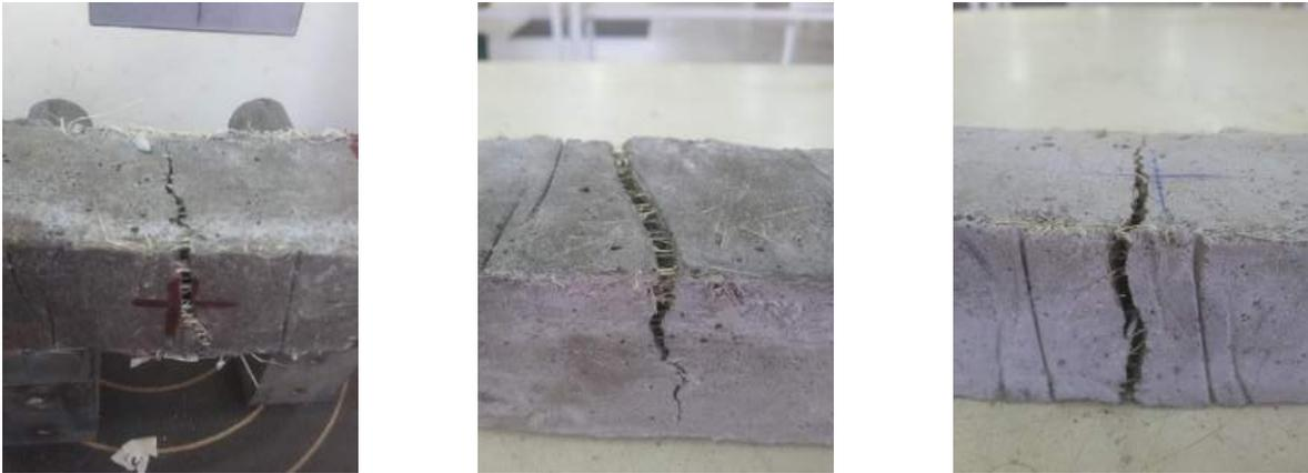
Ilustración 280. Fisuración especímenes M-NTE-F7, M-NTE-F14 y M-NTE-F28 respectivamente.
