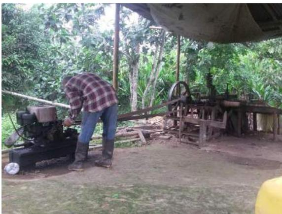
Ilustración 14. Máquina desfibadora.
