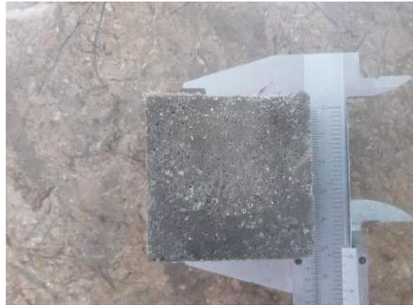
Ilustración 120. Medición de las aristas del espécimen a evaluar.
