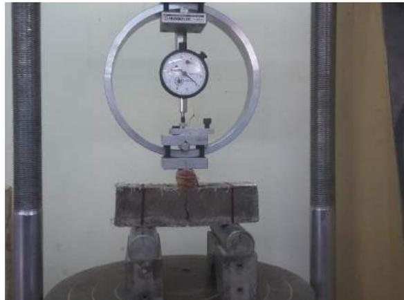
Ilustración 266. Sometimiento del espécimen a carga dentro de la máquina de ensayo.
