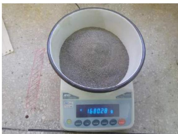
Ilustración 335. Pesaje del árido fino en la balanza eléctrica modelo FX-5000i.
