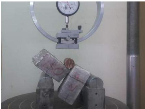
Ilustración 328. Fisuración del espécimen dentro de la máquina triaxial.
