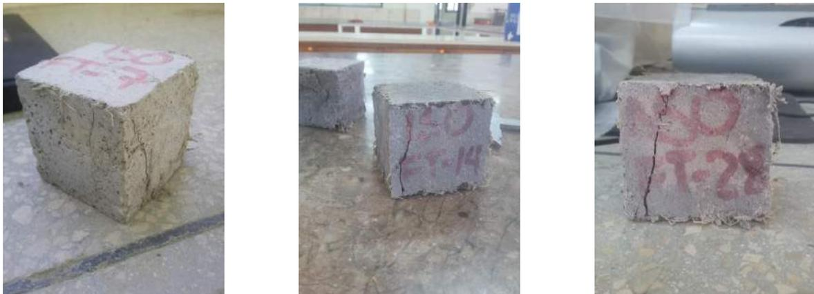
Ilustración 227. Fisuración especímenes M-ISO-FT7, M-ISO-FT14 y M-ISO-FT28 respectivamente. Fuente: Autor, 2016.
