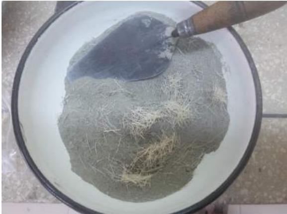
Ilustración 83. Agregado de fibra a la mezcla consistente entre cemento y árido fino.
