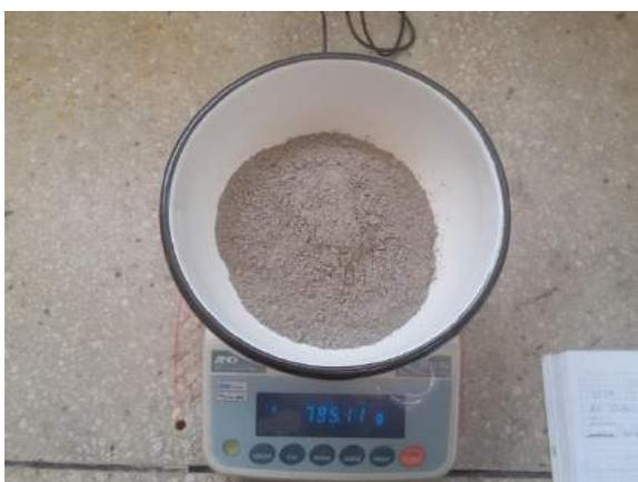
Ilustración 308. Pesaje del cemento en la balanza eléctrica modelo FX-5000i.
