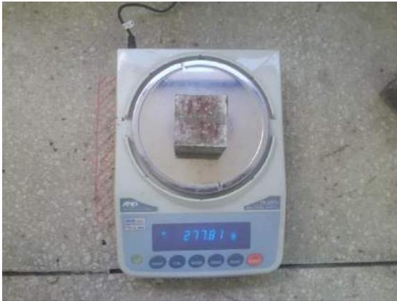
Ilustración 155. Pesaje del espécimen en la balanza eléctrica modelo FX-5000i.
