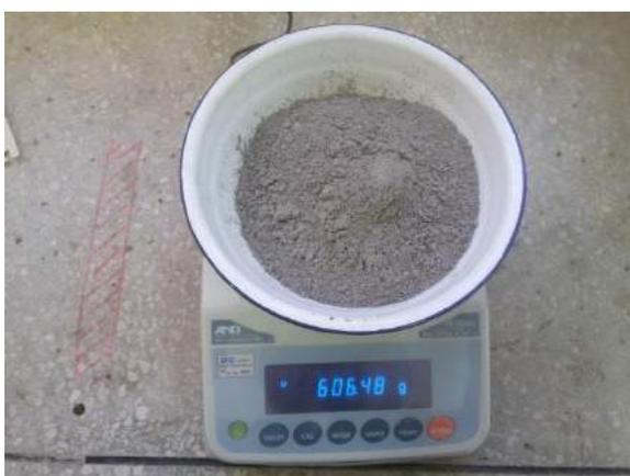
Ilustración 362. Pesaje del cemento en la balanza eléctrica modelo FX-5000i.
