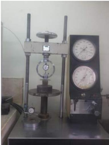
Ilustración 67-68. Calibración de la máquina de ensayo y colocación del espécimen en la misma.
