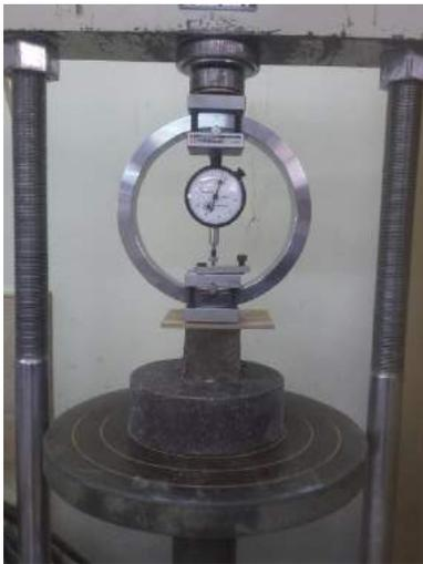
Ilustración 91-92. Calibración de la máquina de ensayo y colocación del espécimen en la misma.
