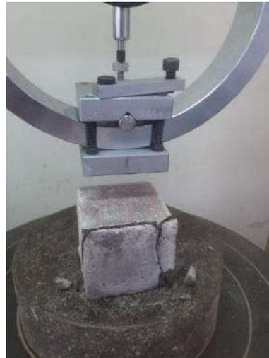
Ilustración 164-165. Formación de fisuras mientras se le aplicó la carga máxima dentro de la máquina de ensayo.
