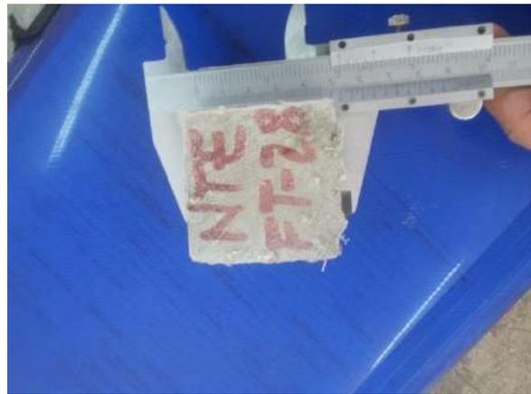
Ilustración 132. Medición de las aristas del espécimen a evaluar.
