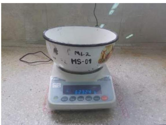
Ilustración 79. Pesaje del cemento en la balanza eléctrica modelo FX-5000i.
