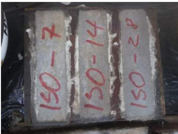
Ilustración 314. Marcaje de los especímenes para identificarlos al momento de ensayarlos.
