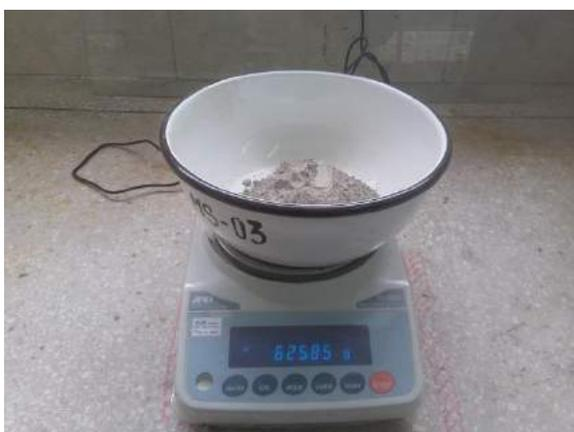
Ilustración 49. Pesaje del cemento en la balanza eléctrica modelo FX-5000i.
