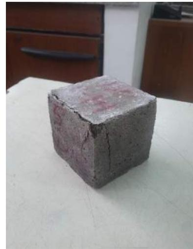
Para este proceso se utilizó una placa de acero como soporte entre el anillo y el espécimen, por lo que su peso fue tomado en cuenta para calcular la carga total aplicada. Todos los datos receptados sobre el mortero M-ISO 14 ensayado a los 14 días se presentan en la tabla 38 y sus valores están representados en la ilustración 160.
