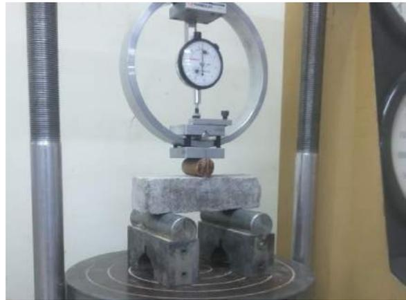
Ilustración 249. Sometimiento del espécimen a carga dentro de la máquina de ensayo.
