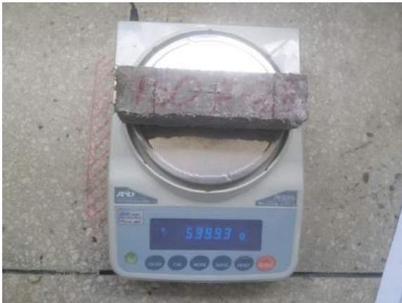
Ilustración 355. Especimen M-ISO-F28 seco listo para ser ensayado.
