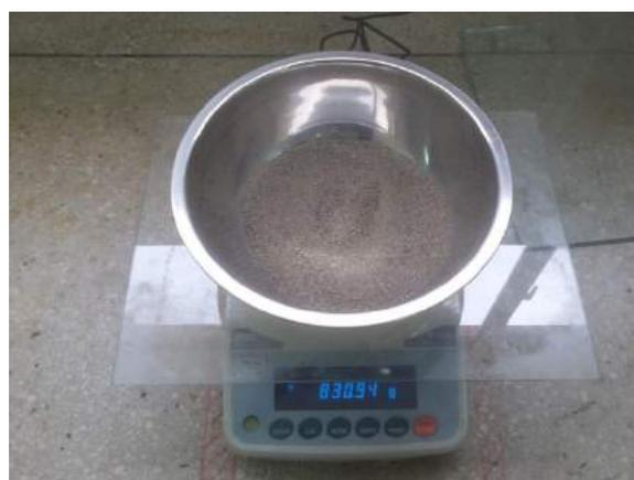
Ilustración 110. Pesaje del árido fino en la balanza eléctrica modelo FX-5000i.
