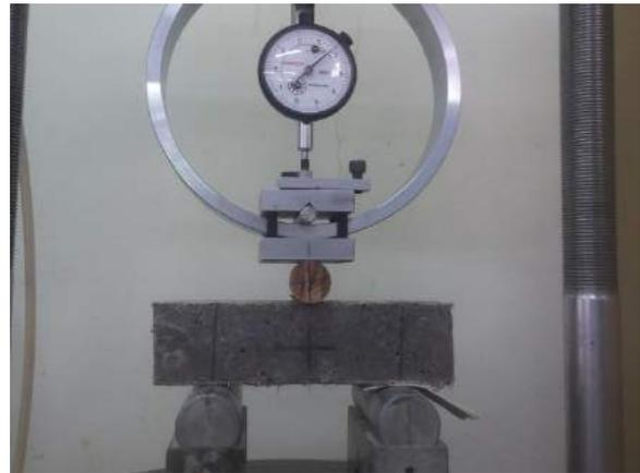
Ilustración 383. Sometimiento del espécimen a carga dentro de la máquina de ensayo.
