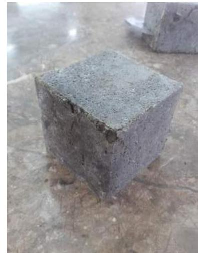
Ilustración 195. Formación de fisuras en el espécimen.
