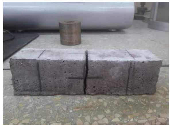
Ilustración 324. Ruptura total del espécimen M-ISO 14.
