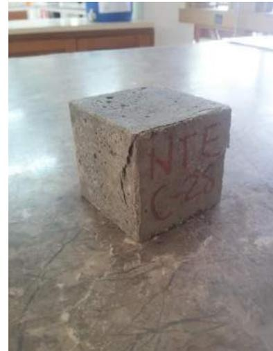
Ilustración 75. Aplicación de carga sobre el M-NTE 28.
