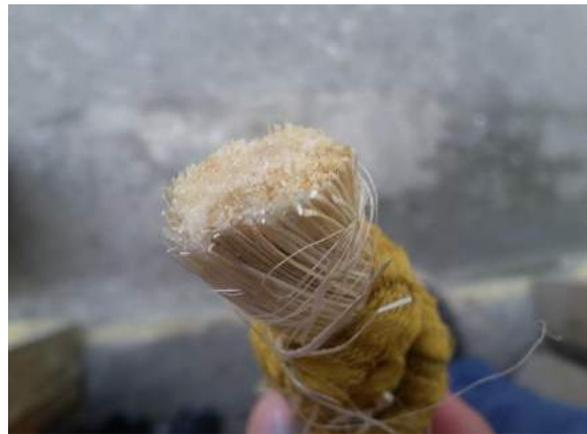
Ilustración 32. Agrupación en hiladas de fibra para su seccionamiento con ayuda de tijera.
