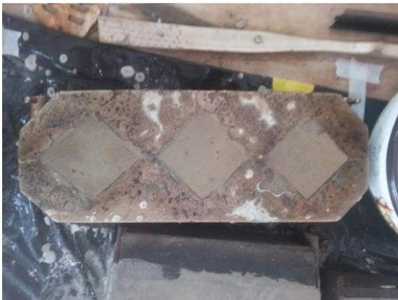
Ilustración 145. Colocación de la mezcla sobre el encofrado.
