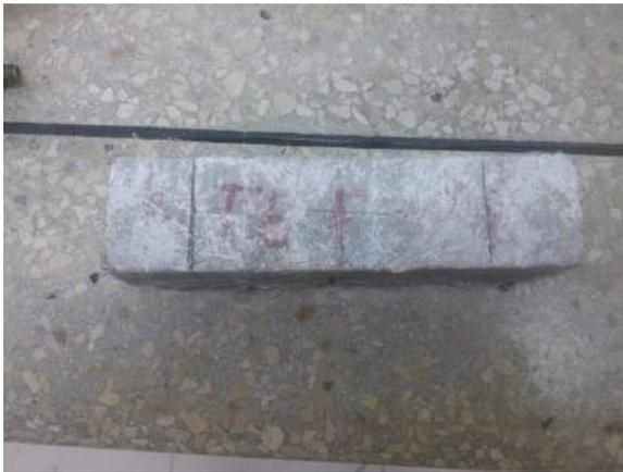
Ilustración 275. Espécimen seco listo para ser ensayado.
