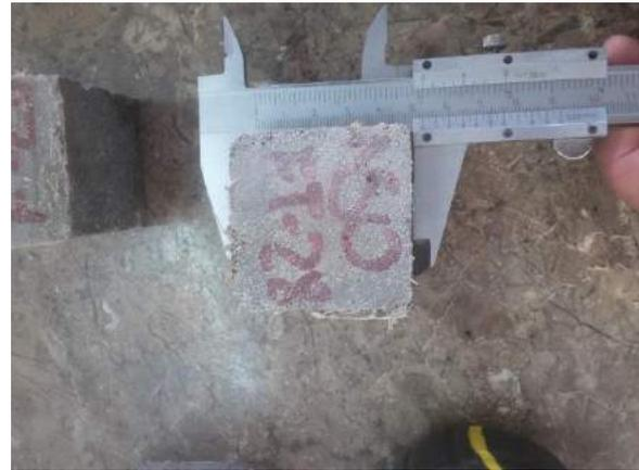
Ilustración 222. Medición de las aristas del espécimen a evaluar.
