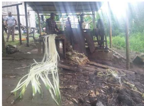
Ilustración 15. Desfibramiento de la fibra.
