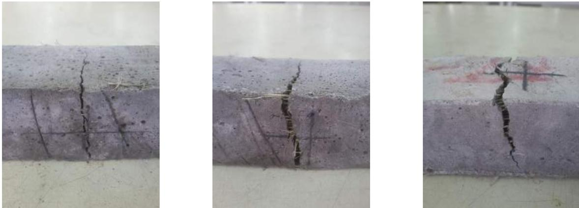
Ilustración 387. Fisuración especímenes M-ISO-FT7, M-ISO-FT14 y M-ISO-FT 28.
