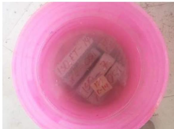
Ilustración 371. Especímenes sumergidos completamente en agua hasta el día de ser ensayados.
