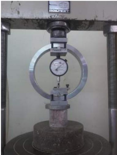
Ilustración 163. Aplicación de carga sobre el M-ISO 28.
