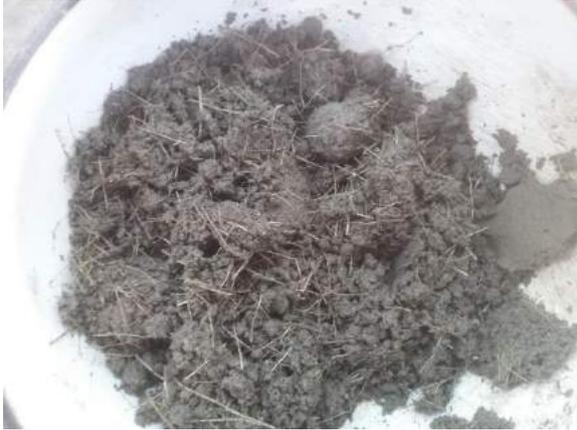
Ilustración 113. Agregado del agua + aditivo en la mezcla.
