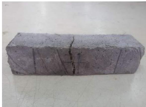
Ilustración 379-380. Fisuración del espécimen M-ISO-FT14 dentro de la máquina triaxial.
