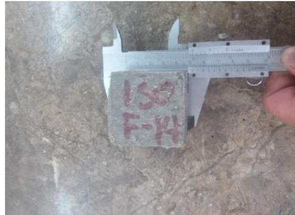
Ilustración 186. Medición de las aristas del espécimen a evaluar.
