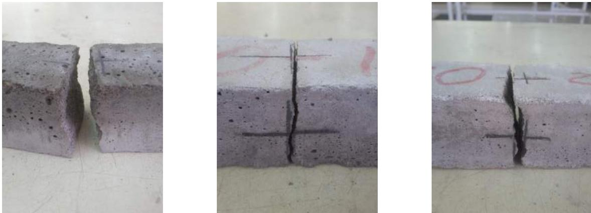
Ilustración 332. Ruptura de especímenes M-ISO 7, M-ISO 14 y M-ISO 28 respectivamente.
