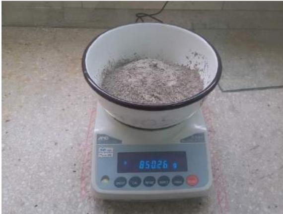
Ilustración 255. Pesaje del cemento en la balanza eléctrica modelo FX-5000i.
