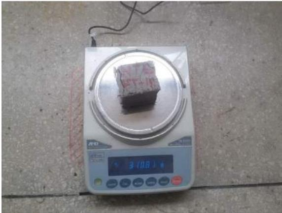
Ilustración 125. Pesaje del espécimen en la balanza eléctrica modelo FX-5000i.
