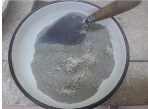
Ilustración 260. Incorporación de fibra en la mezcla.
