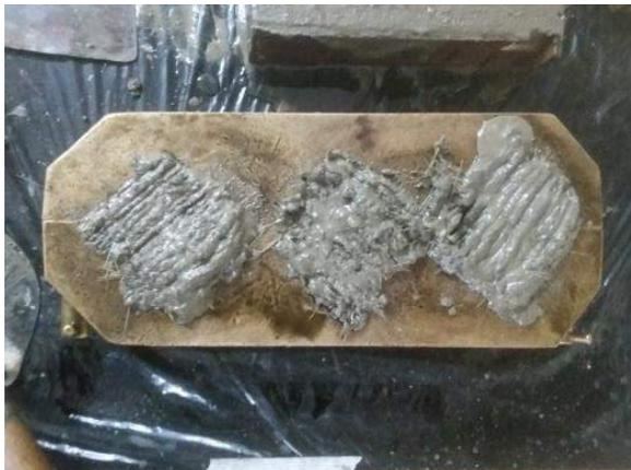
Ilustración 85. Colocación del mortero M-NTE-F para el moldeado final de los especímenes.
