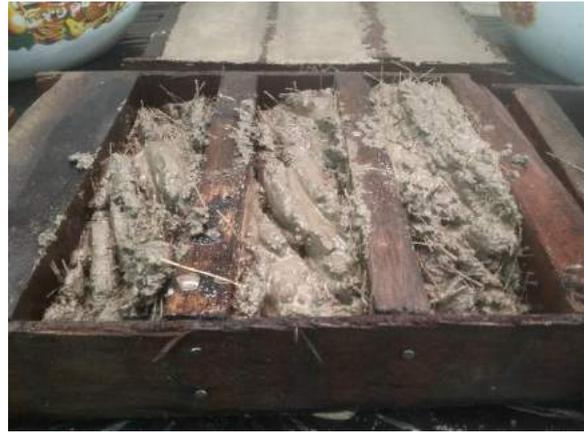
Ilustración 367. Colocación de la mezcla en sus respectivos moldes.
