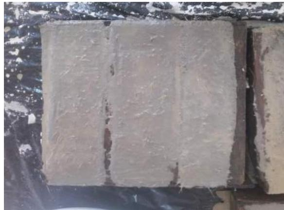
Ilustración 369. Moldeo final de los especímenes.
