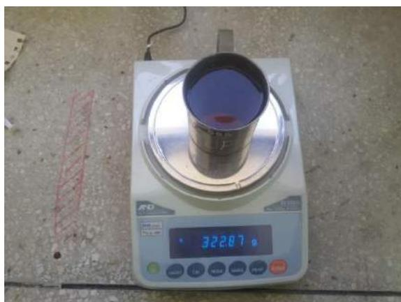
Ilustración 337. Pesaje del agua + aditivo en la balanza eléctrica modelo FX-5000i.
