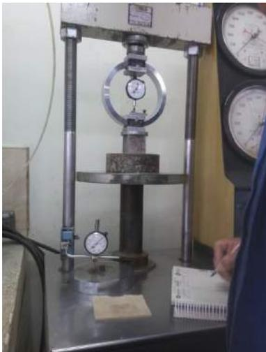
Ilustración 187-188. Aplicación de carga sobre el M-ISO-F14.
