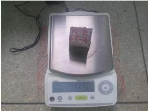
Ilustración 119. Pesaje del espécimen en la balanza eléctrica.
