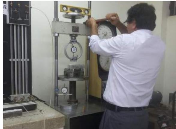
Ilustración 302. Calibración de la máquina triaxial.
