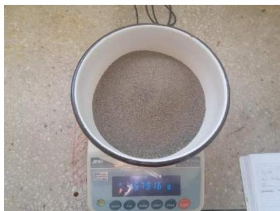
Ilustración 309. Pesaje del árido fino en la balanza eléctrica modelo FX-5000i.
