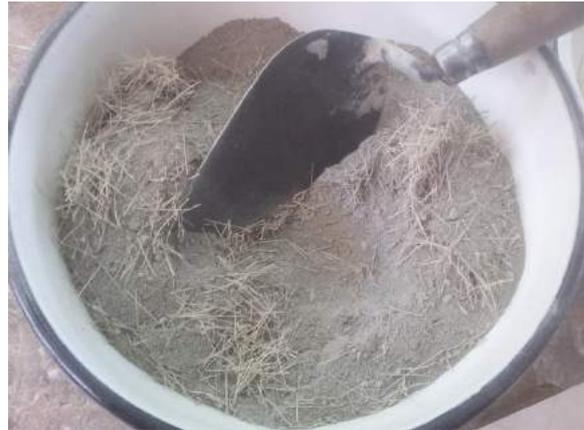
Ilustración 339. Mezcla manual entre árido fino y cemento e incorporación de la fibra a la mezcla.
