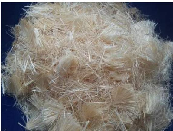
Ilustración 37. Fibra de abacá lista para ser sumergida en parafina disuelta.
