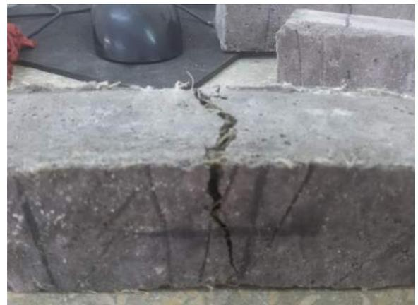
Ilustración 357-358. Fisuración del espécimen M-ISO-F28 dentro de la máquina triaxial.
