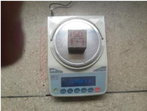
Ilustración 179. Pesaje del espécimen en la balanza eléctrica modelo FX-5000i.
