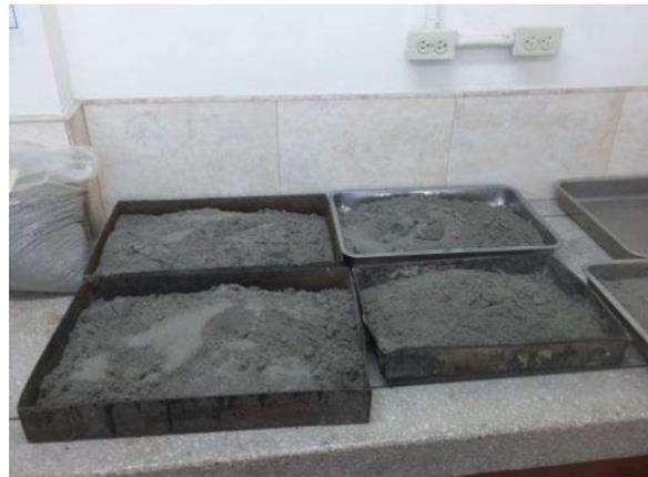
Ilustración 23. Bandejas conteniendo arena seca salida del horno.
