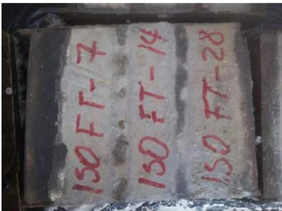
Ilustración 370. Marcaje de los especímenes para identificarlos al momento de ensayarlos.
