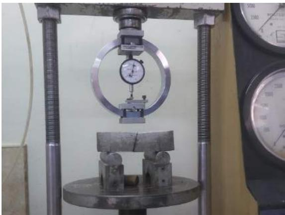
Ilustración 245-246. Fisuración y ruptura total del espécimen M-NTE 14 dentro de la máquina triaxial.
