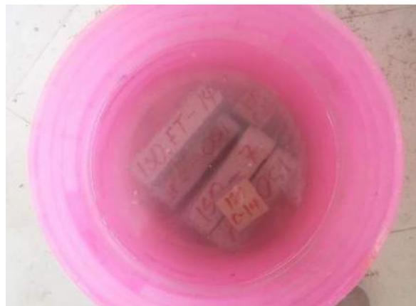
Ilustración 343. Especímenes sumergidos completamente en agua hasta el día de ser ensayados.
