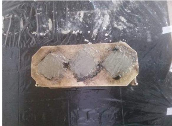
Ilustración 54. Colocación del mortero M-NTE para el moldeo final de los especímenes.
