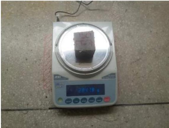
Ilustración 209. Pesaje del espécimen en la balanza eléctrica modelo FX-5000i.
