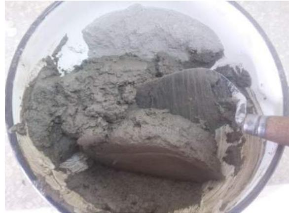
Ilustración 233. Agregado de agua + aditivo en la mezcla.
