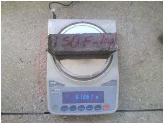
Ilustración 349. Espécimen M-ISO-F14 seco listo para ser ensayado.
