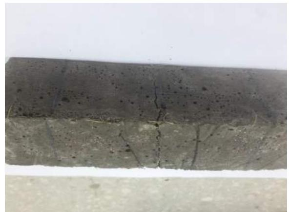
Ilustración 374-375. Fisuración del espécimen M-ISO-FT7 dentro de la máquina triaxial.
