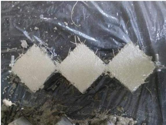
Ilustración 205. Colocación de la mezcla en sus respectivos encofrados.
