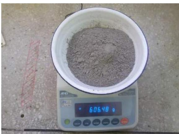
Ilustración 334. Pesaje del cemento en la balanza eléctrica modelo FX-5000i.
