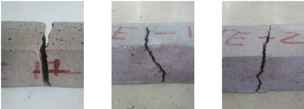
Ilustración 253. Ruptura de especímenes M-NTE 7, M-NTE 14 y M-NTE 28 respectivamente.
