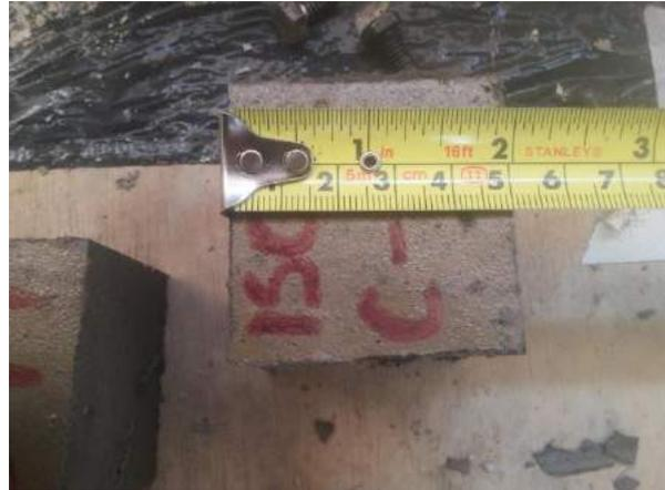
Ilustración 150. Medición de las aristas del espécimen a evaluar.
