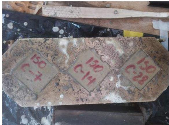
Ilustración 146. Marcaje de los especímenes.
