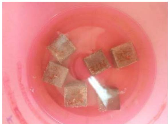
Ilustración 392. Especímenes sumergidos en agua hasta su totalidad durante 24 horas.
