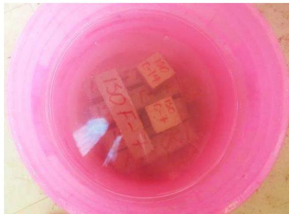
Ilustración 148. Especímenes sumergidos completamente en agua hasta el día de ser ensayados.
