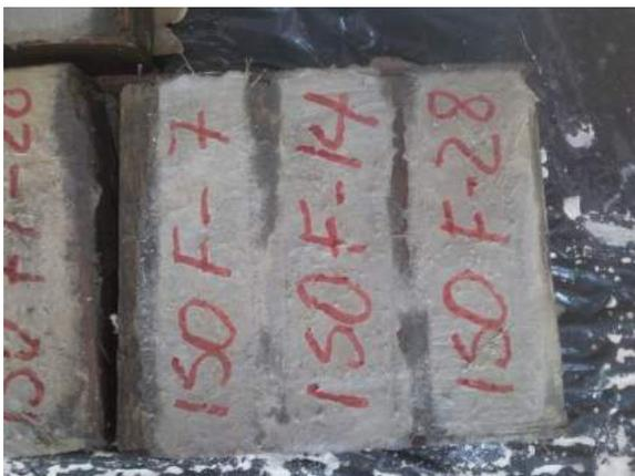
Ilustración 342. Marcaje de los especímenes para identificarlos al momento de ensayarlos.
