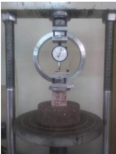
Ilustración 133. Aplicación de carga sobre el M-NTE-FT28.
