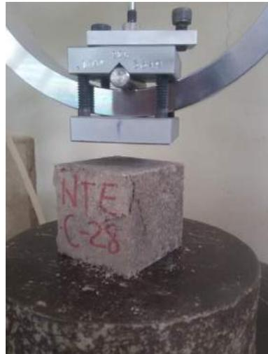
Ilustración 73-74. Calibración de la máquina de ensayo y colocación del espécimen en la misma.
