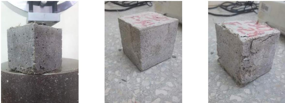
Ilustración 197. Fisuración especímenes M-ISO-F7, M-ISO-F14 y M-ISO-F28 respectivamente.
