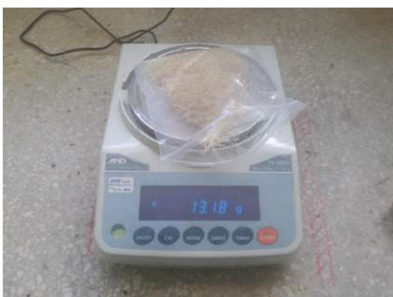
Ilustración 81. Pesaje de la fibra en la balanza eléctrica modelo FX-5000i.
