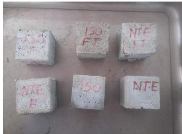
Ilustración 390. Especímenes desencofrados y listos para obtener su peso inicial.
