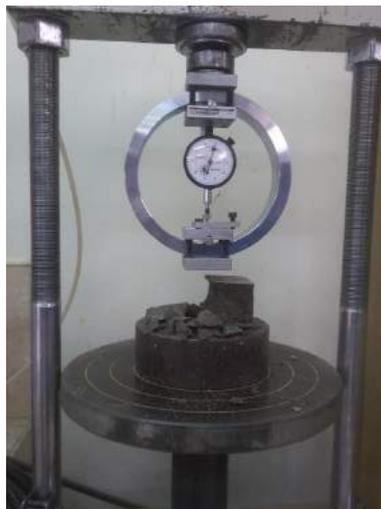
Ilustración 152-153. Formación de fisuras mientras se le aplicó la carga máxima dentro de la máquina de ensayo.
