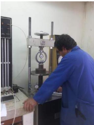
Ilustración 151. Aplicación de carga sobre el M-ISO 7.
