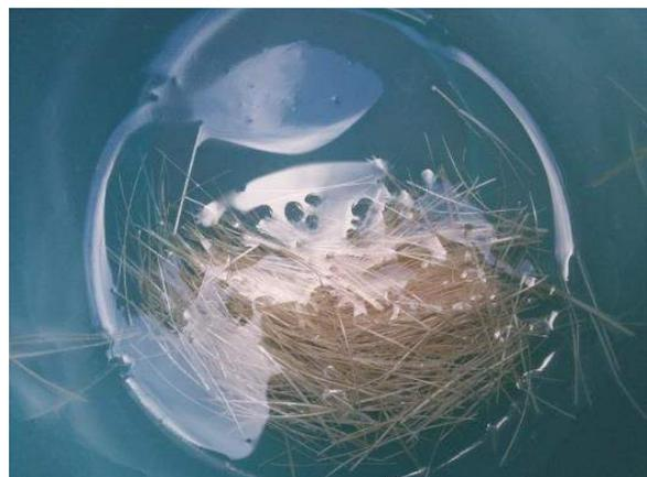
Ilustración 38. Fibra de abacá sumergida en parafina disuelta.
