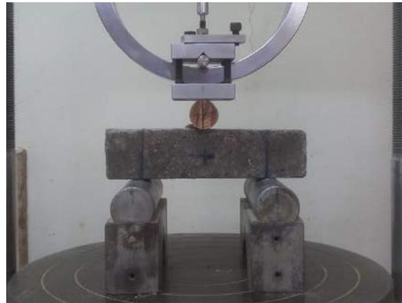
Ilustración 244. Sometimiento del espécimen a carga dentro de la máquina de ensayo.
