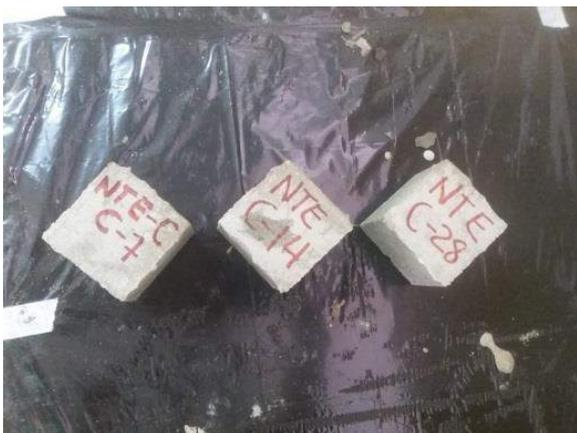
Ilustración 57. Marcaje de los especímenes para identificarlos al momento de ensayarlos.
