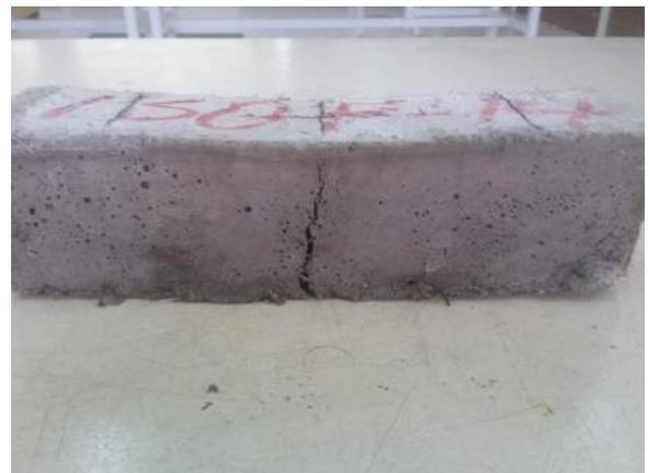
Ilustración 351-352. Fisuración del espécimen M-ISO-F14 dentro de la máquina triaxial.
