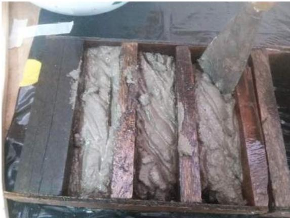
Ilustración 234. Colocación de la mezcla en sus respectivos encofrados.
