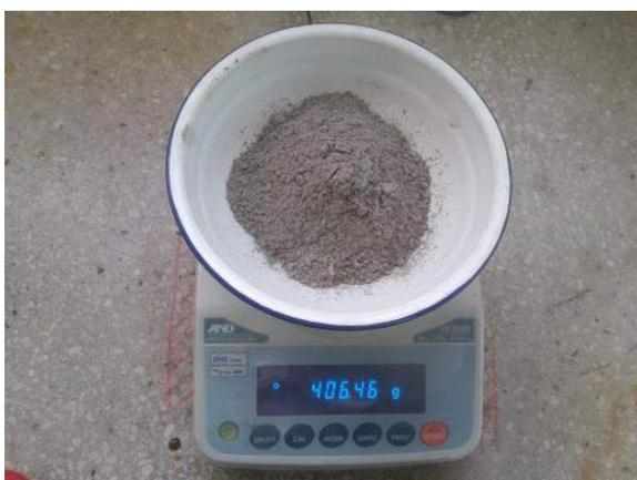
Ilustración 199. Pesaje del cemento en la balanza eléctrica modelo FX-5000i.
