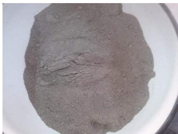
Ilustración 112. Mezcla manual entre cemento y árido fino.
