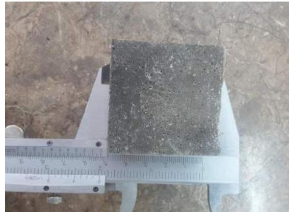
Ilustración 180. Medición de las aristas del espécimen a evaluar.
