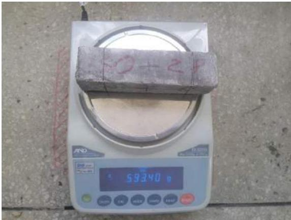
Ilustración 326. Especimen M-ISO 28 seco listo para ser ensayado.
