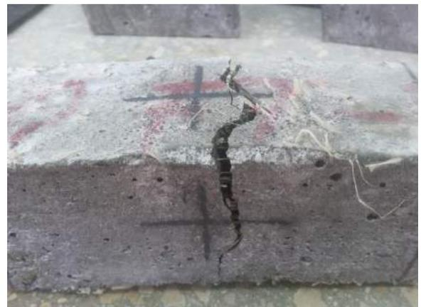
Ilustración 384-385. Fisuración del espécimen M-ISO-FT28 dentro de la máquina triaxial.
